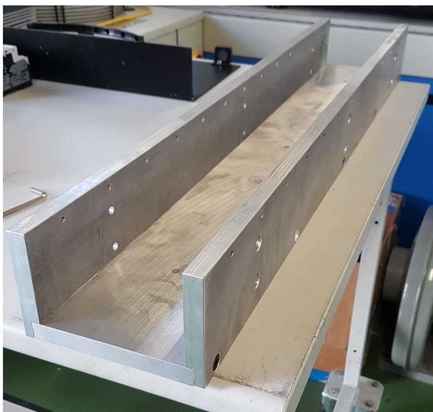
Slika 23. Montaža bočnih ploča vodilice
