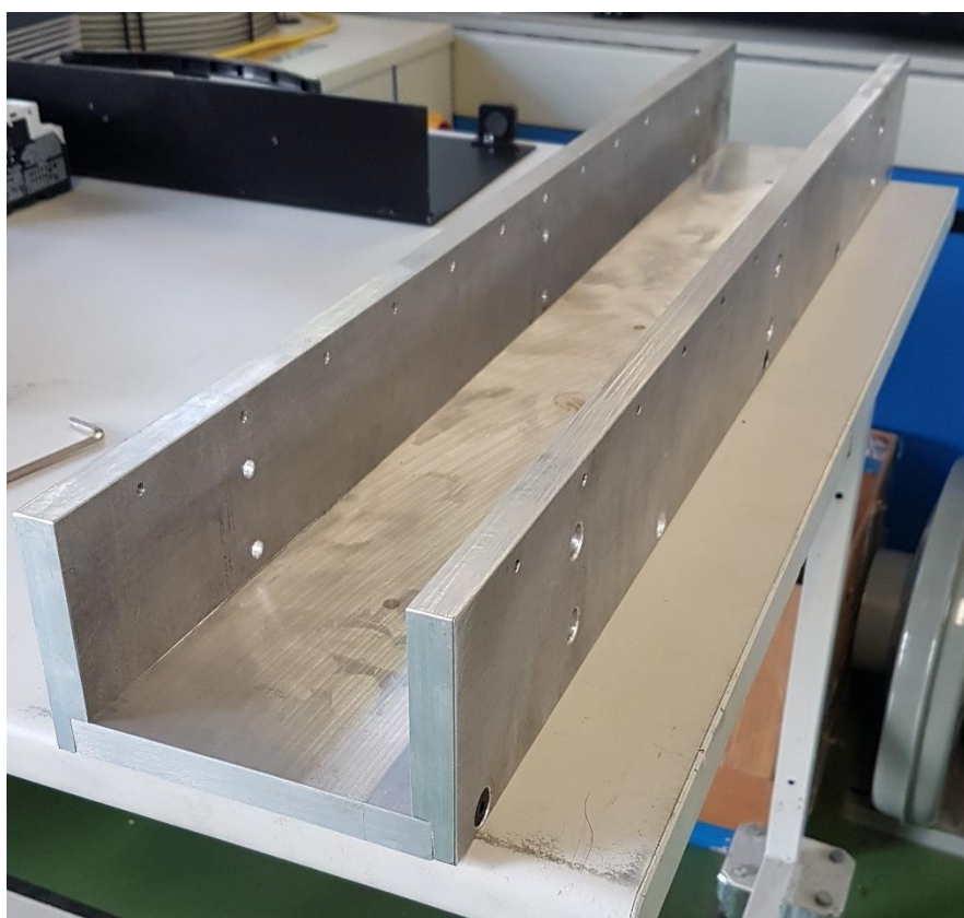
Slika 23. Montaža bočnih ploča vodilice
