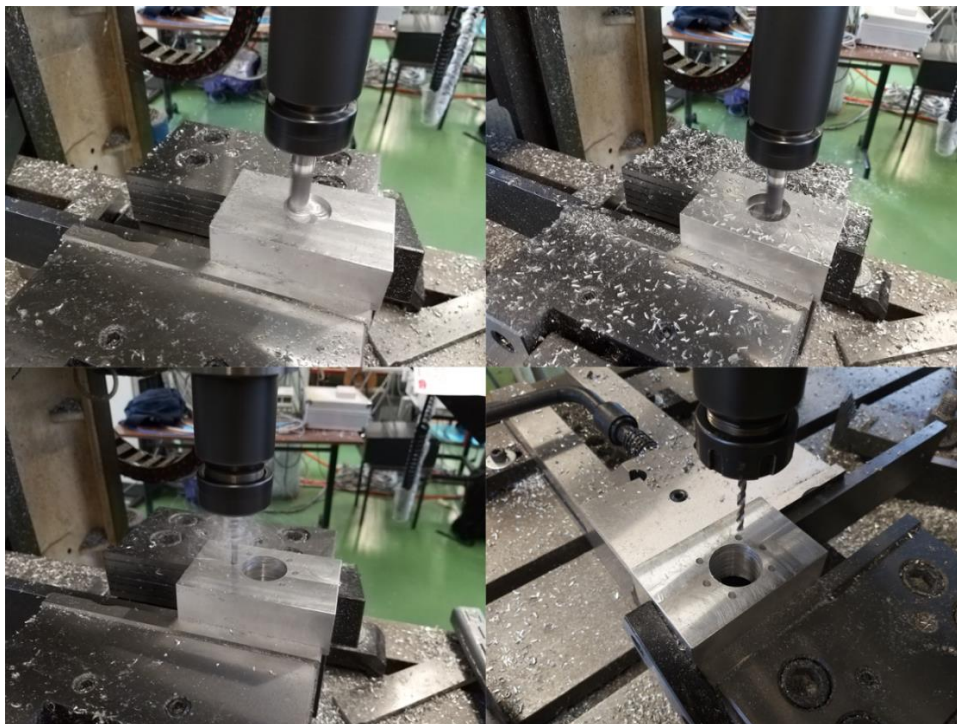
Slika 49. Izrada kućišta matice
