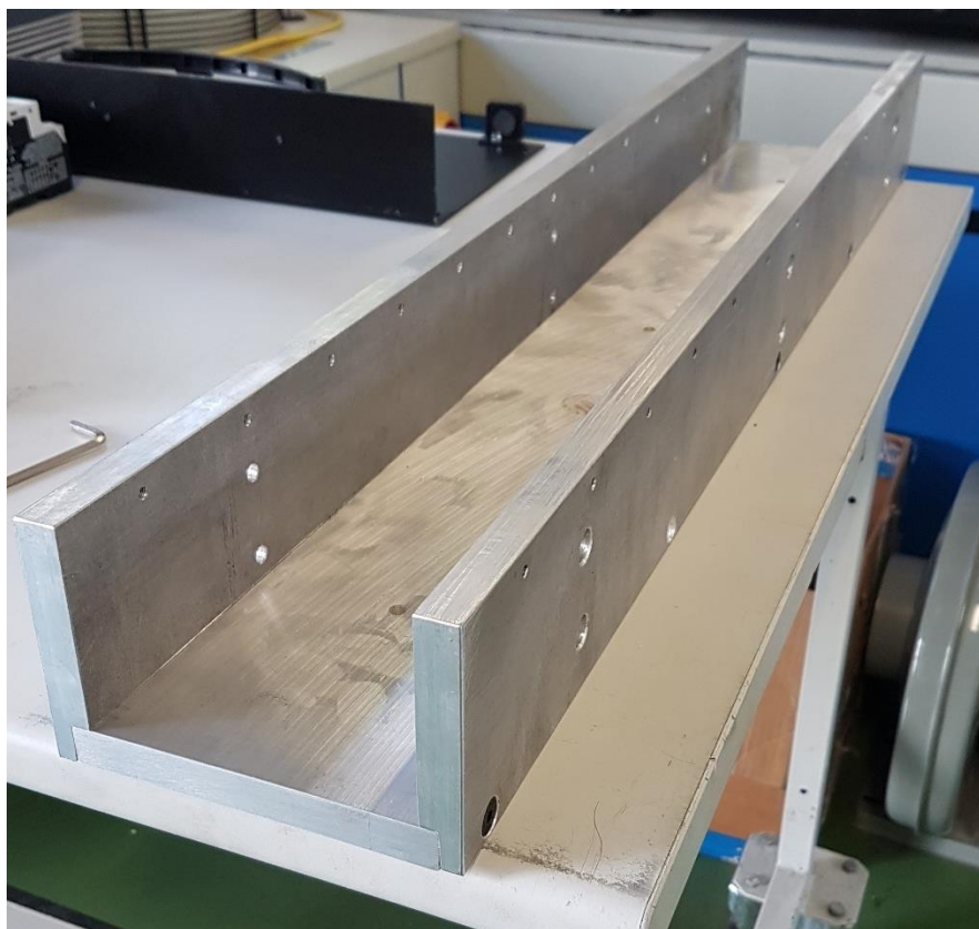
Slika 23. Montaža bočnih ploča vodilice
