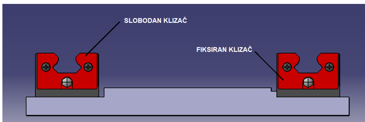
Slika 46. CAD model klizne platforme
