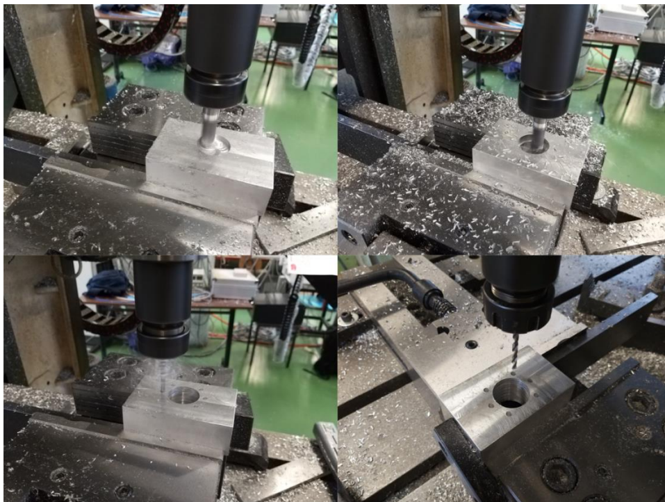
Slika 49. Izrada kućišta matice
