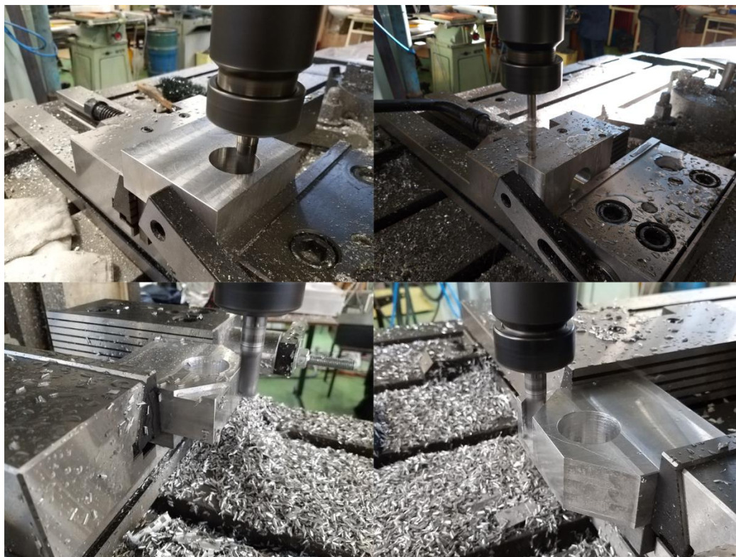
Slika 30. Izrada kućišta stražnjeg ležaja
