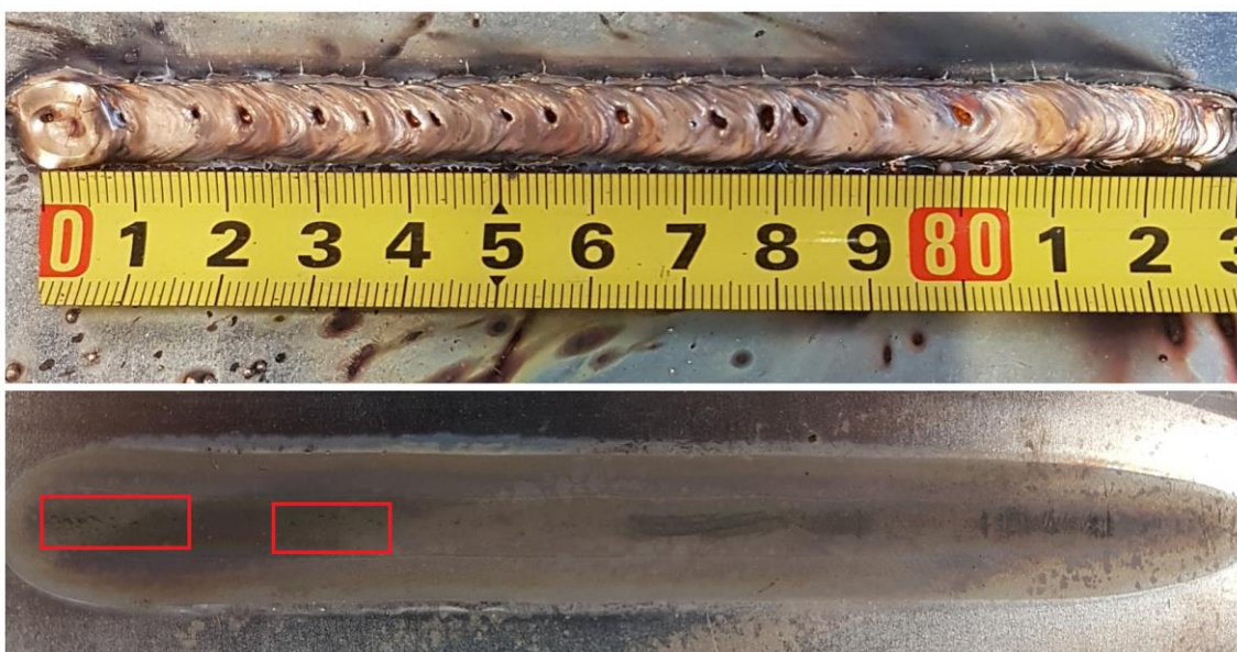
Slika 33. Uzorak 3B: - gornja slika: lice zalemljenog spoja - donja slika: naličje zalemljenog spoja
