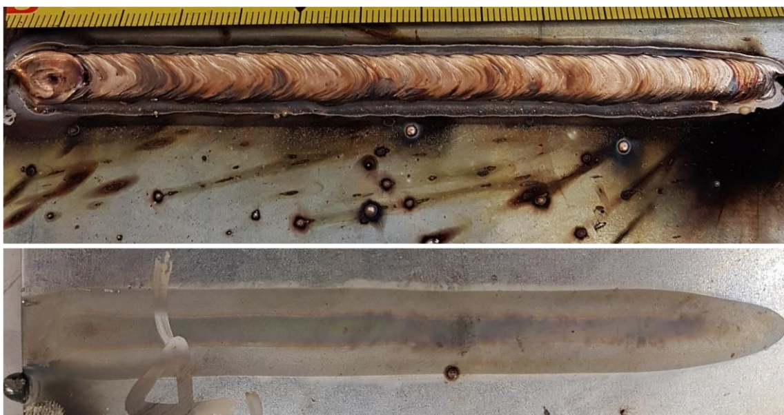
Slika 30. Uzorak 4A: - gornja slika: lice zalemljenog spoja - donja slika: naličje zalemljenog spoja
