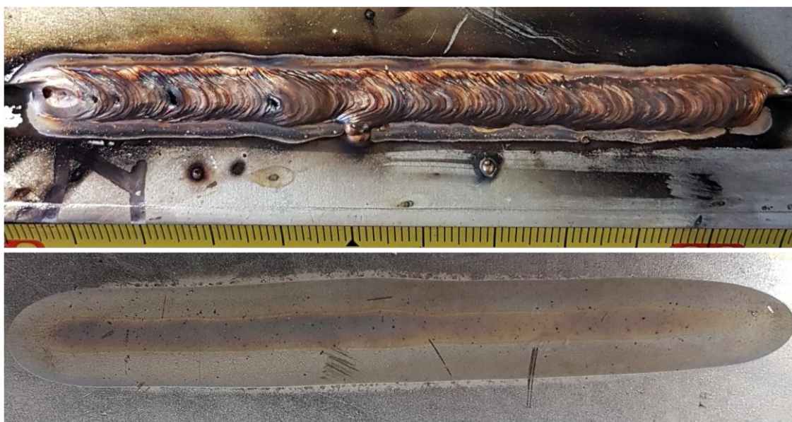
Slika 28. Uzorak 2A: - gornja slika: lice zalemljenog spoja - donja slika: naličje zalemljenog spoja
