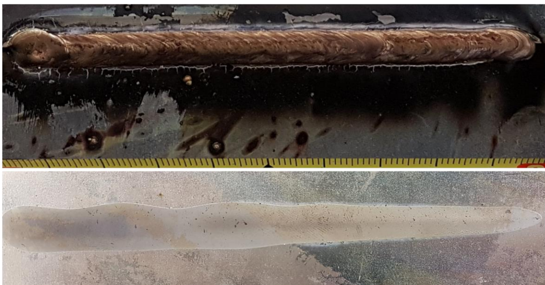
Slika 35. Uzorak 1C: - gornja slika: lice zalemljenog spoja - donja slika: naličje zalemljenog spoja
