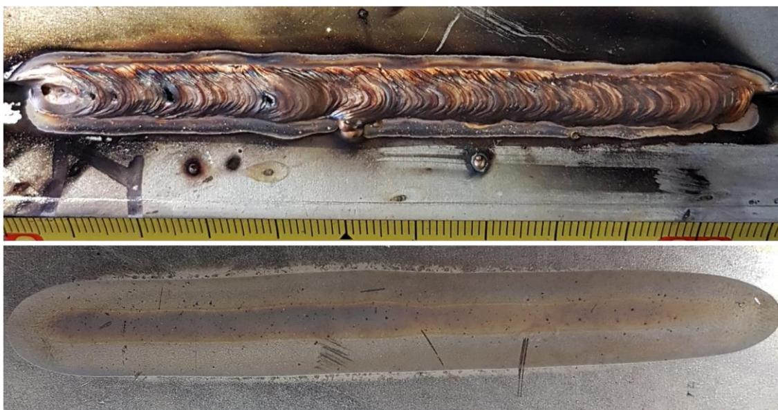
**Slika 28. Uzorak 2A: - gornja slika: lice zalemljenog spoja
