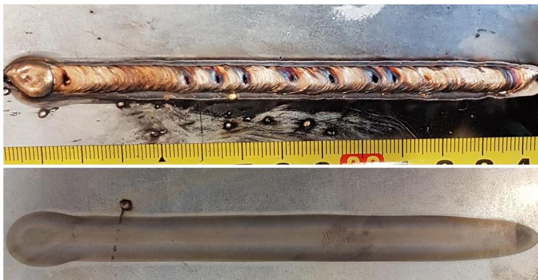
**Slika 29. Uzorak 3A: - gornja slika: lice zalemljenog spoja
