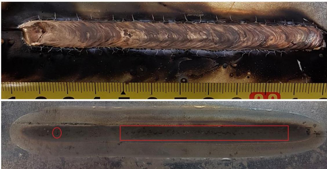
**Slika 32. Uzorak 2B: - gornja slika: lice zalemljenog spoja
