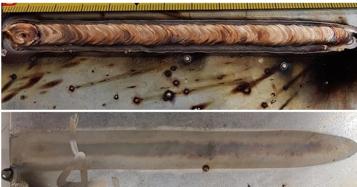
**Slika 30. Uzorak 4A: - gornja slika: lice zalemljenog spoja
