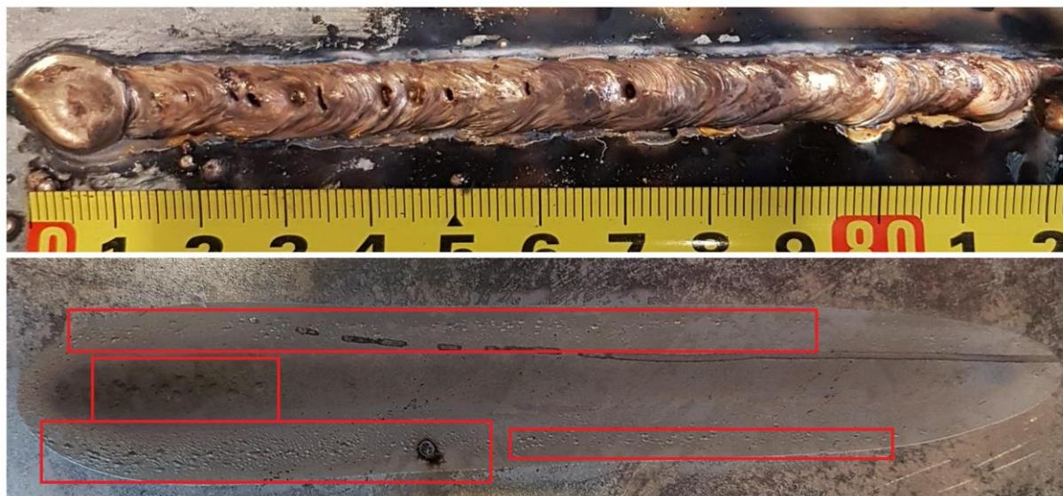
**Slika 37. Uzorak 3C: - gornja slika: lice zalemljenog spoja
