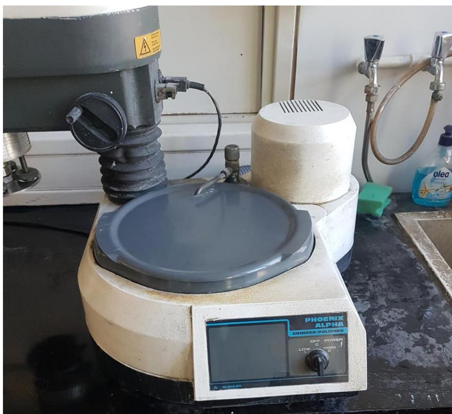
**Slika 39. Stroj za poliranje uzoraka**
