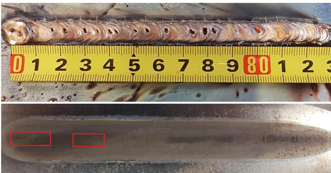
**Slika 33. Uzorak 3B: - gornja slika: lice zalemljenog spoja
