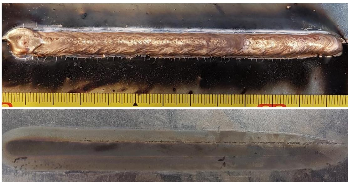
**Slika 31. Uzorak 1B: - gornja slika: lice zalemljenog spoja
