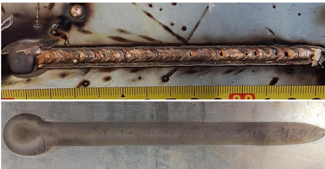
**Slika 27. Uzorak 1A: - gornja slika: lice zalemljenog spoja
