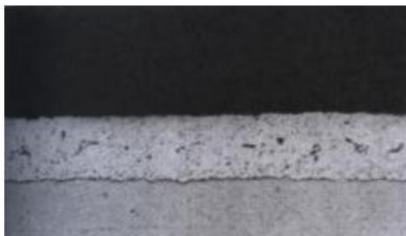
Slika 11. Mikrografski prikaz kontinuiranih trakastih linija [1]
