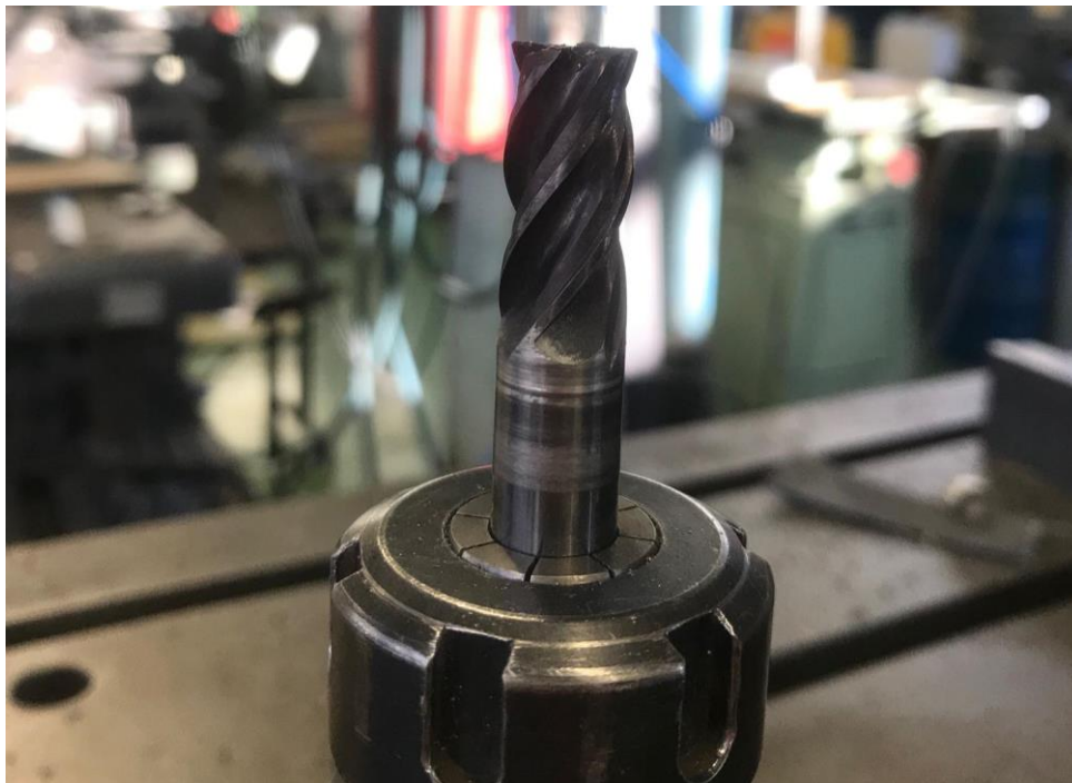
Slika 33. Prstasto glodalo promjera 12mm
