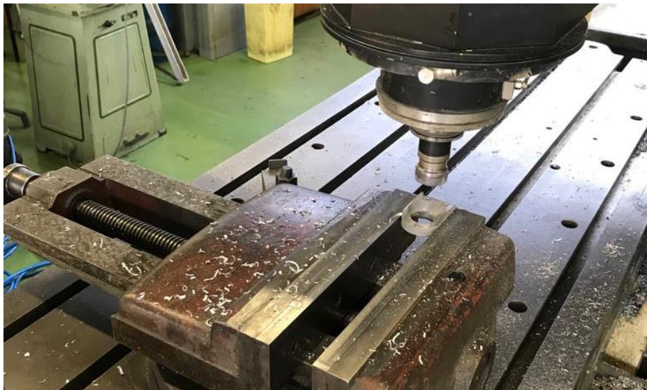
Slika 19. Postupak čeonog glodanja držača ležaja
