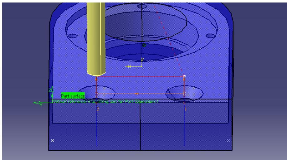
**Slika 41.** Putanja alata pri bušenju provrta promjera 5mm
