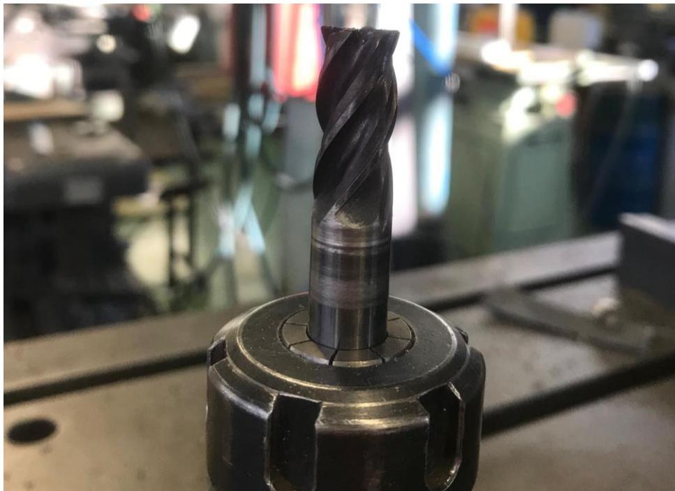
Slika 33. Prstasto glodalo promjera 12mm
