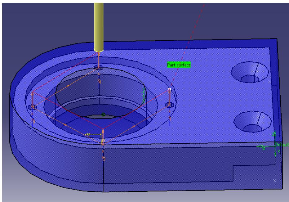
**Slika 39. Putanja alata pri bušenju provrta promjera 2.5mm**
