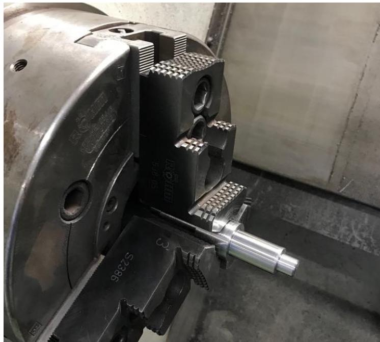
Slika 22. Tokarenje osnovnog oblika osovine 1 na CNC tokarilici
