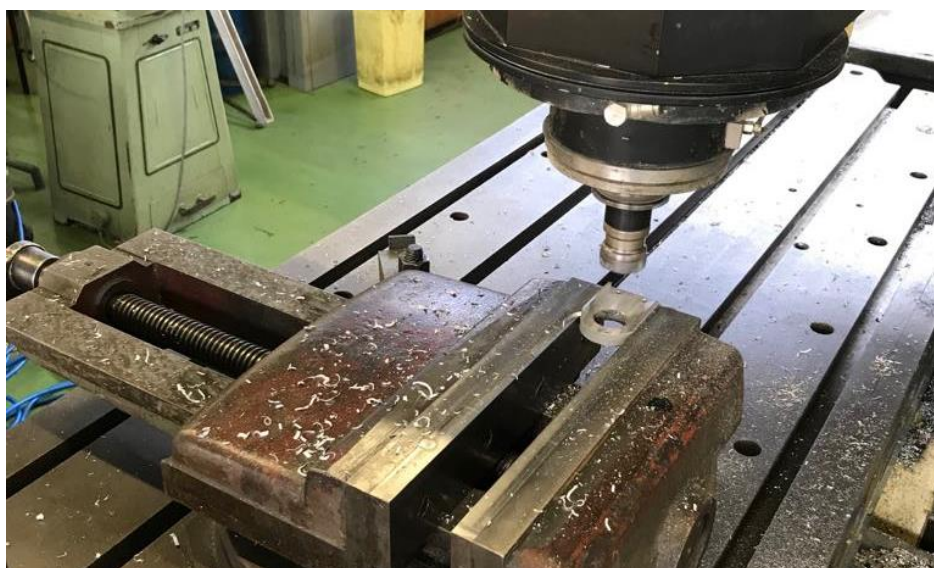
Slika 19. Postupak čeonog glodanja držača ležaja
