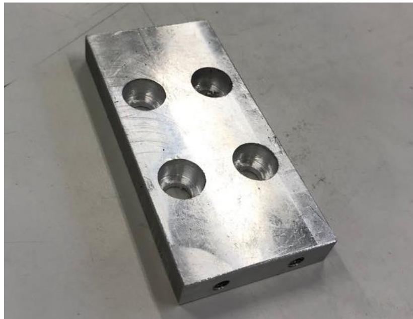
**Slika 17. Donja ploča izrađena u laboratoriju za alatne strojeve, FSB**
