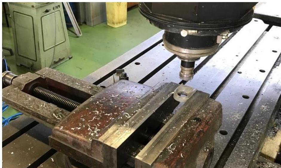
Slika 19. Postupak čeonog glodanja držača ležaja
