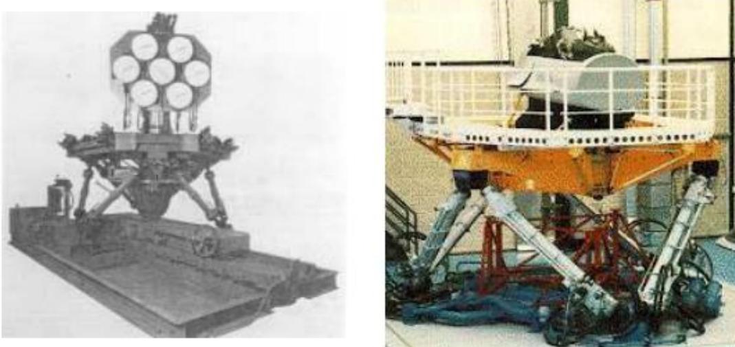
Slika 1. Goughov stroj za testiranje guma (lijevo), Stewartov simulator leta (desno) [1]
