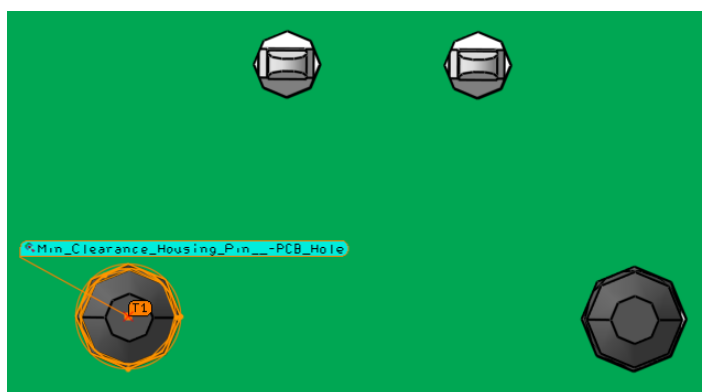
Slika 28. Izmjera zračnosti svornjaka i provrta PCB pločice
