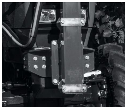
Slika 11. Pričvršćivanje pomoću vijaka
