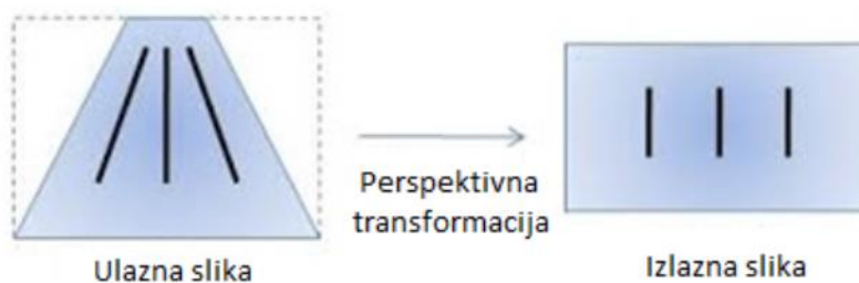
Slika 7 Prikaz perspektivne transformacije
