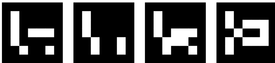
Slika 8 Primjer 5x5 ArUco markera
