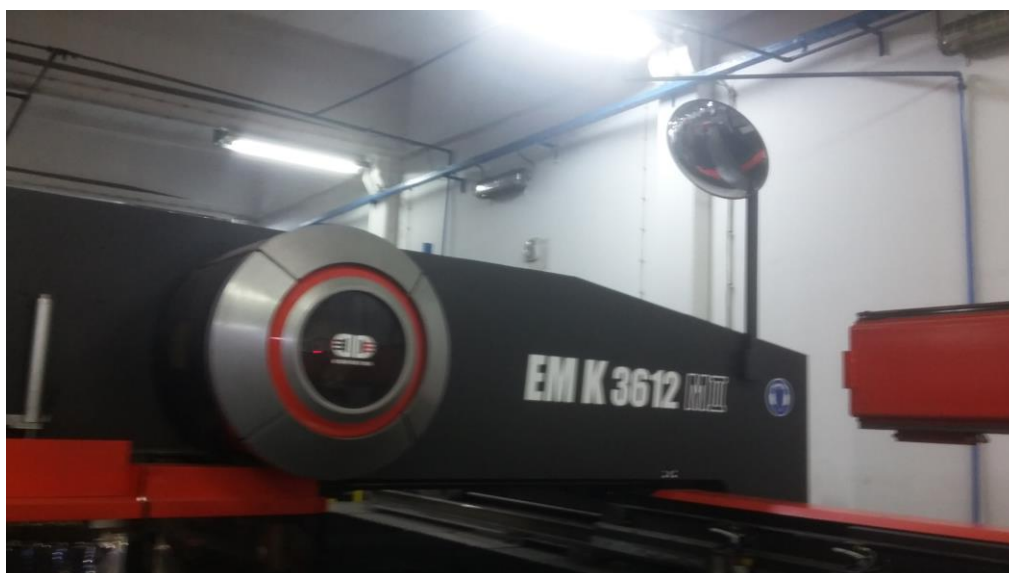
Slika 55. Mosna izvedba stroja
