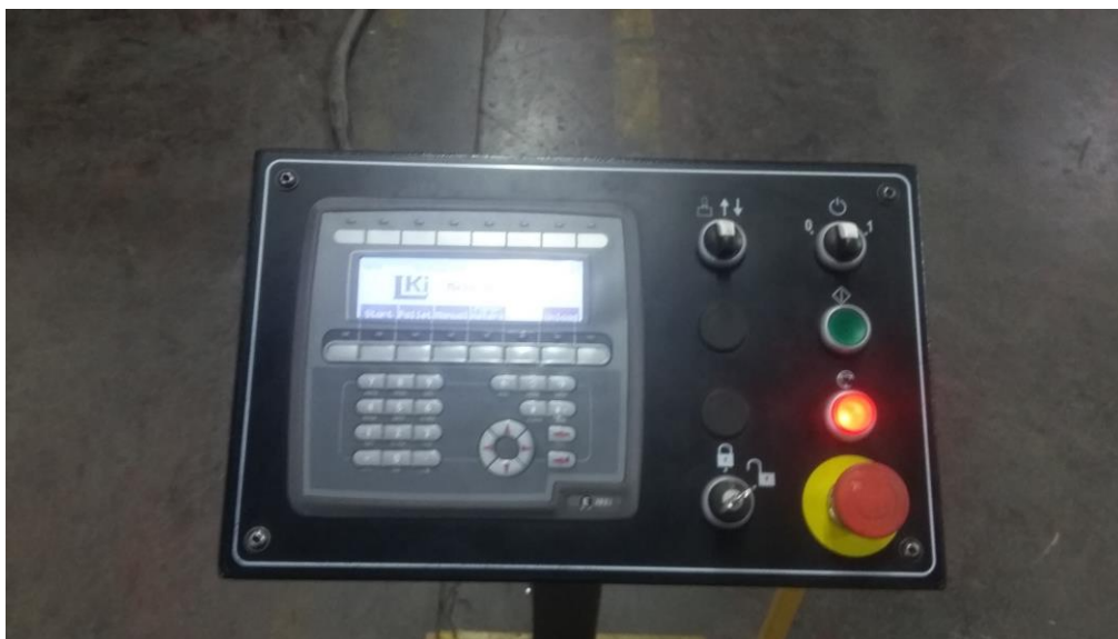
Slika 62. Upravljanje radom stroja za automatsko uzimanje limova s palete
