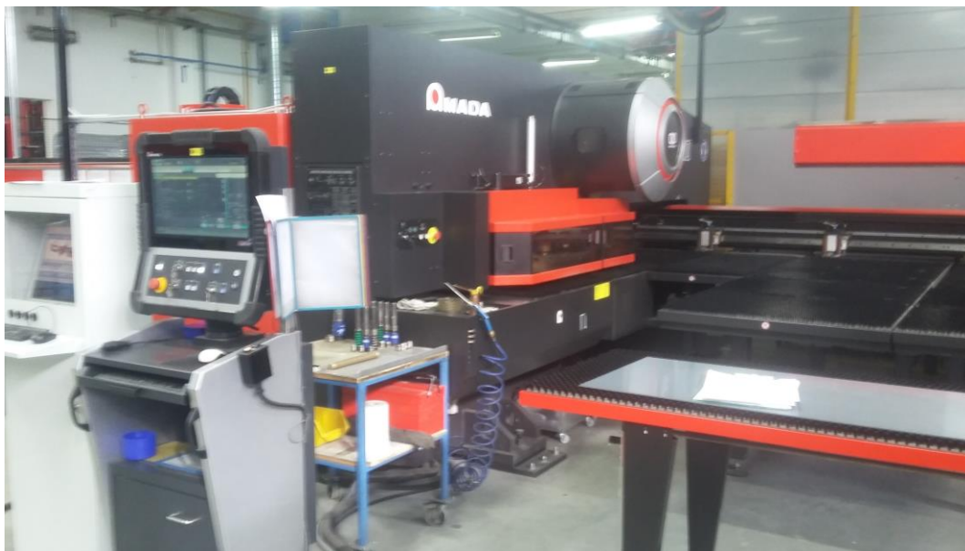
Slika 66. Prikaz zatvorenih vrata kod revolvera i crijevo s pištoljem za upuhivanje zraka
