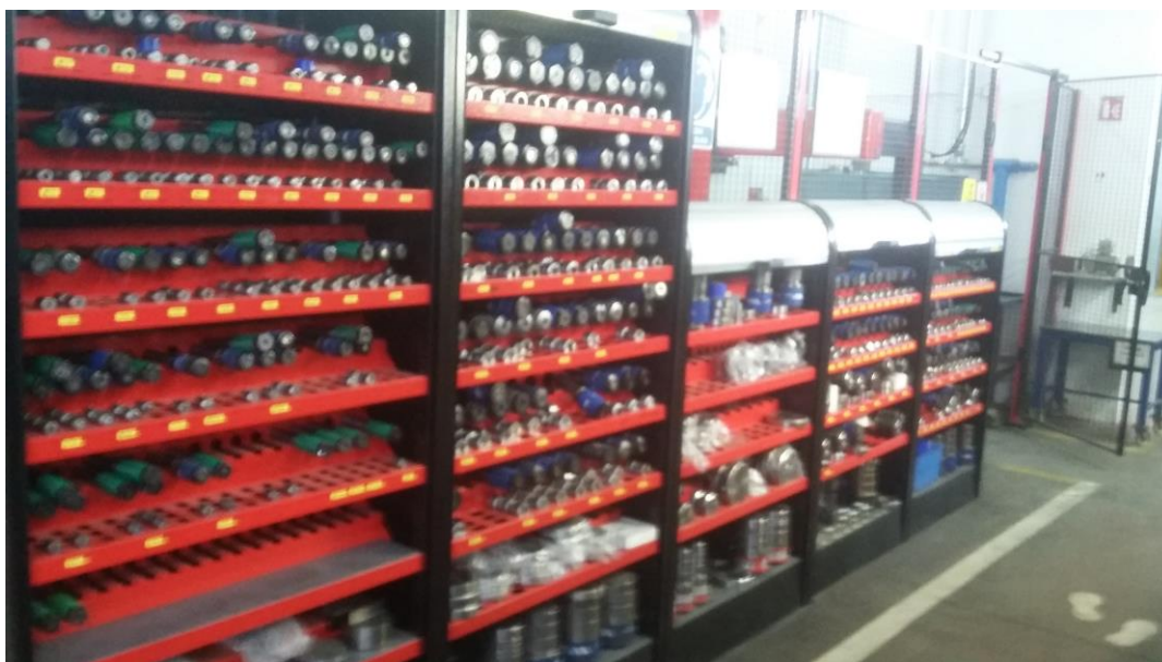
Slika 67. Ormar s alatima za štancu
