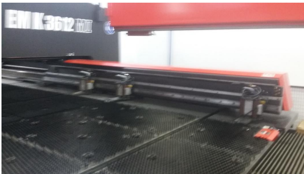
Slika 64. Stezaljke (klijesta) za stezanje limova
