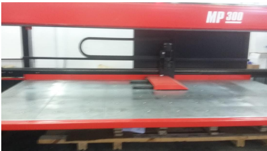
Slika 63. Graničnici prilikom stezanja limova
