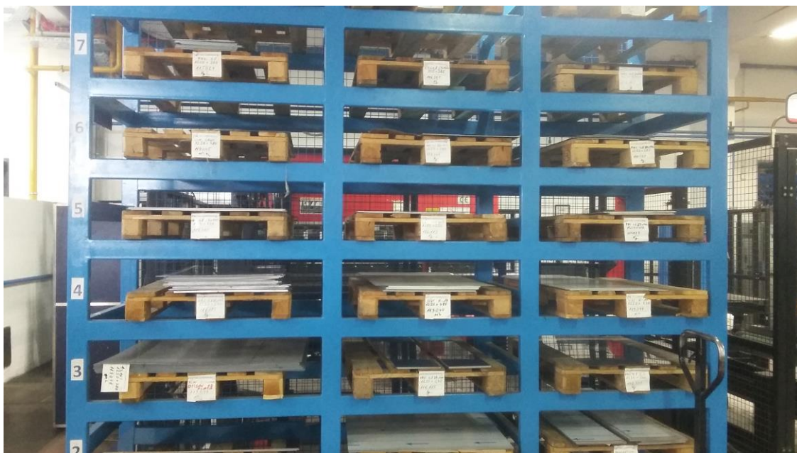
Slika 58. Skladište limova manjih dimenzija složenih u paletnom regalu
