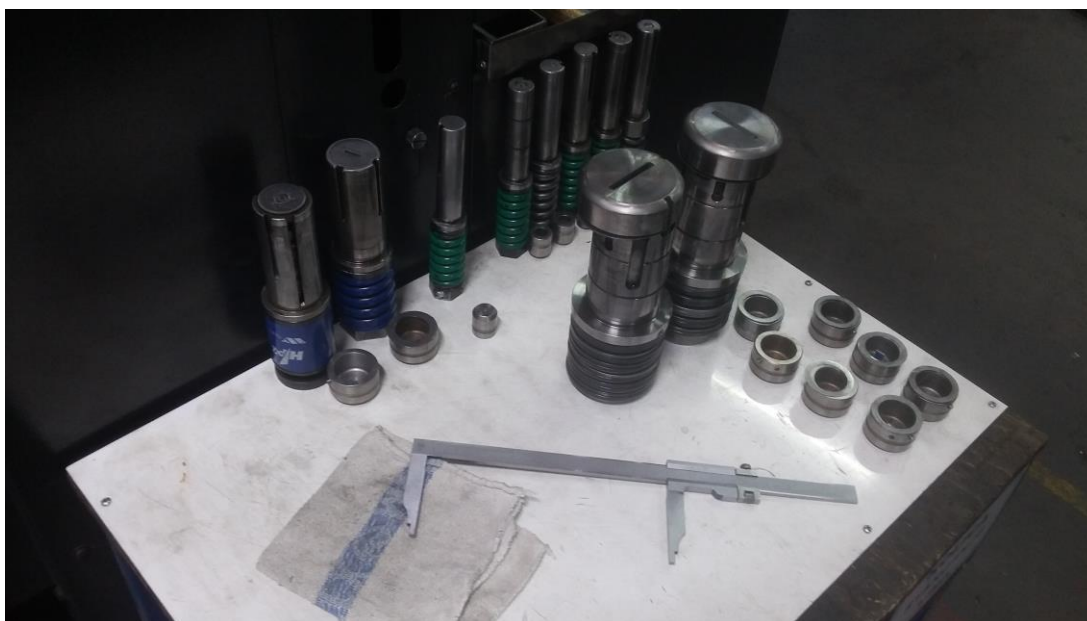
Slika 68. Alati spremni za mjerenje i stavljanje na stroj
