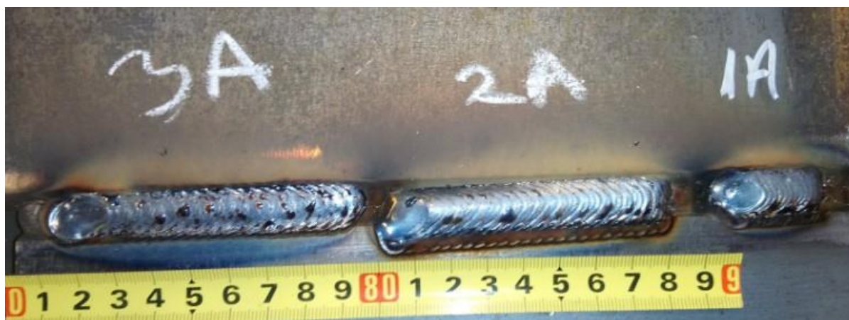
Slika 38. Zavari na uzorku A, utjecaj parametara njihanja
