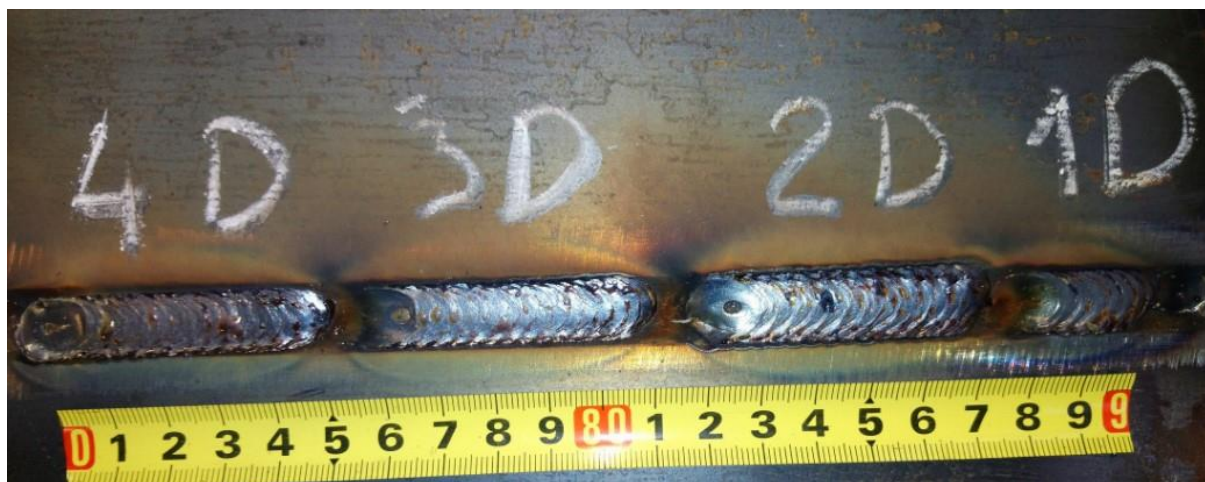
Slika 41. Zavari na uzorku D, 1D kružno njihanje; 2D, 3D, 4D utjecaj parametra odstupanja pištolja („ Offset “) i veličine amplitude njihanja
