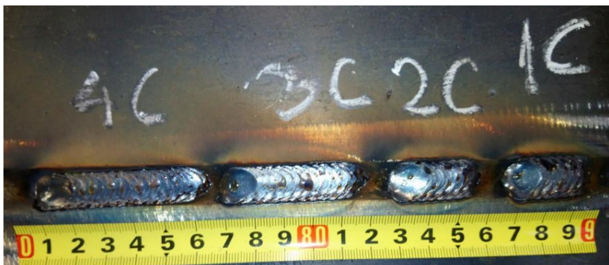
Slika 40. Zavari na uzorku C, sinusno njihanje, utjecaj veličine amplitude njihanja
