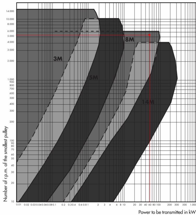
Slika 6.4. Dijagram<sup>22</sup> zupčastih remena u zavisnosti brzine vrtnje i snage
