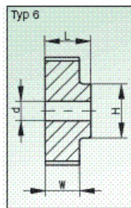
Slika 6.6. Tip 6 pogonske zupčaste remenice
