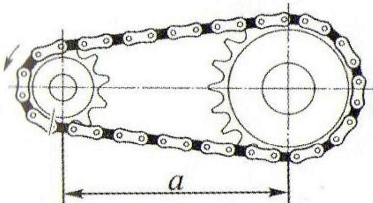
Slika 5.4. Slika lančanog prijenosa
