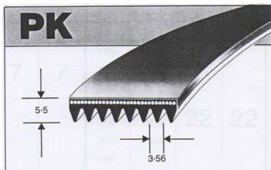
Slika 6.3. Slika profila poly-V klinastog remena PK profila
