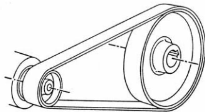
Slika 3.3. Shematski prikaz principa prijenosa lancem/remenom
