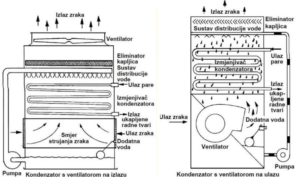
Slika 13. Kondenzator s aksijalnim ventilatorom [14]
