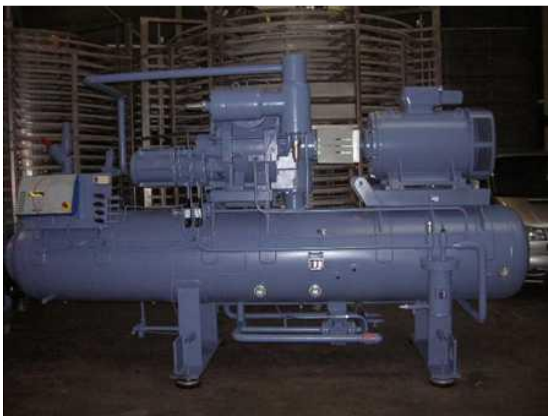
Slika 4. Kompresorska jedinica – Kompresor, odvajač ulja i hladnjak ulja [6]
