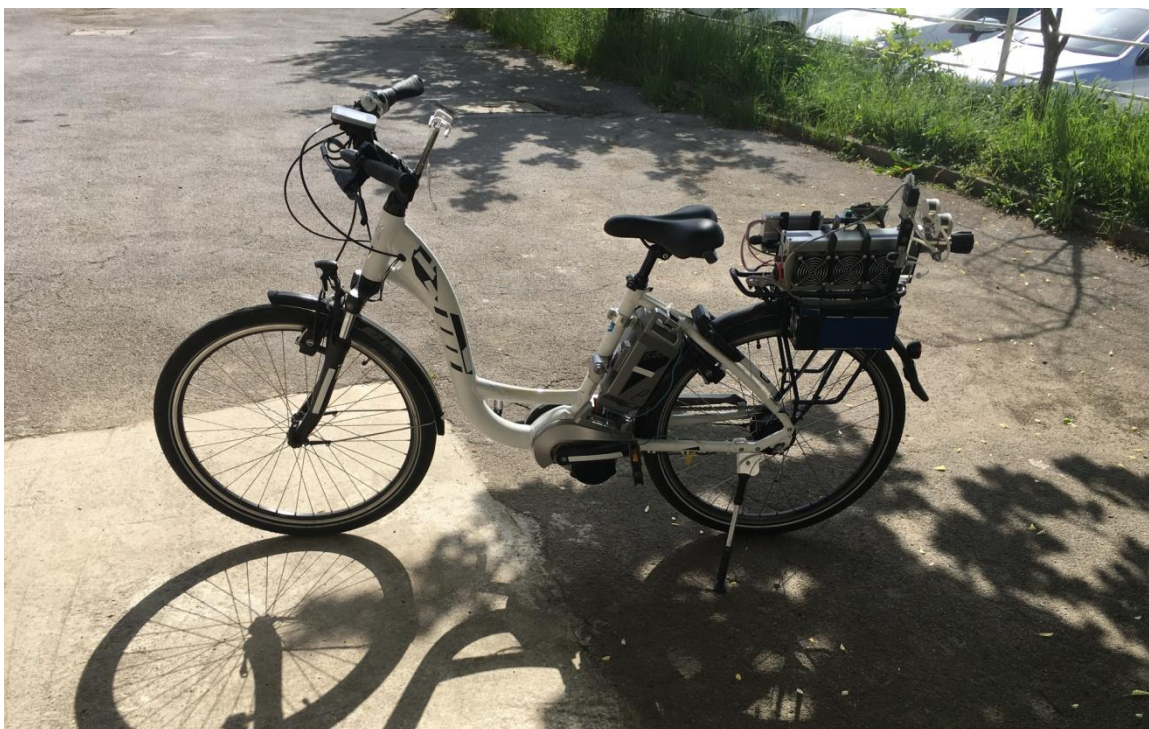
Slika 38. Prvi hrvatski bicikl na vodik
