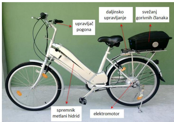
Slika 5. Električni bicikl na pogon vodikovim gorivnim člancima, Sveučilište Malaya [8]
