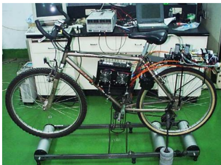
Slika 6. Električni bicikl na pogon vodikovim gorivnim člancima, Sveučilište Mingdao [9]
