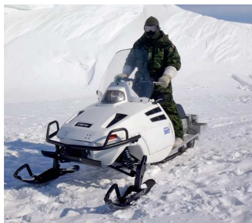
Slika 6. DEW D900 motorne saonice, Dieslov motor s turbopunjačem, mogućnost hladnog starta na -40 °C [8]
