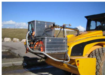
Slika 43. Primjer smještaja PEMS uređaja na odgovarajuće mjesto
