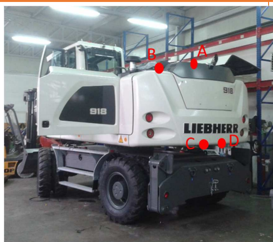
Slika 50. Mjesta prihвата nosača na stražnjem dijelu stroja
