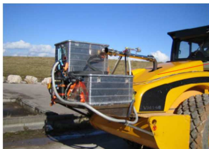
Slika 43. Primjer smještaja PEMS uređaja na odgovarajuće mjesto
