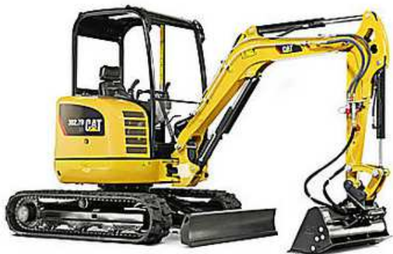
Slika 1. Bager CAT 302.7D CR deklarirane snage (prema ISO 9249) 15,2 kW, pripada potkategoriji NRE-v-2 [3]
