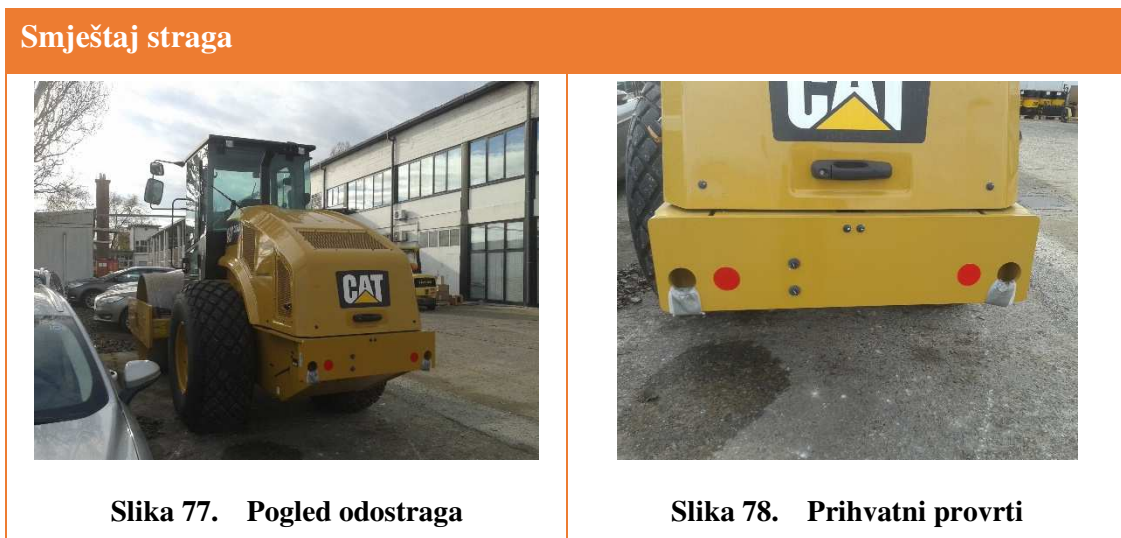
Tablica 21. Prikaz prihvatnih mjesta na stražnjem dijelu valjka Caterpillar CS54B
