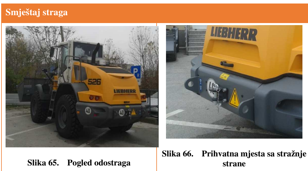
Tablica 17. Prikaz prihvatnih mjesta na stražnjem dijelu utovarivača Liebherr L 526
