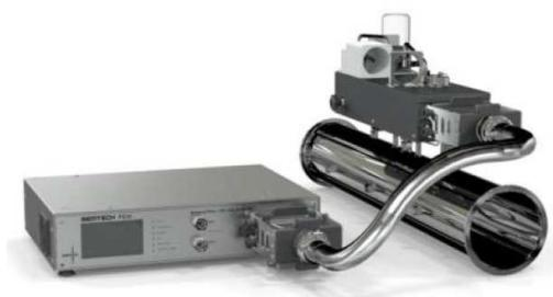
**Slika 28. Semtech-FEM integrirani sustav NDIR + EFM**
