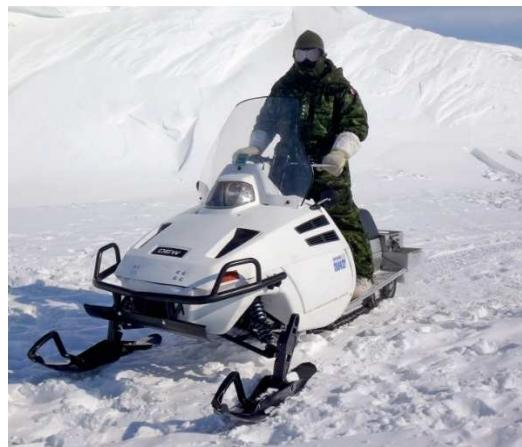
**Slika 6.** DEW D900 motorne saonice, Dieselov motor s turbopunjачem, mogućnost hladnog starta na -40 °C [8]
