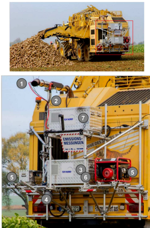
Slika 41. Detaljan prikaz smještaja PEMS opreme na pripadajućem nosaču kod stroja za vađenje šećerne repe
