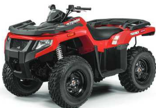
Slika 21. ATV s Ottovim motorom najveće deklarirane snage 25 kW [27]
