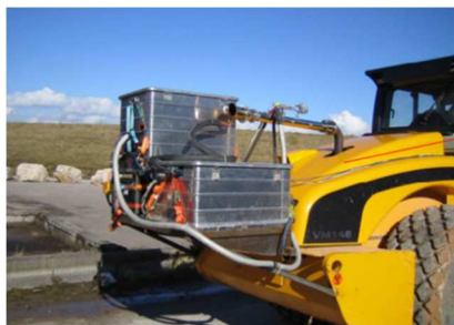
Slika 43. Primjer smještaja PEMS uređaja na odgovarajuće mjesto
