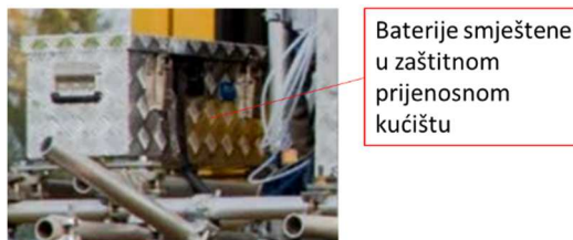
Slika 48. Primjer smještaja baterija na nosaču opreme
