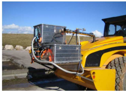
Slika 43. Primjer smještaja PEMS uređaja na odgovarajuće mjesto
