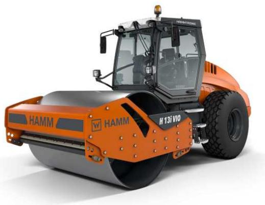
**Slika 2.** Valjak HAMM H 13i VIO, Dieselov motor snage 115 kW, pripada potkategoriji NRE-v-5 [4]
