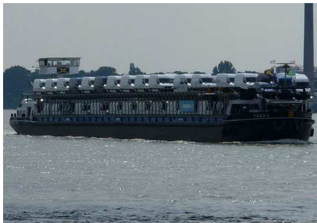
Slika 14. Brod RO-RO TERRA duljine 110 m, širine 12 m, gaza 2,16 m (umnožak širine, duljine i gaza je 2851,2 m 3 ), snage pogonskih motora P = 2 \cdot 750 kW, potkategorija IWP-v-4 [18]
