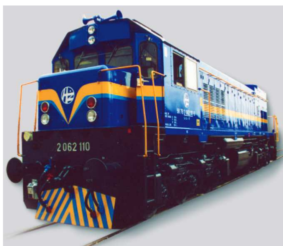
Slika 16. Lokomotiva HŽ serije 2062, General Motors, efektivne snage 1492 kW [20]
