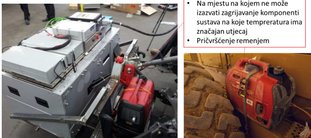
Slika 47. Primjeri pravilnog smještaja generatora na konstrukciju stroja
