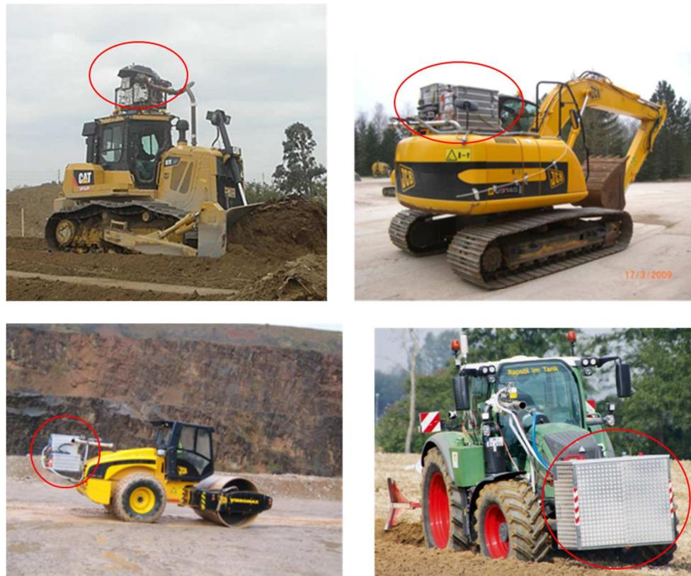
Slika 40. Primjeri stvarnih izvedbi smještaja PEMS uređaja na veće strojeve
