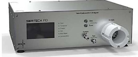
**Slika 26. Semtech FID analizator za mjerjenje koncentracije HC**
