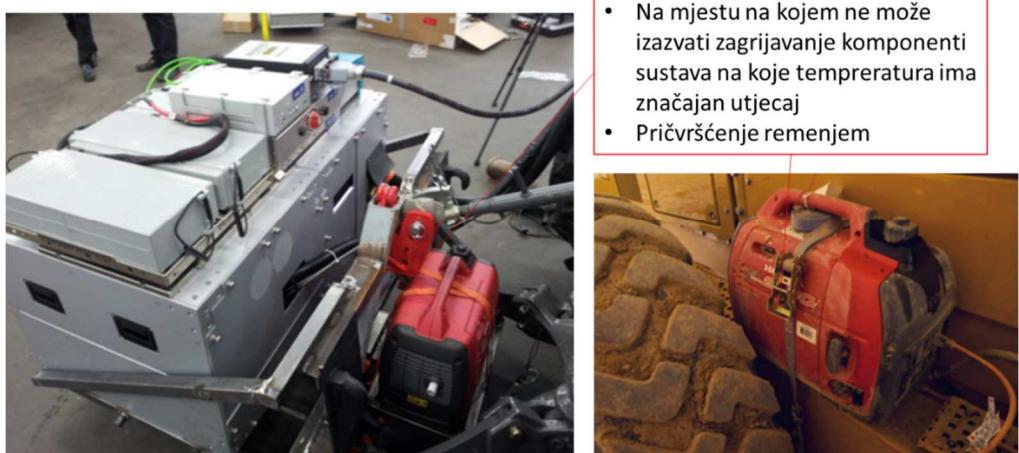
**Slika 47.** Primjeri pravilnog smještaja generatora na konstrukciju stroja
