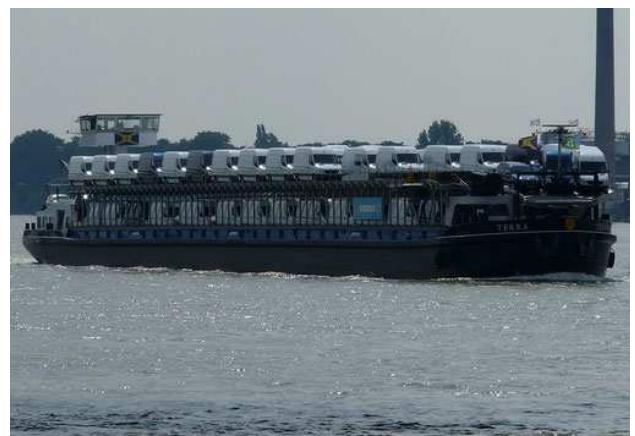
**Slika 14.** Brod RO-RO TERRA duljine 110 m, širine 12 m, gaza 2,16 m (umnožak širine, duljine i gaza je 2851,2 m<sup>3</sup>), snage pogonskih motora  $P = 2 \cdot 750$  kW, potkategorija IWP-v-4 [18]
