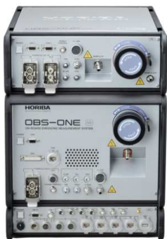
Slika 24. Analizator ispušnih plinova Horiba OBS-One-GS12 [31]
