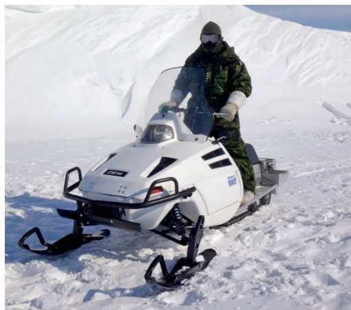
Slika 6. DEW D900 motorne saonice, Dieslov motor s turbopunjačem, mogućnost hladnog starta na -40\text{ }^{\circ}\text{C} [8]
