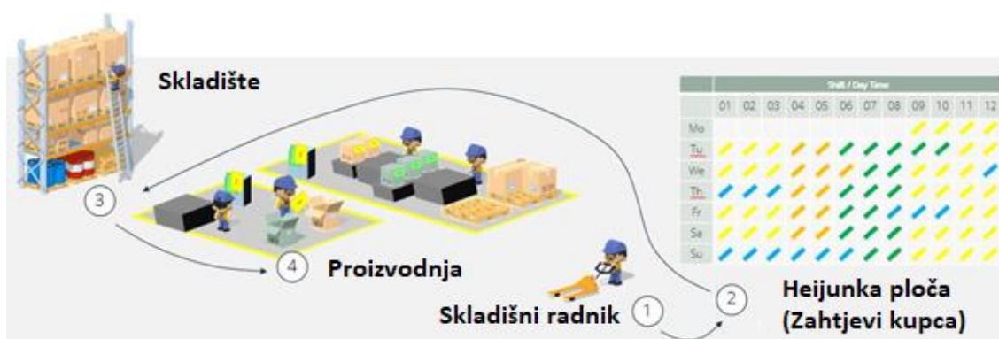
Slika 14. Prikaz planiranja proizvodnje pomoću Heijunka ploče [19]
