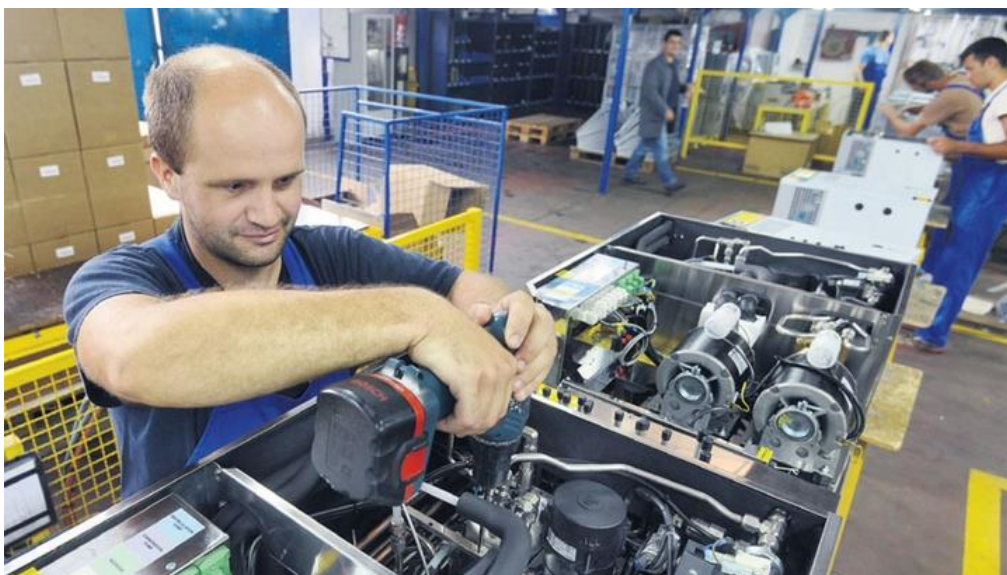
Slika 46. Prikaz montaže točionih aparata [33]
