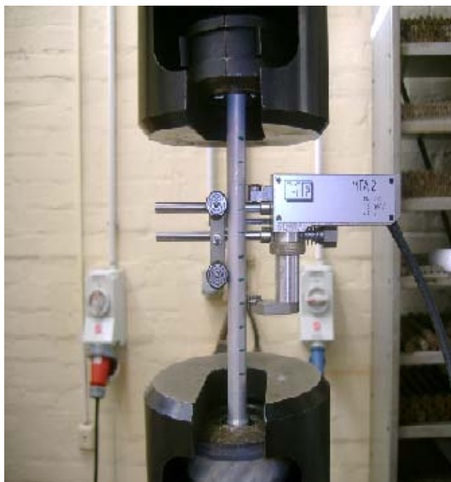
Slika 25. Električni ekstenzimetar na prednapregnutoj aluminijskoj epruveti
