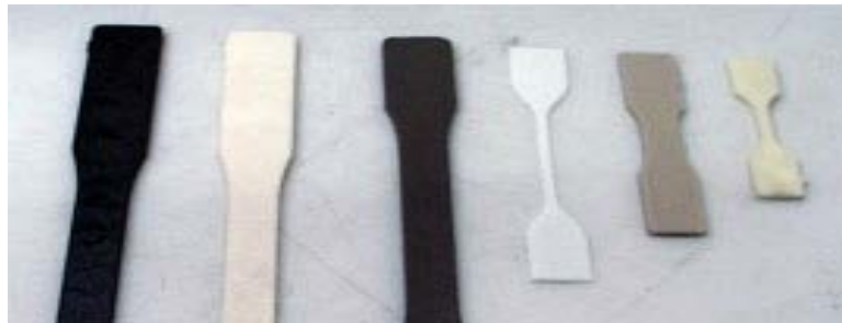
Slika 8. Epruvete od polimernih masa (plastomeri, elastomeri i duromeri) [4]
