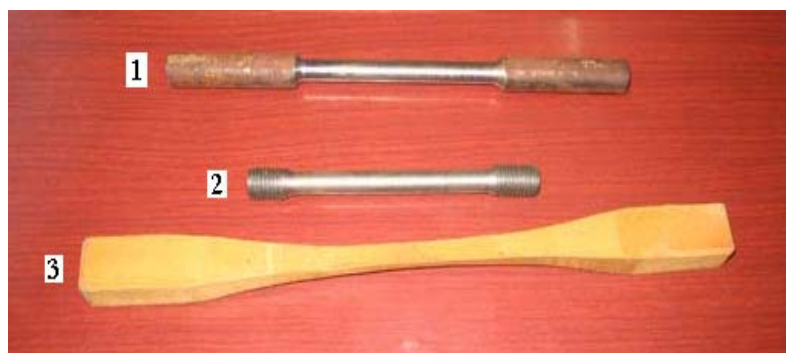
Slika 9. Epruvete od čelika (1), nodularnog ljeva (2), drva (3) [4]
