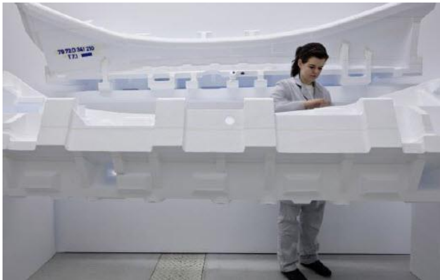
Slika 54. Lijepljenje sastavnih elemenata modela za lijevanje, [5]
