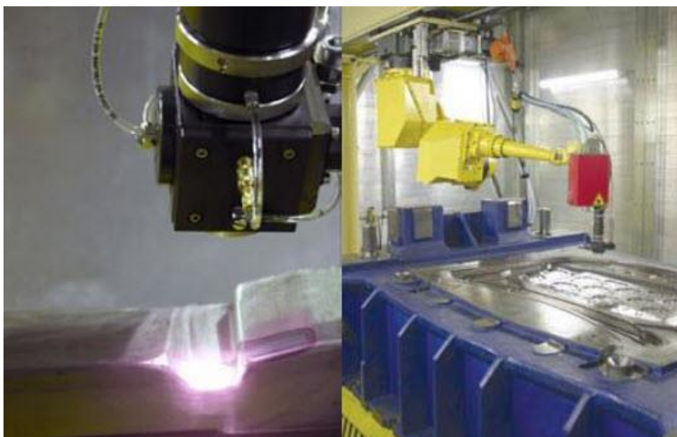
Slika 46. Lokalno otvrdnjivanje površine, [5]
