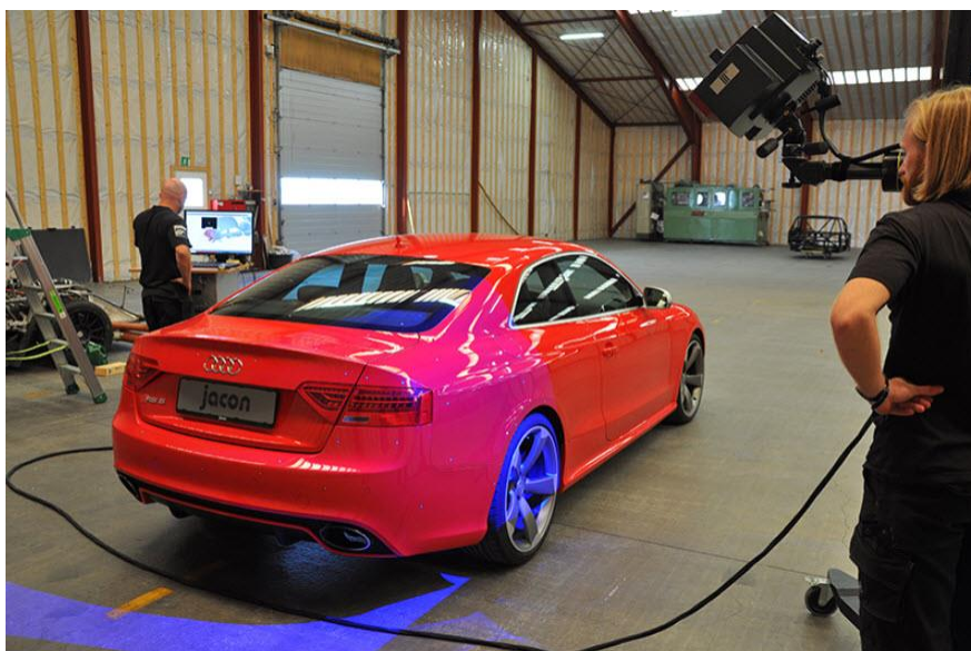
Slika 34. 3D „skeniranje“ automobila, [41]
