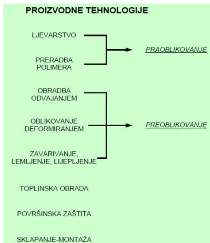
Slika 5. Podjela proizvodnih tehnologija prema DIN 8580, [7]
