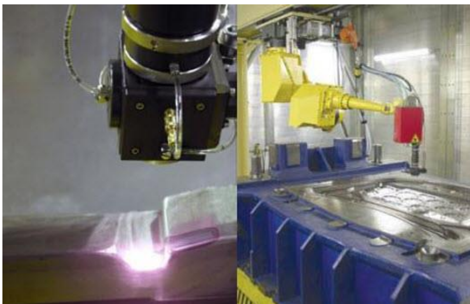
Slika 46. Lokalno otvrdnjivanje površine, [5]
