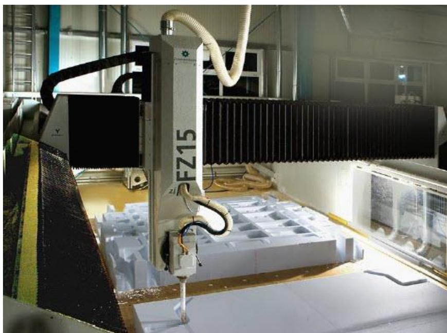
Slika 53. Izrada modela za lijevanje od polistirena, [5]
