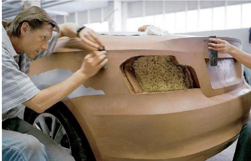
Slika 33. Primjer ručne dorade glinenog modela automobila u stvarnoj veličini, [5]
