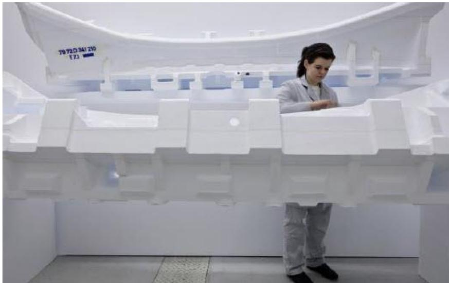
**Slika 54. Lijepljenje sastavnih elemenata modela za lijevanje, [5]**
