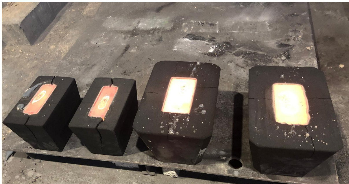
Slika 17. Kalupi nakon lijevanja
