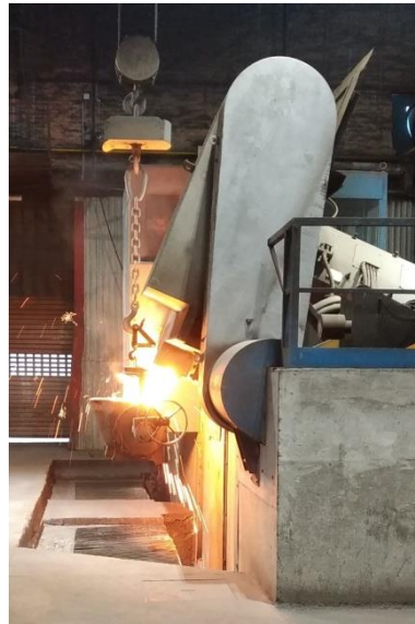
Slika 14. Ispust primarne taljevine u lonac za obradu
