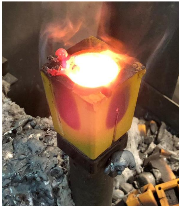
Slika 18. Quik-cup® čašica za provođenje jednostavne toplinske analize
