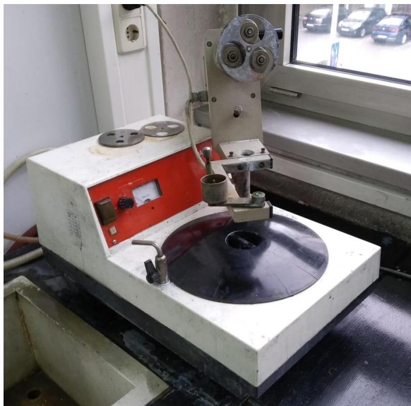
Slika 28. Uređaj za poliranje
