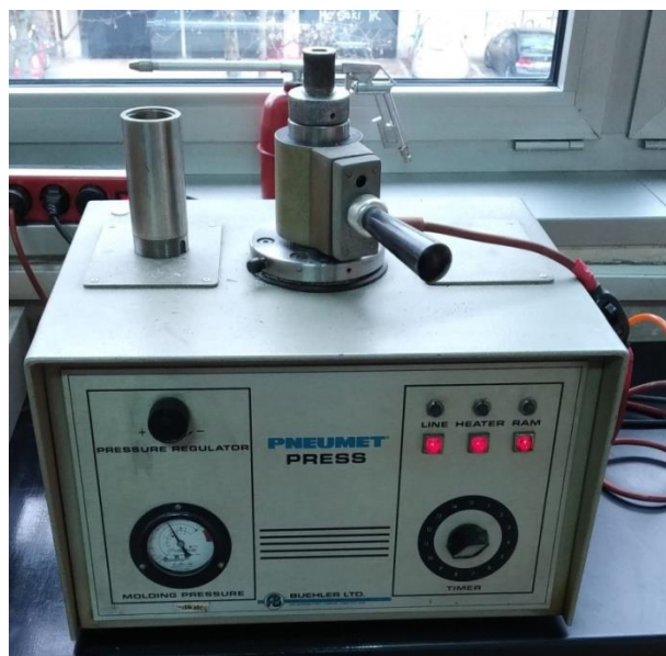
Slika 25. Uređaj za toplo ulijevanje uzorka
