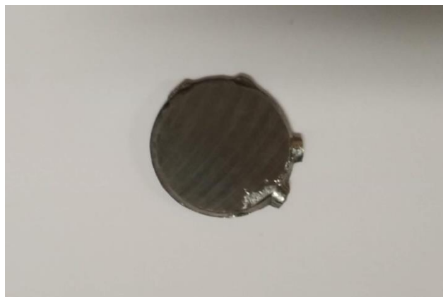
Slika 19. Uzorak za određivanje kemijskog sastava
