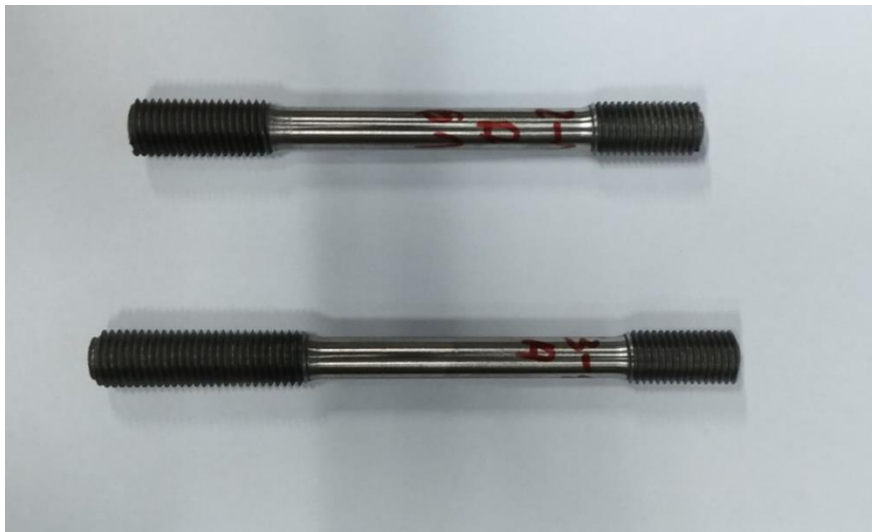
Slika 22. Epruvete za statičko vlačno ispitivanje
