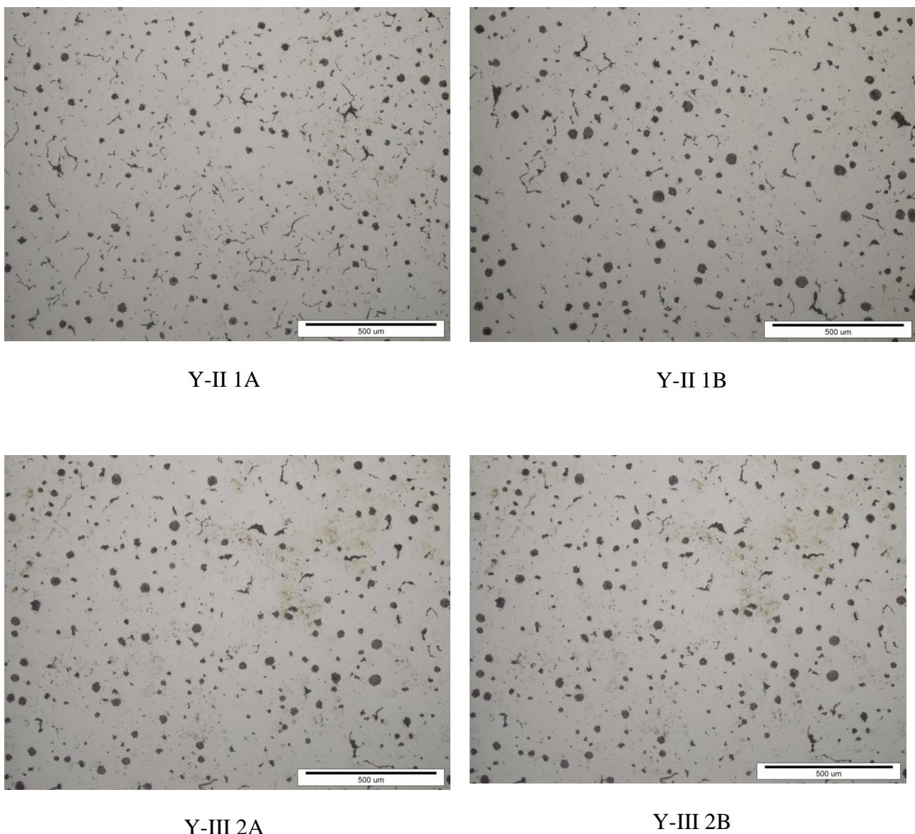
Slika 35. Mikrostruktura uzoraka u poliranom stanju
