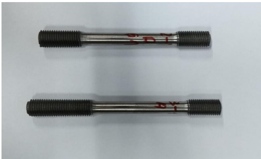
Slika 22. Epruvete za statičko vlačno ispitivanje
