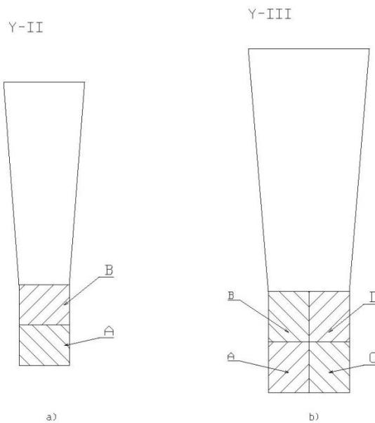
Slika 21. Y probe, a) debljina stjenke 25 mm b) debljina stjenke 50 mm
