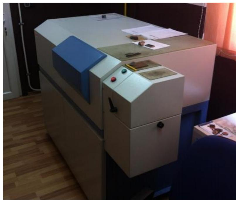
Slika 20. Spektrometar ARL 3460
