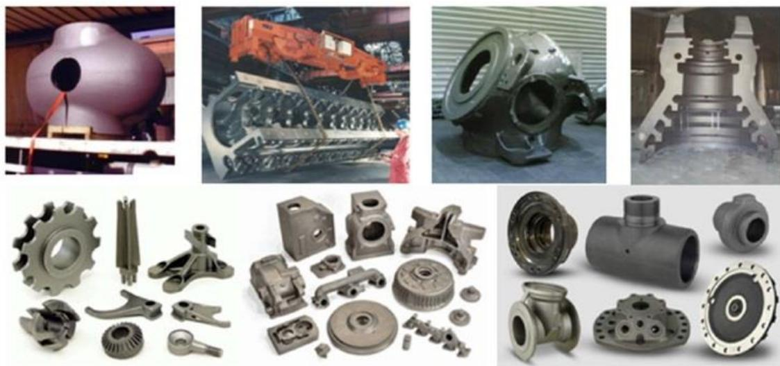
Slika 3. Odljevci od nodularnog lijeva[1]
