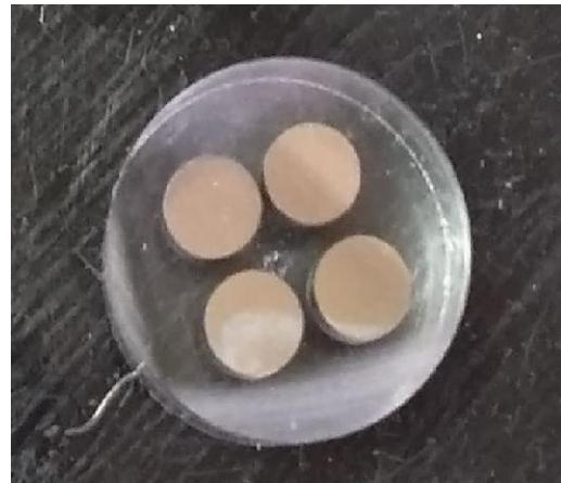
Slika 26. Uzorci za metalografsko ispitivanje
