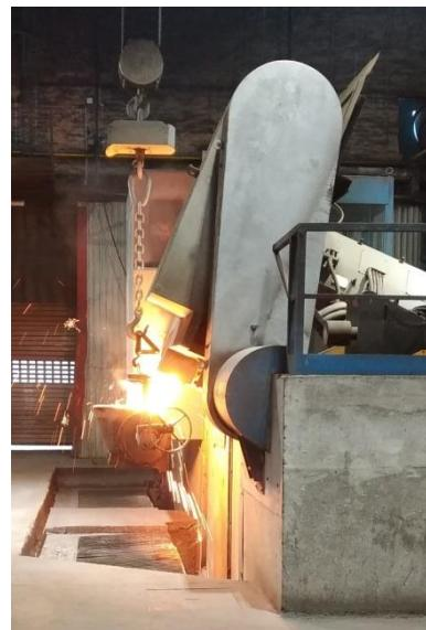
Slika 14. Ispust primarne taljevine u lonac za obradu
