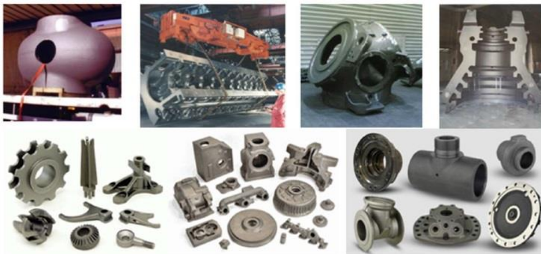
Slika 3. Odljevci od nodularnog lijeva[1]
