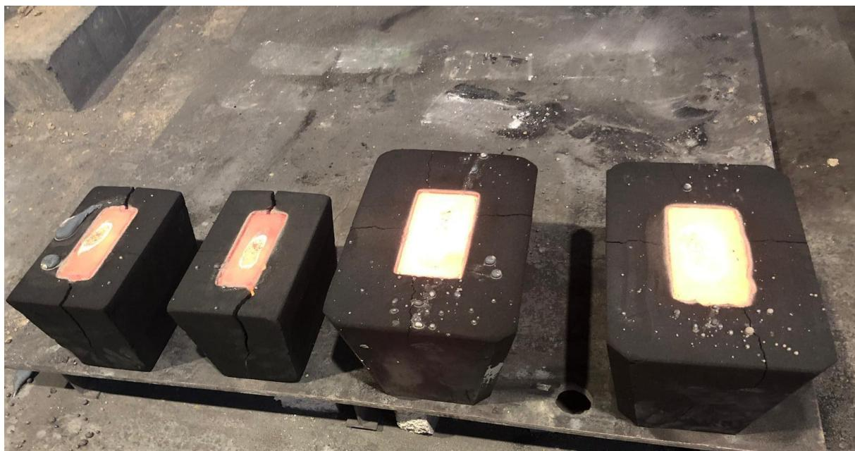
Slika 17. Kalupi nakon lijevanja
