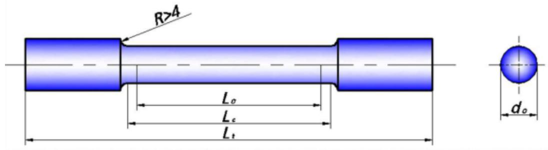
Slika 23. Epruveta s glavnim veličinama za statičko vlačno ispitivanje
