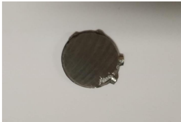
Slika 19. Uzorak za određivanje kemijskog sastava
