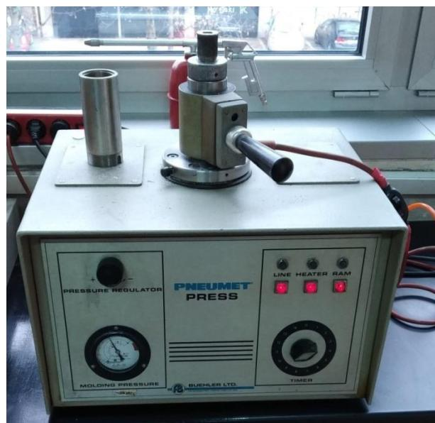
Slika 25. Uređaj za toplo ulijevanje uzorka
