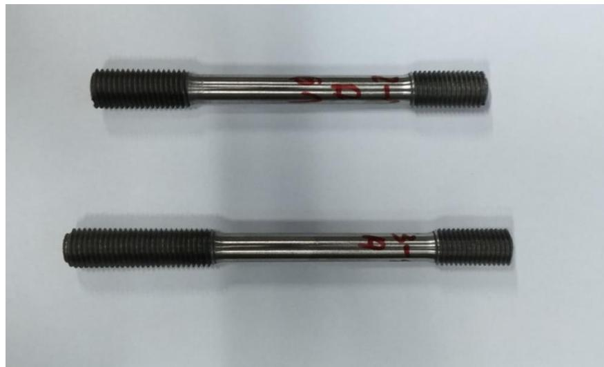
Slika 22. Epruvete za statičko vlačno ispitivanje
