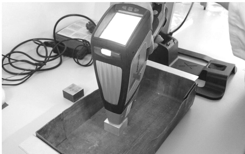
Slika 10. Određivanje sastava uzoraka XRF uređajem
