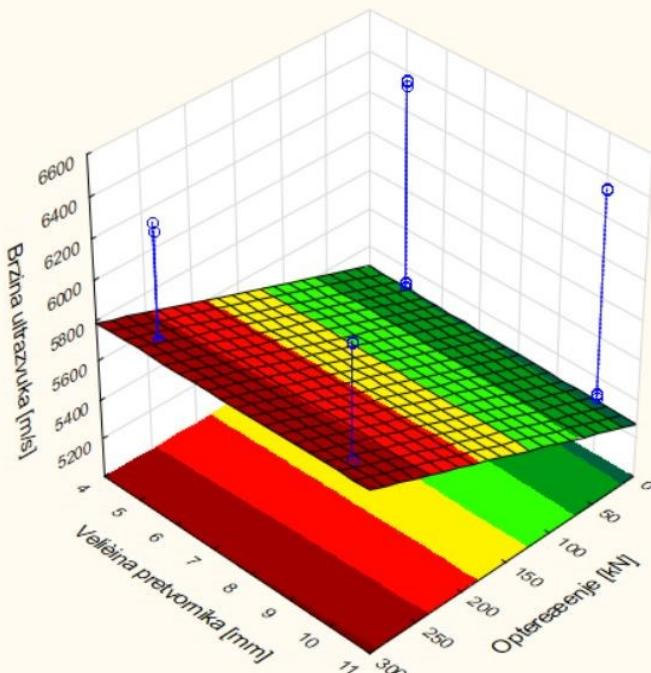
**Slika 7-4. Brzina ultrazvuka= f(opterešenje, veličina pretvornika, materijal =konst, nazivna frekvencija =konst)**
