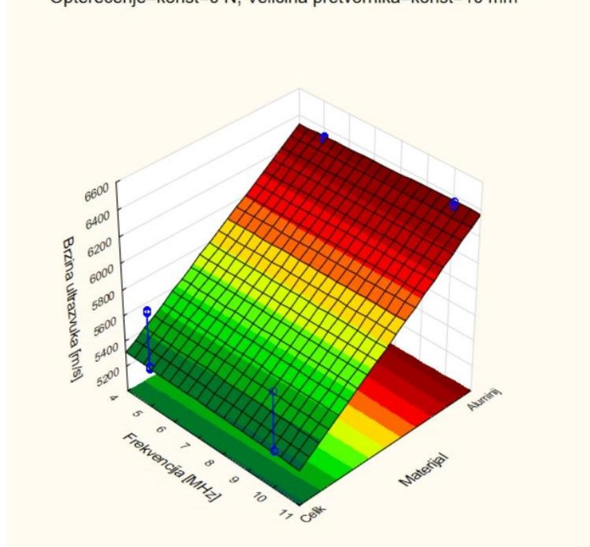
Opterećenje=konst=274,5862 N; Veličina pretvornika=konst=5 mm
