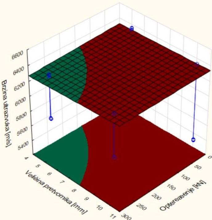
Nazivna frekvencija=konst=10 MHz; Materijal=konst=Aluminij
