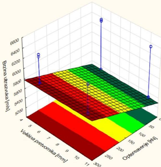
Nazivna frekvencija=konst=10 MHz; Materijal=konst=Celik
