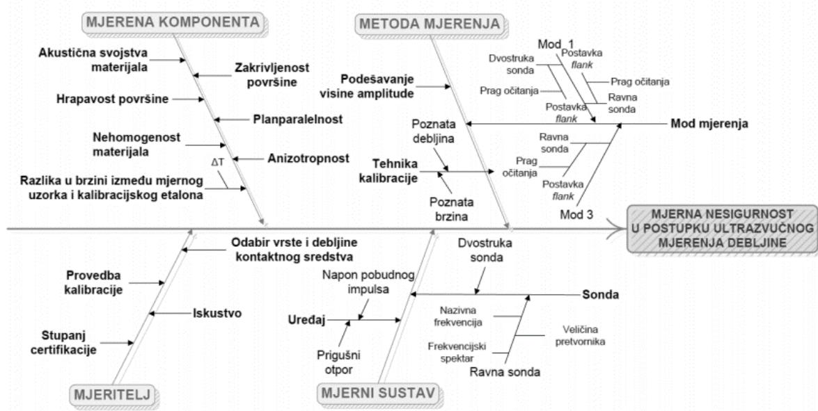
Slika 2. Utjecaji koji doprinose nesigurnosti rezultata u postupku ultrazvučnog mjerjenja debljine [6]
