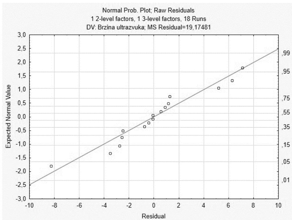
**Slika 18. Papir vjerojatnosti ostataka rezultata mjerjenja ultrazvučne brzine novog modela eksperimenta**
