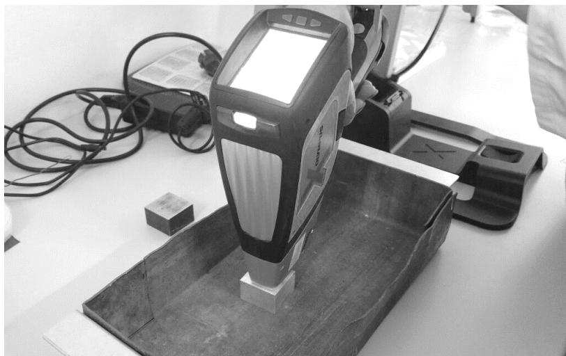
Slika 10. Određivanje sastava uzoraka XRF uređajem
