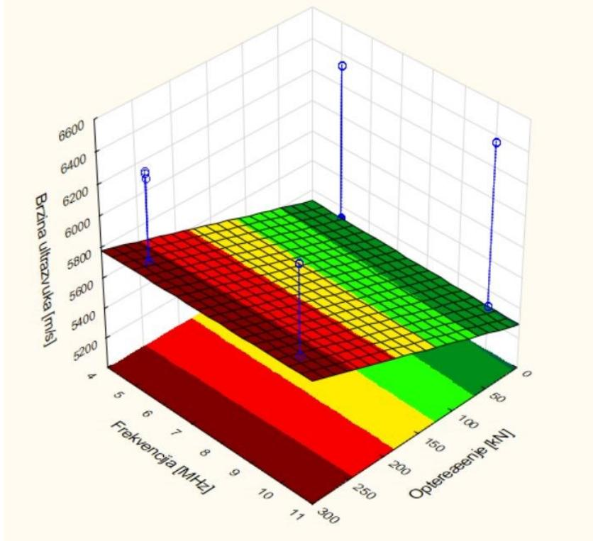
**Slika 7-2. Brzina ultrazvuka= f(nazivna frekvencija, opterećenje, veličina pretvornika=konst, materijal=konst)**
