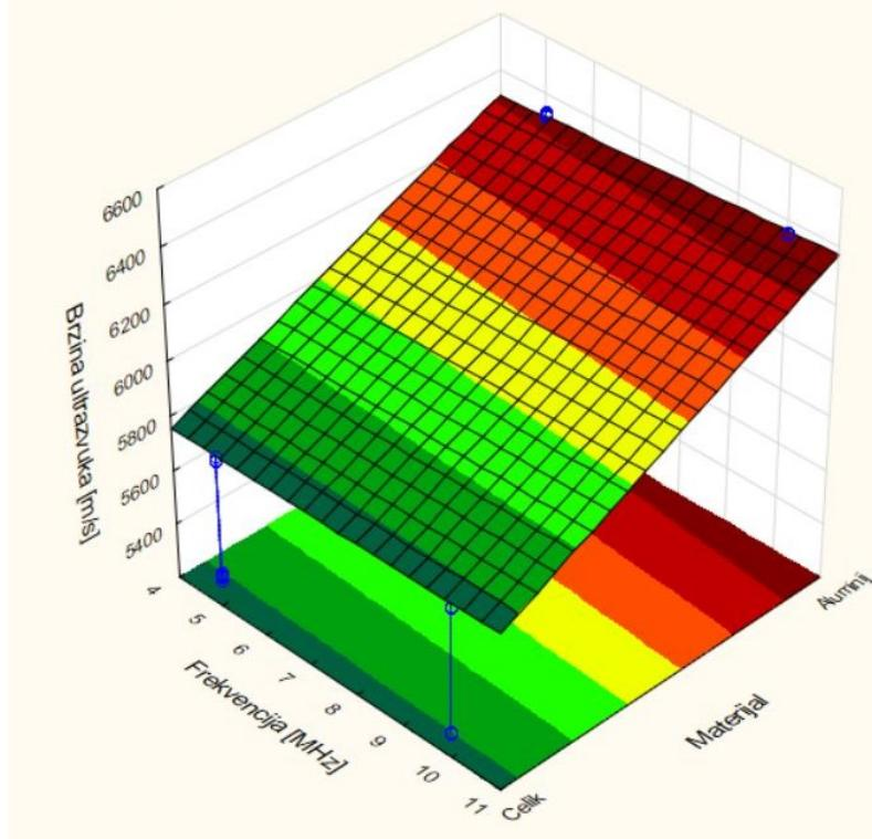
**Slika 7-3. Brzina ultrazvuka= f(nazivna frekvencija, materijal, veličina pretvornika=konst, opterećenje=konst)**
