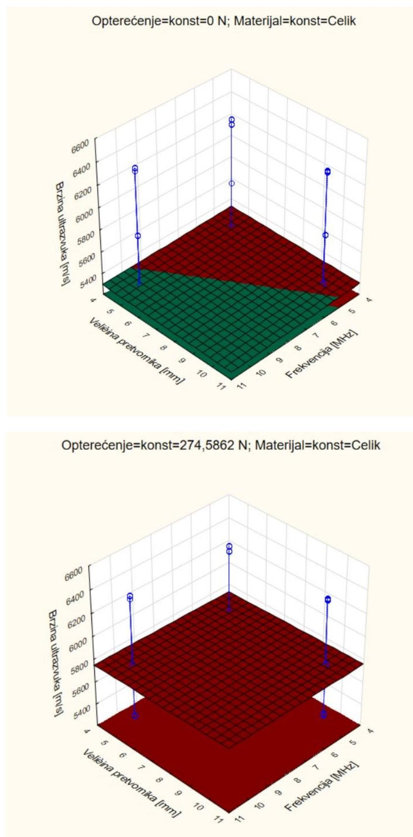
**Slika 7-6. Brzina ultrazvuka= f(nazivna frekvencija, veličina pretvornika, materijal =konst, opterećenje=konst)**
