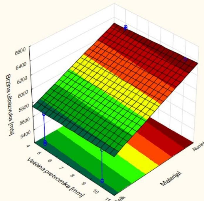
**Slika 7-5. Brzina ultrazvuka= f(materijal, veličina pretvornika, opterećenje=konst, nazivna frekvencija=konst)**
