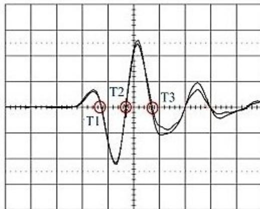
Slika 15. Točke mjerjenja vremena proleta na preklopljenim signalima
