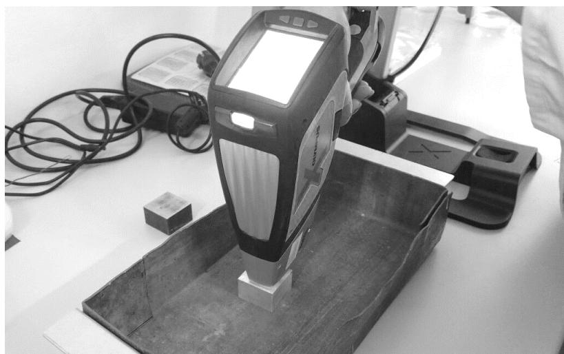
**Slika 10. Određivanje sastava uzorka XRF uređajem**
