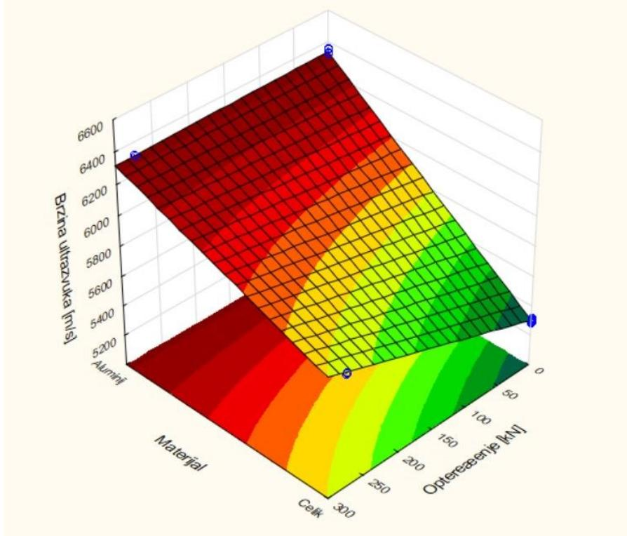
**Slika 7-1. Brzina ultrazvuka= f(opterećenje, materijal, veličina pretvornika =konst, nazivna frekvencija =konst)**
