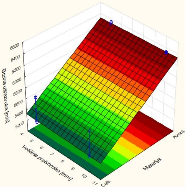
Opterećenje=konst=0 N; Nazivna frekvencija=konst=10 MHz
