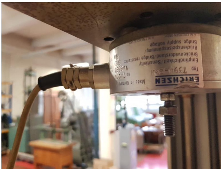
Slika 16. Senzor sile montiran na pokretnu traverzu
