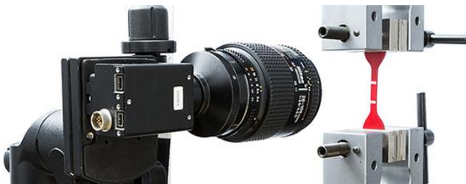
Slika 6. Suvremeni video ekstenzometar [13]
