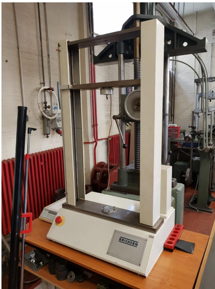
Slika 14. Kidalica u Laboratoriju za ispitivanje mehaničkih svojstava
