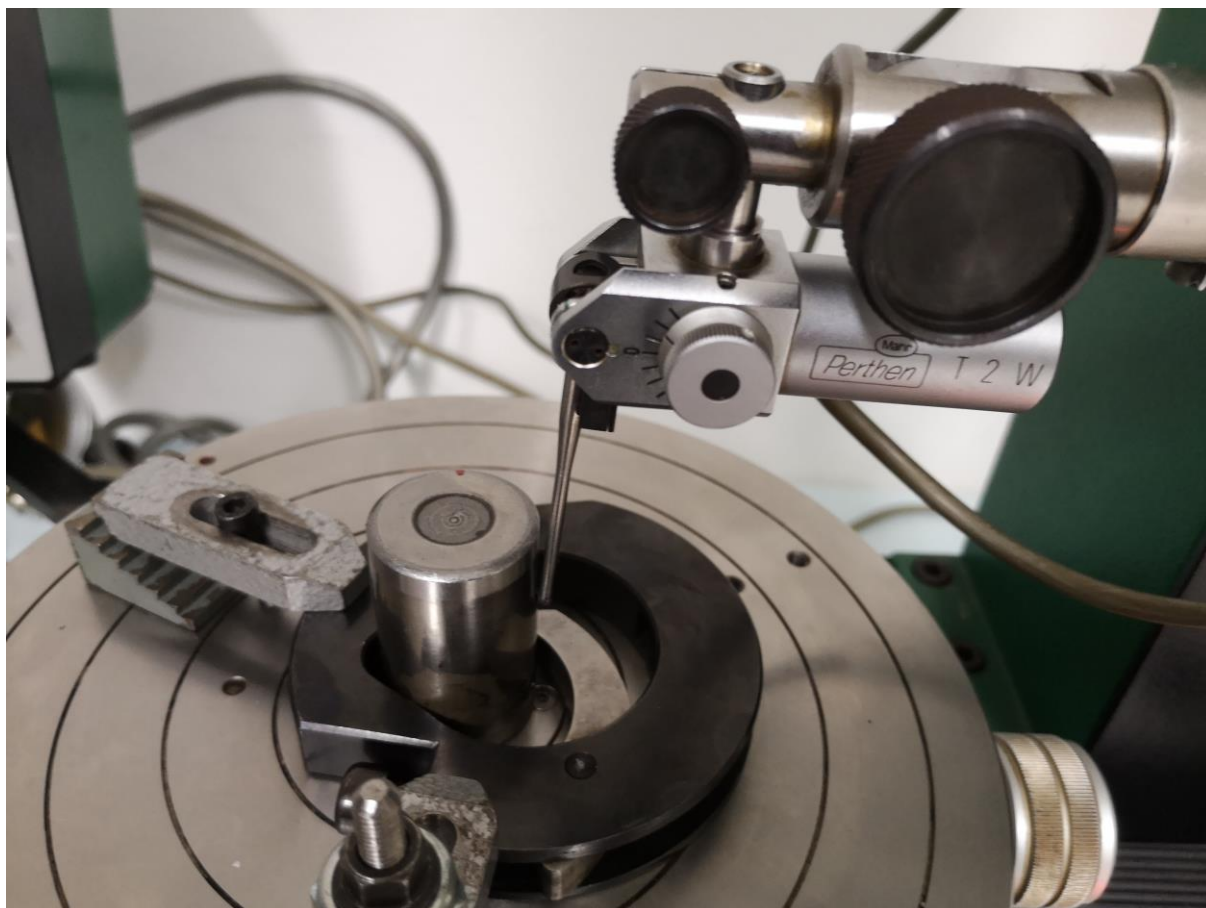
Slika 52. Početni položaj prvog mjerenja „Donaldson reversal“ metode
