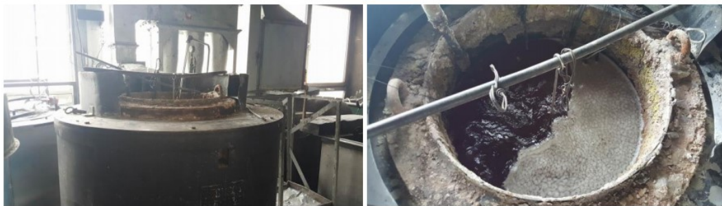
Slika 24. Solna kupka za nitriranje postupkom TENIFER [18]
