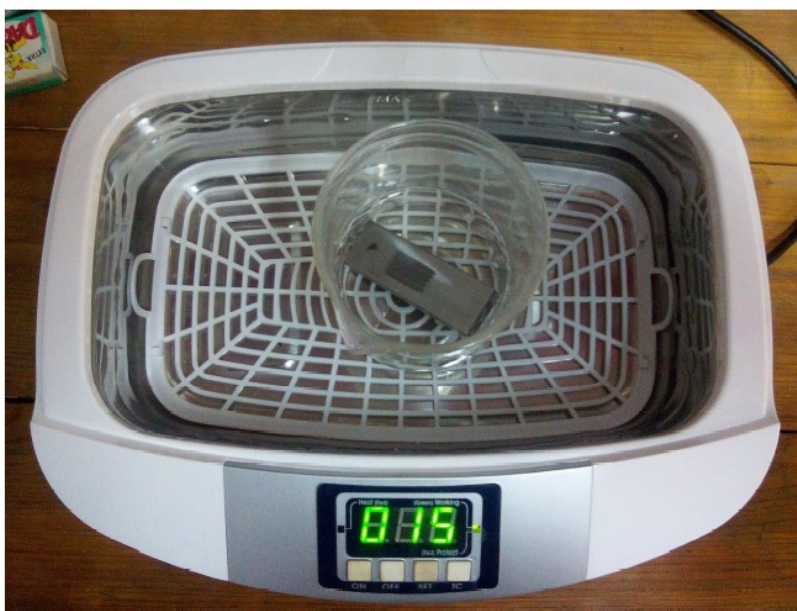
Slika 39. Čišćenje ispitnog uzorka u ultrazvučnoj kupki
