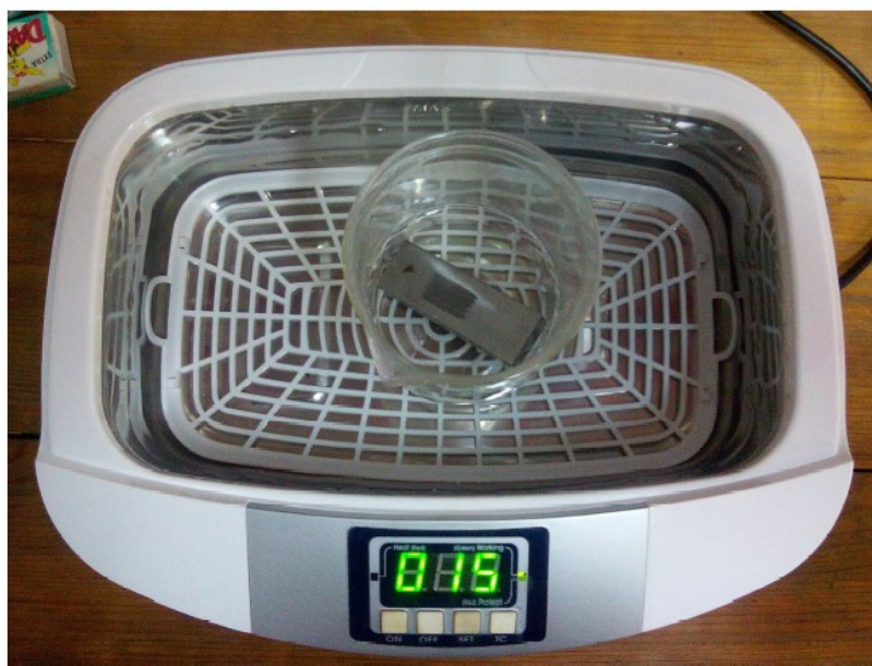
Slika 39. Čišćenje ispitnog uzorka u ultrazvučnoj kupki
