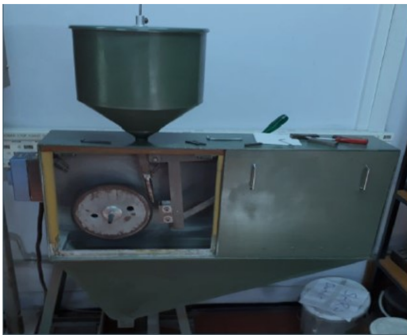
Slika 20. Uređaj za ispitivanje otpornosti na abrazijsko trošenje [7]
