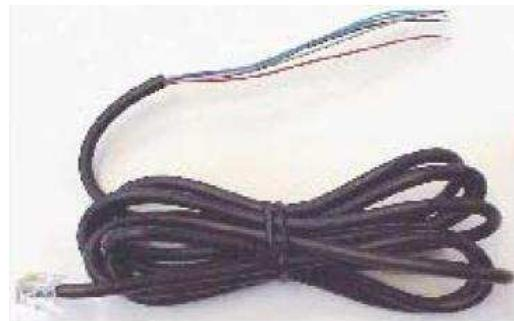
Slika 4.3 TAE kabel za napajanje TC35 modula
