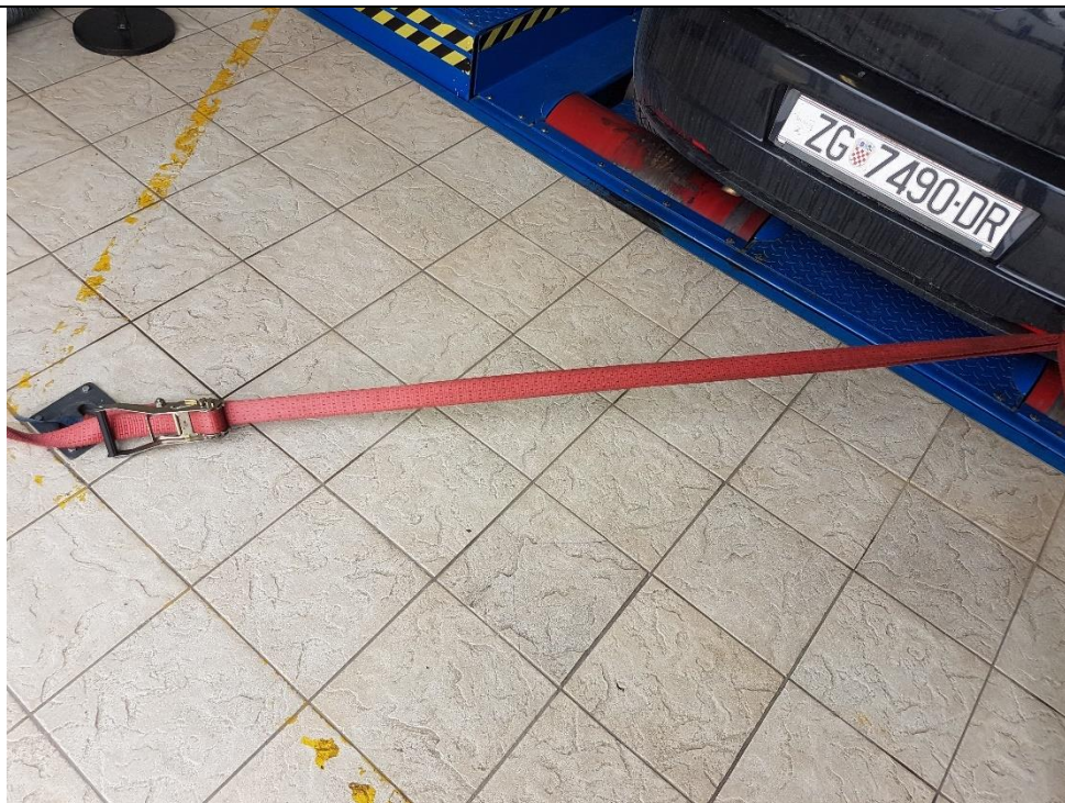
Slika 18. Osiguranje stražnjeg kraja vozila od ispadanja
