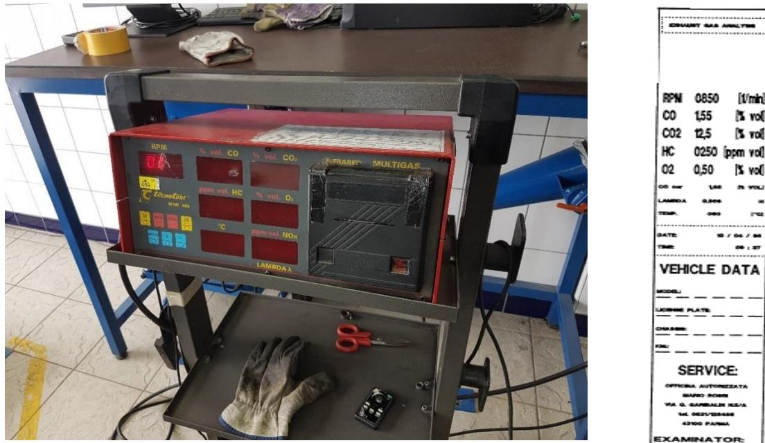
Slika 14. Lijevo: Tecnotest 488; Desno: Primjer ispisanih rezultata [9]
