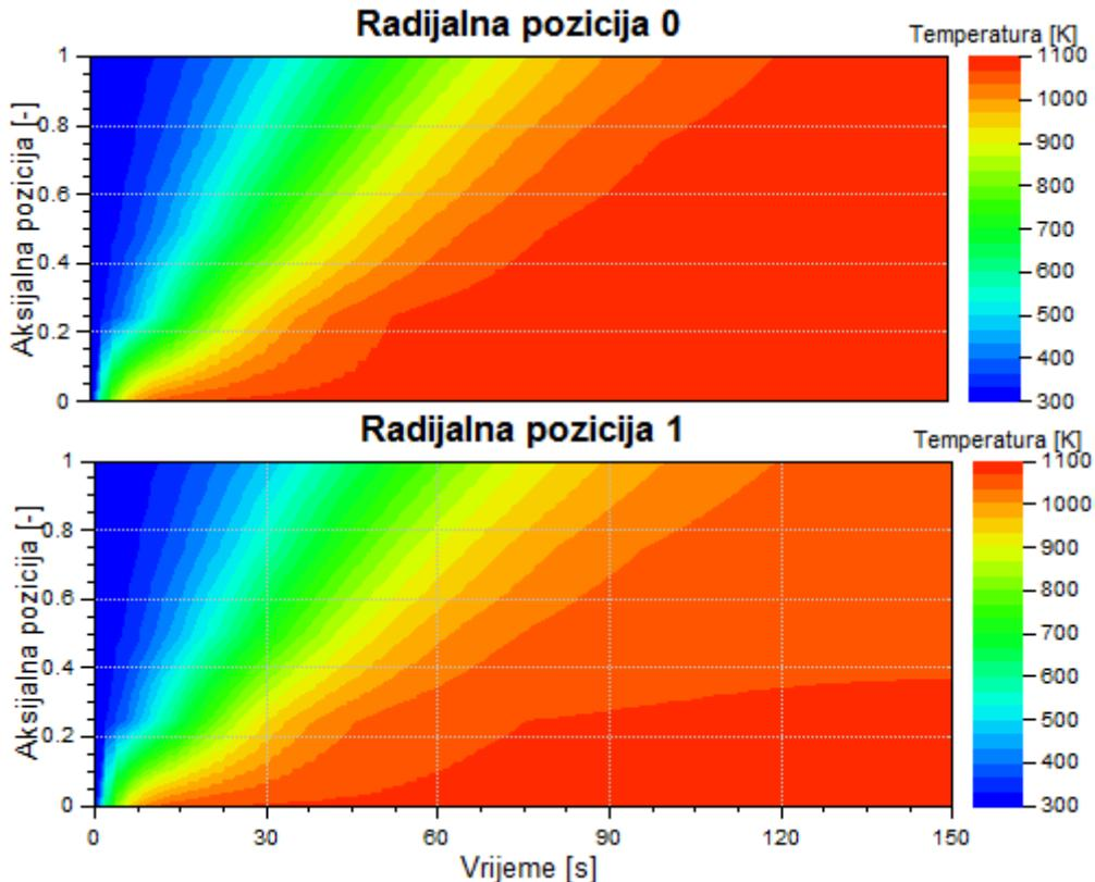
**Slika 47. Zagrijavanje monolita katalizatora kod 2-D diskretizacije za radikalne pozicije 0 i 1**
