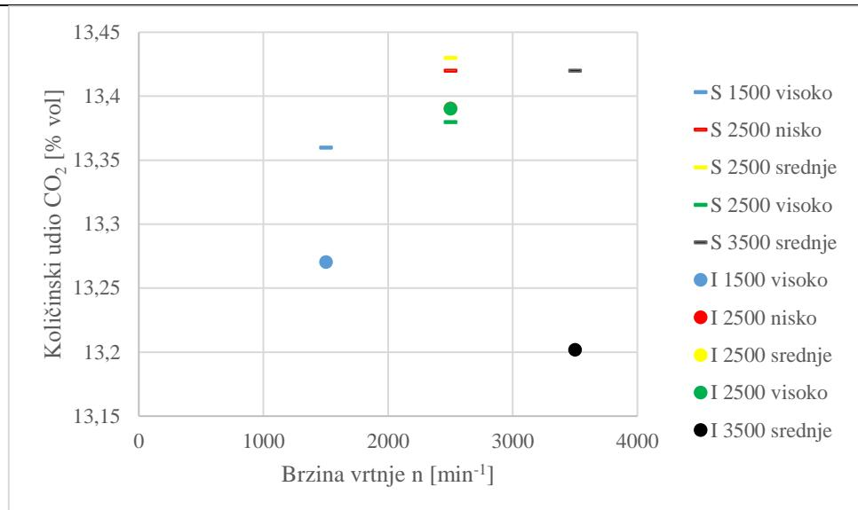
**Slika 67. Usporedba količinskog udjela CO<sub>2</sub> nakon katalitičke obrade za simulaciju i mjerjenje**
