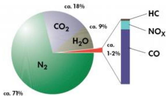
**Slika 1. Sastav ispušnih plinova Ottovog motora [1]**
