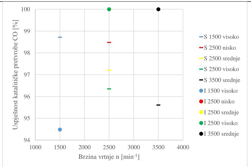
**Slika 65. Usporedba uspješnosti pretvorbe CO za simulaciju i za izmjerene vrijednosti**
