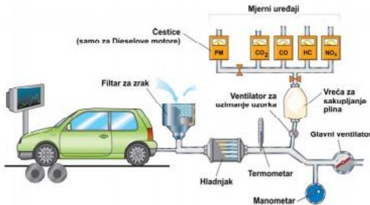
**Slika 6. Shematski prikaz ispitnog postava za štetne emisije [1]**
