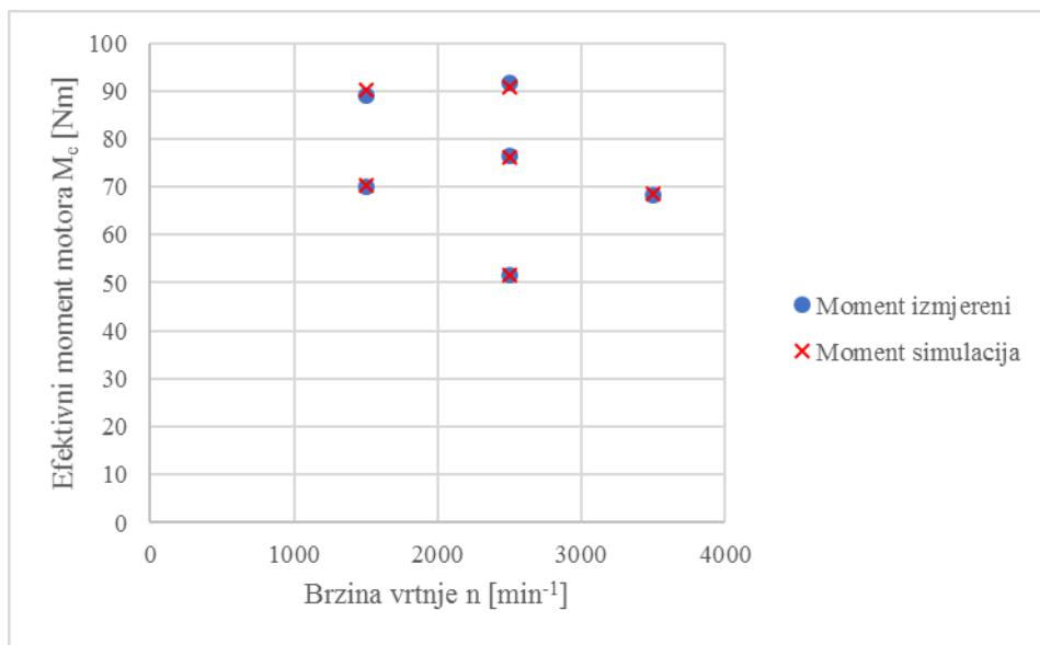
Slika 39. Poklapanje izmjerjenog i simuliranog momenta
