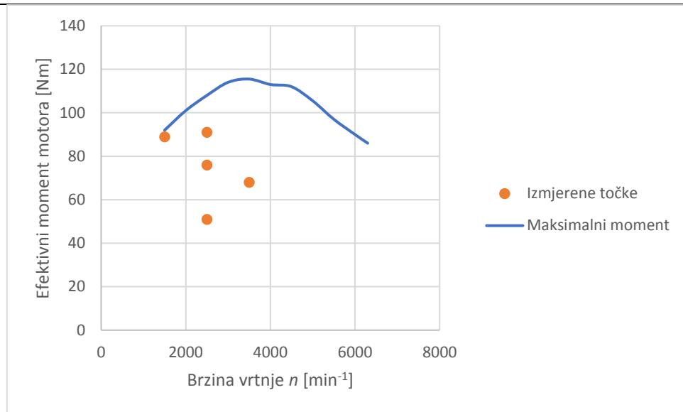
**Slika 15. Mjerne točke prikazane u mapi rada motora**
