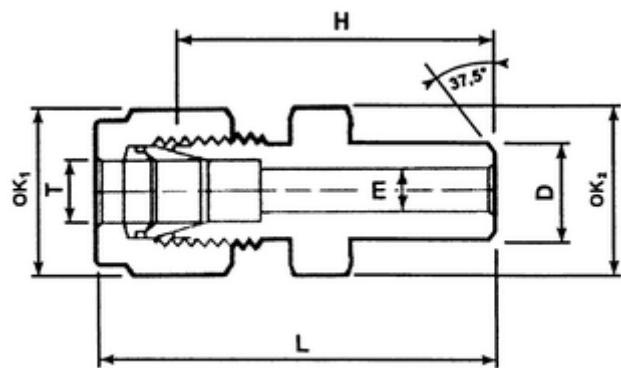
Slika 9. Tehnička dokumentacija Hermeto spojnica korištene za ispitivanje [7]
