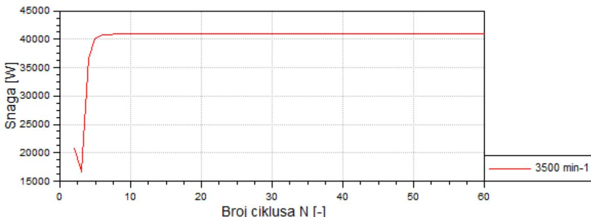
Slika 34. Konvergencija snage pri  $3500 \text{ min}^{-1}$
