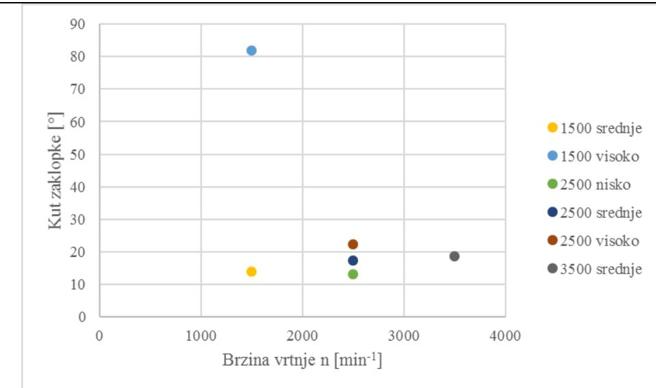
Slika 38. Kut otvorenosti zaklopke ovisno o brzini vrtnje i opterećenju
