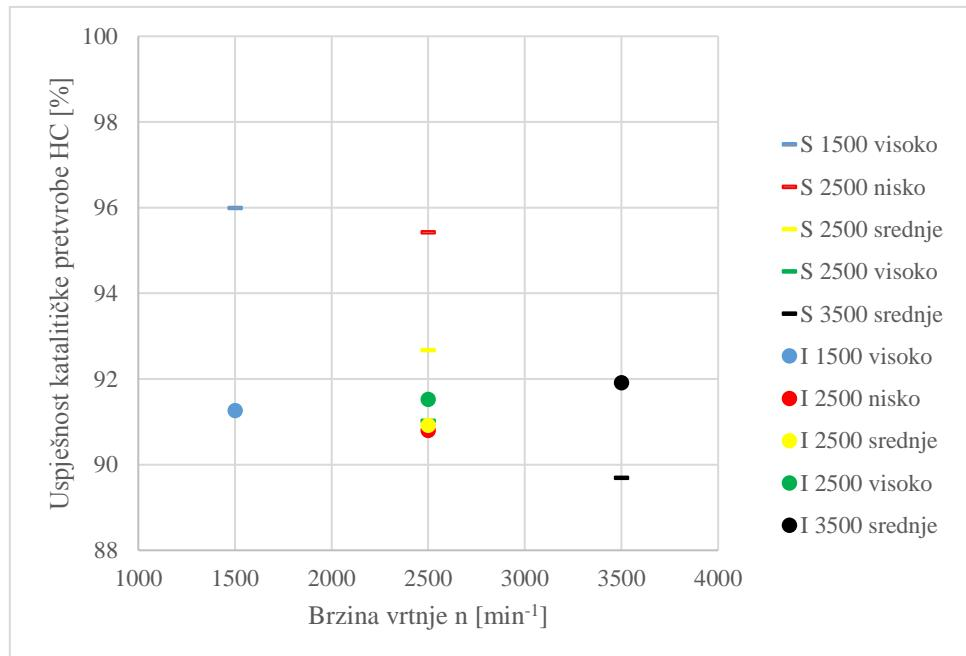
**Slika 64. Usporedba uspješnosti pretvorbe HC za simulaciju i za izmjerene vrijednosti**
