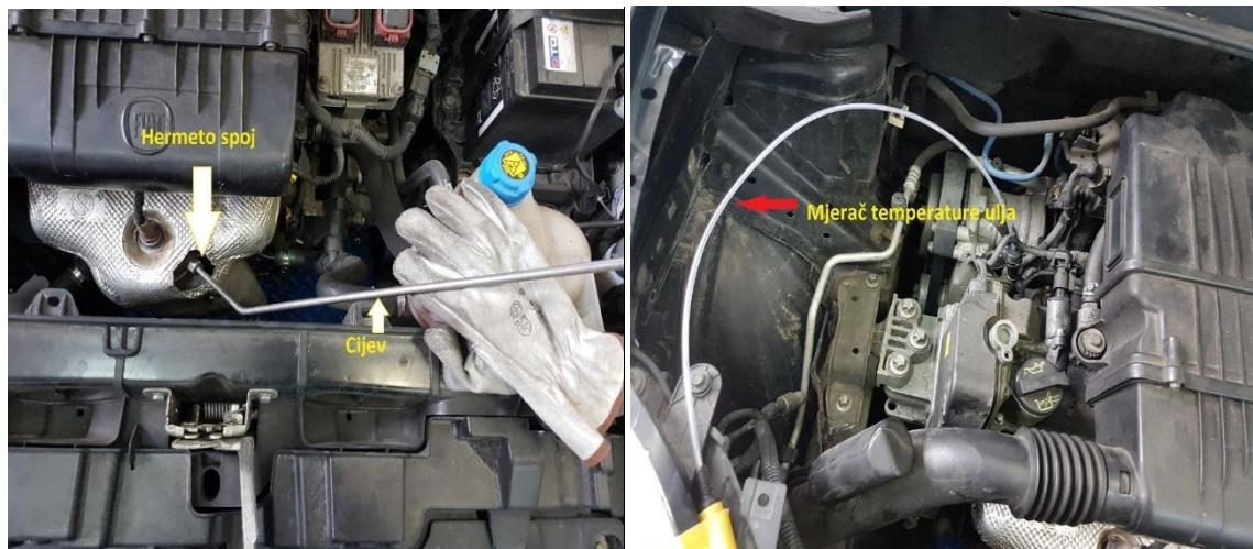
**Slika 19. Lijevo: Hermeto spoj i cijev; Desno: Mjerač temperature ulja**
