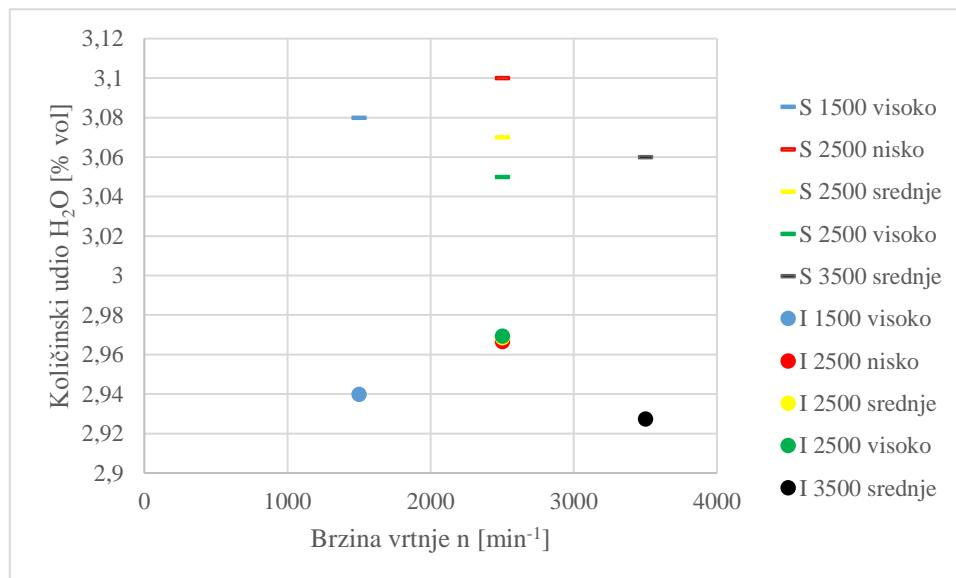
**Slika 68. Usporedba količinskog udjela H<sub>2</sub>O nakon katalitičke obrade za simulaciju i mjerjenje**
