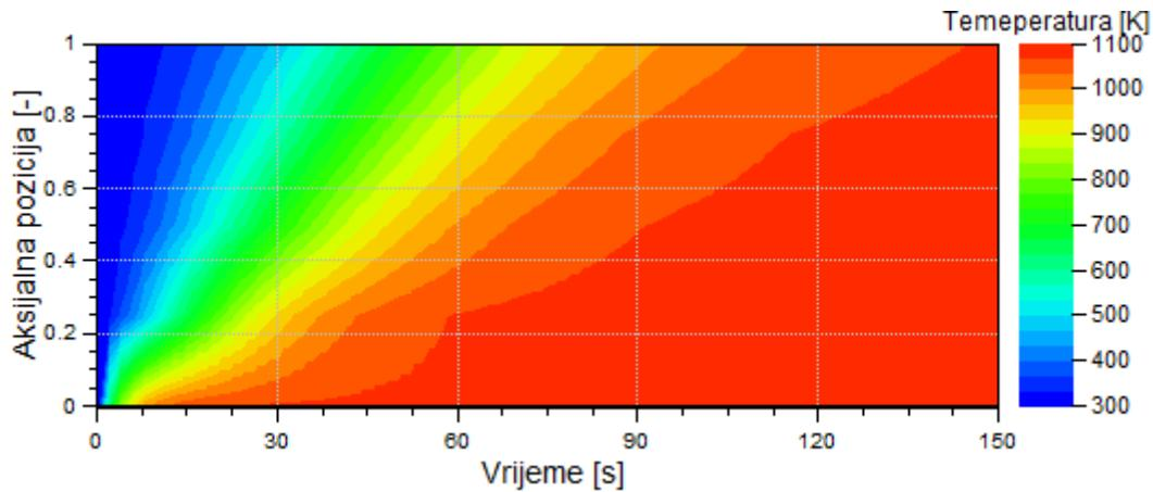
**Slika 46. Zagrijavanje monolita katalizatora kod 1-D diskretizacije**
