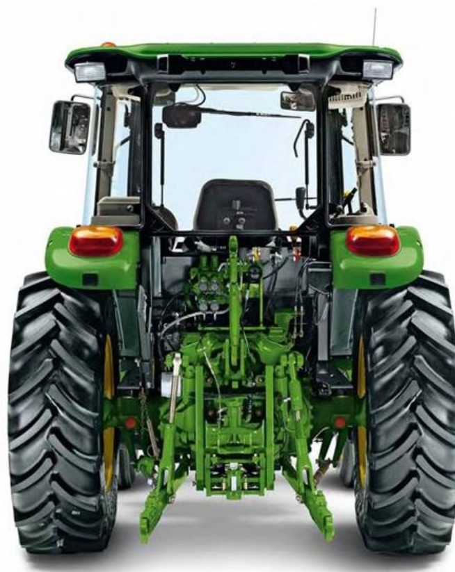
Slika 5. Pozicija poteznice na traktoru
