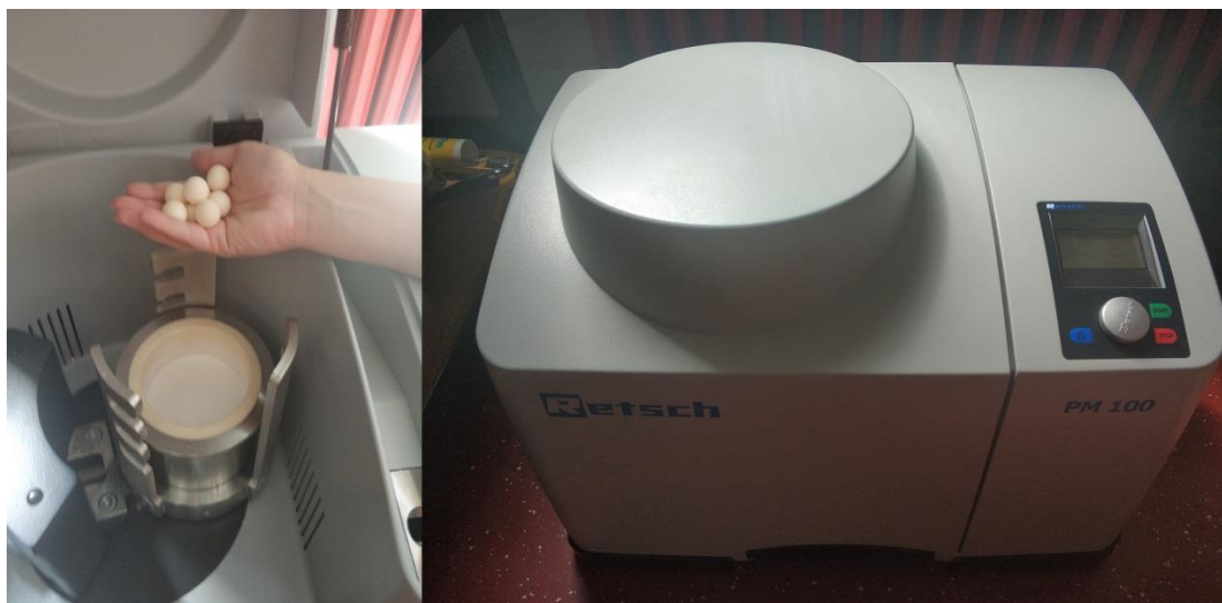
Slika 19. 70 %-tna \text{Al}_2\text{O}_3 suspenzija, \text{Al}_2\text{O}_3 kuglice, posuda za homogenizaciju (unutarnji dio posude je od \text{Al}_2\text{O}_3 keramike), te planetarni kuglični mlin Retsch PM 100
