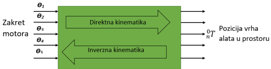
Slika 9. Odnos direktnog i inverznog kinematičkog problema
