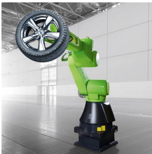
Slika 2. Fanuc-ov kolaborativni robot [3]
