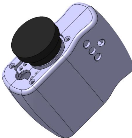
Slika 20. Završni model kućišta kolaborativne hvataljke
