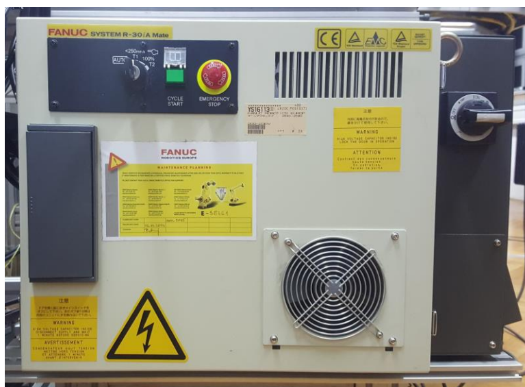
Slika 13. Upravljačka jedinica R-30iA Mate
