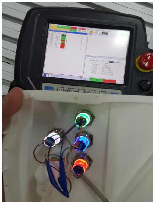
Slika 39. Provjera signala i LED dioda
