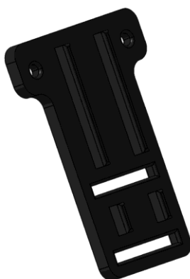
Slika 33. Model pločice za kameru
