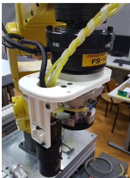
Slika 24. Prirubnica pričvršćena na adaptersku ploču robota
