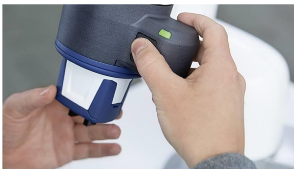
Slika 5. Kolaborativna hvataljka za LBR robote [5]
