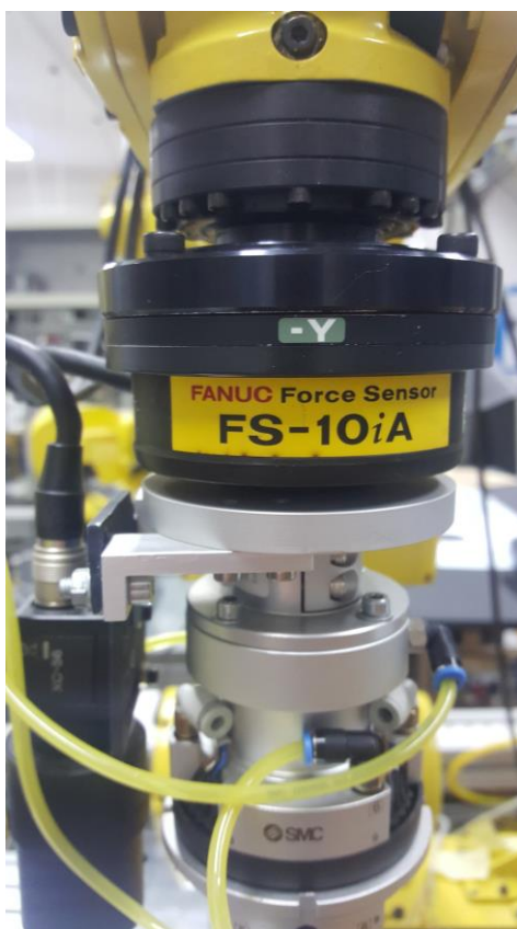
Slika 15. Senzor sile FS - 10iA
