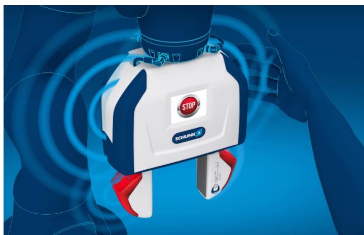
Slika 8. Detekcija kolizije kapacitivnim senzorom
