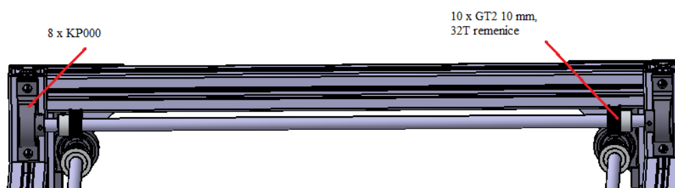
Slika 3.17. Ležajevi i remenice koje se nalaze na vodilicama X i Y osi
