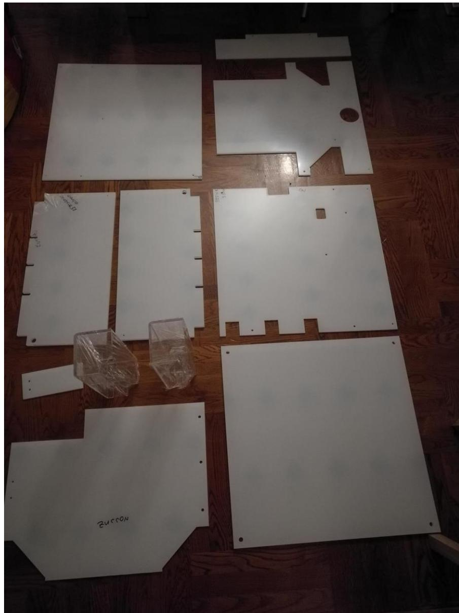
**Slika 4.4. Izradene ploče za grijanu komoru**
