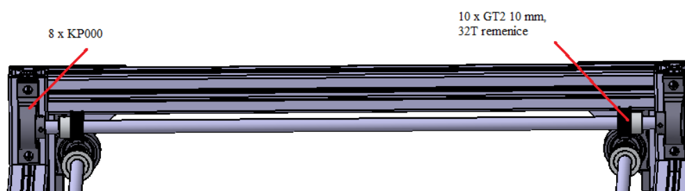
Slika 3.17. Ležajevi i remenice koje se nalaze na vodilicama X i Y osi
