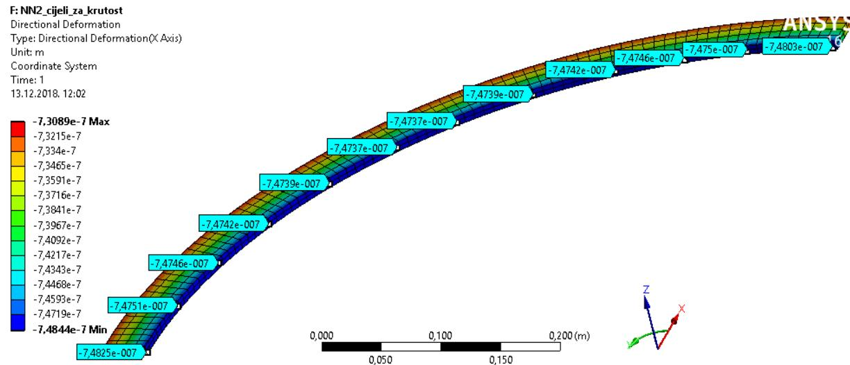
Slika 41. Radikalni pomaci unutarnje stjenke globalnog modela vodiča namota NN2 s modificiranim modulom elastičnosti
