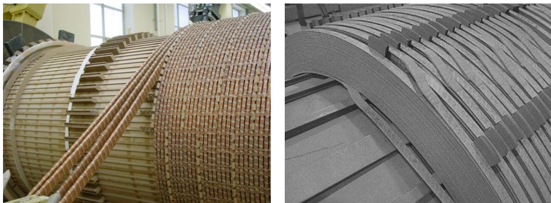
Slika 2. Osnovne vrste namota: spiralni namot, [2], (lijevo) i disk namot, [3], (desno)
