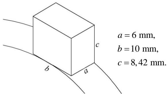
**Slika 23. Dimenzije i orijentacija radikalne pločice VN namota**
