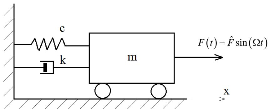
**Slika 10. Vibracijski sustav sa harmonijskom uzbudom**
