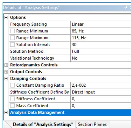
Slika 49. Postavke vibroakustičke analize (raspon frekvencija i prigušenje)
