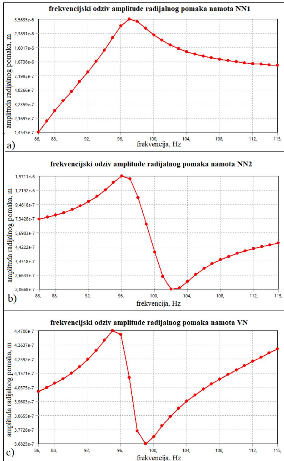
**Slika 57.** Frekvenčijski odziv radijalnog pomaka namota; a) namot NN1; b) namot NN2; c) namot VN;
