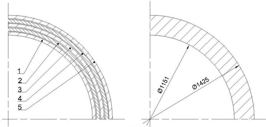
**Slika 20.** Skica tlocrta detaljnog (lijevo) i globalnog (desno) modela VN namota
