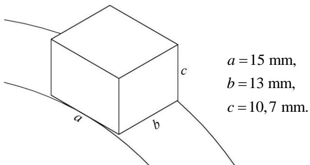
Slika 34. Dimenziije i orijentacija radijalne pločice NN namota
