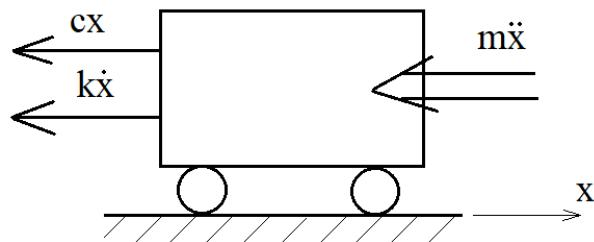
**Slika 7. Sile koje djeluju na tijelo pri slobodnim prigušenim vibracijama, pomak u pozitivnom smjeru osi  $x$**
