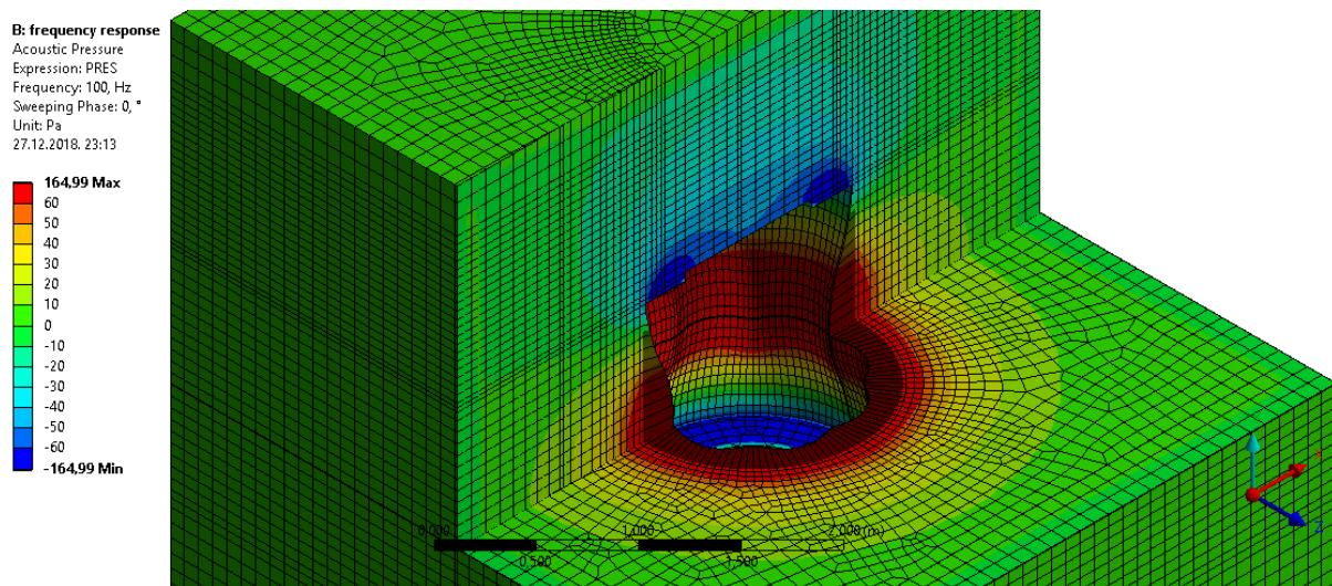
Slika 62. Prikaz raspodjele zvučnog tlaka po akustičkom mediju
