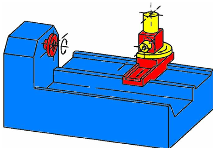
Slika 9.7. Tokarski stroj preuređen za ortogonalno okretno glodanje [1]
