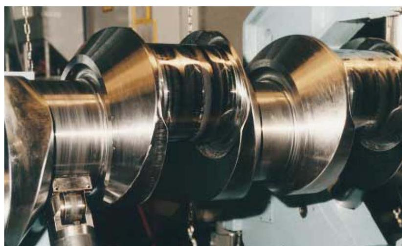
Slika 4.1. Izgled površine nakon obrade postupkom ortogonalnog okretnog glodanja [1]
