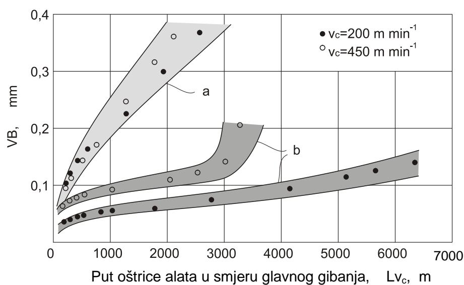
Slika 7.1. Ovisnost istrošenja stražnje površine alata o duljini obrade jedne oštice u smjeru glavnog gibanja [1]
