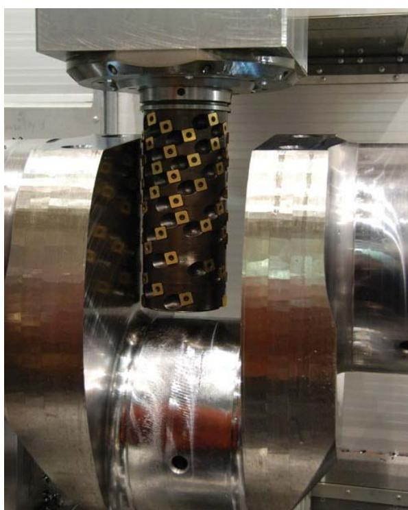
Slika 9.4. Gruba obrada koljenaste osovine [19].
