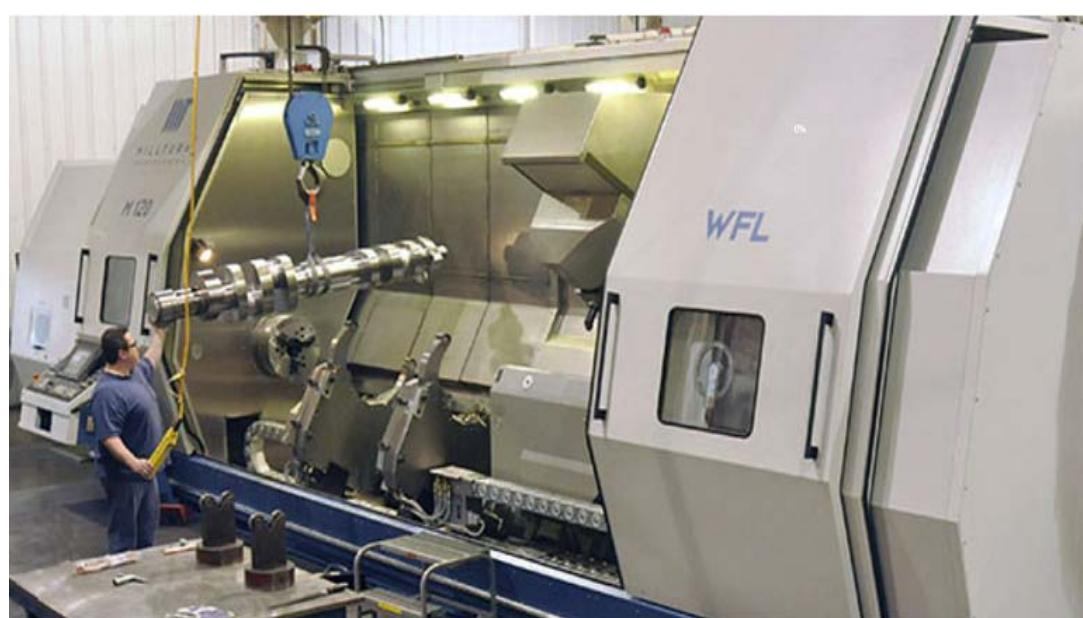
Slika 9.2. Obrada koljenaste osovine CNC obradnim centrom [18]
