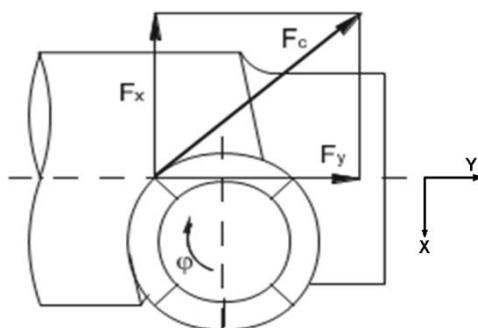
Slika 3.6. Shematski prikaz glavne sile rezanja i njenih komponenti kod ekscentričnog ortogonalnog okretnog glodanja [1][6]
