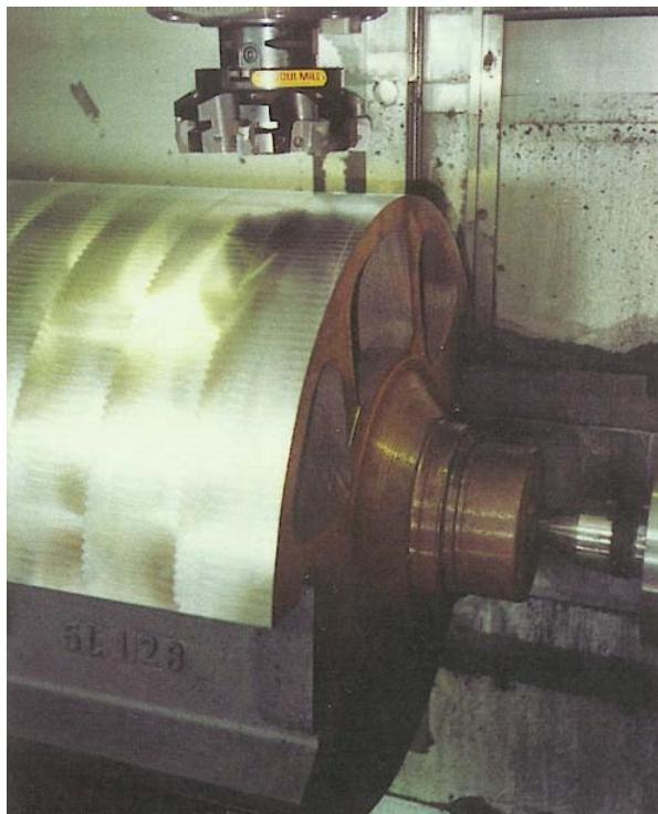
Slika 9.3. Gruba obrada tlačnog cilindra [1].
