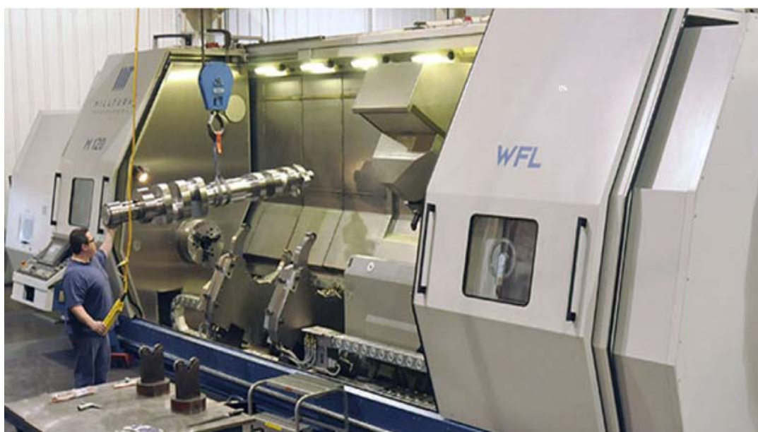
Slika 9.2. Obrada koljenaste osovine CNC obradnim centrom [18]
