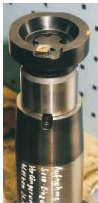
Uz standardna glodala iz programa za ortogonalno okretno glodanje postoje i glodala multifunkcionalne namjene, glodala koja osim okretnog glodanja mogu vršiti i druge operacije (Obavezno umetanje Wiper pločice, ovisno o vrsti obrade). Slijedi prikaz takvog alata i njegove mogućnosti obrade (slika 5.7., i, 5.8.).
