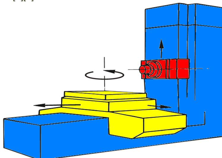
Slika 9.8. Ortogonalno okretno glodanje na CNC glodalici [1]
