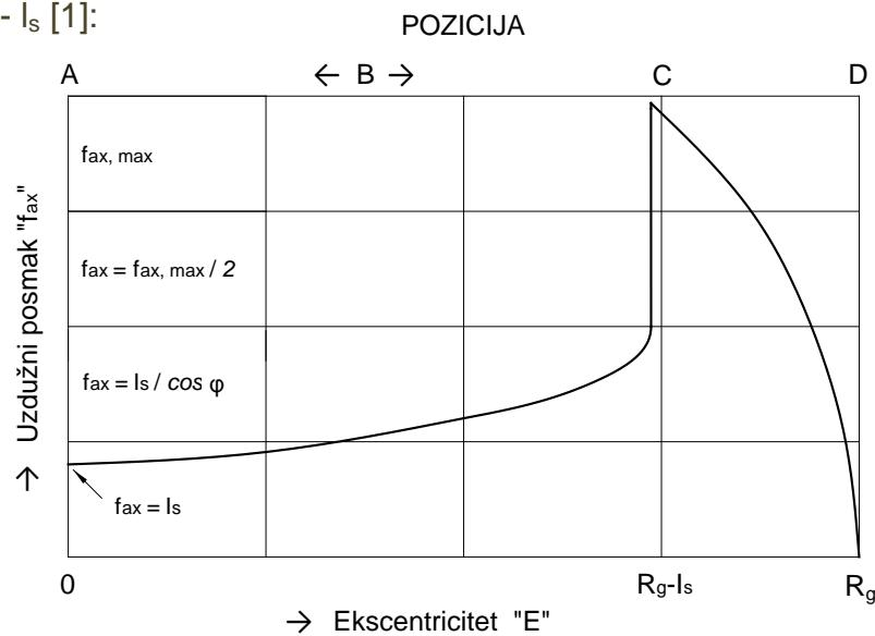
Slika 3.1. Mogućnosti postizanja aksijalnog posmaka u ovisnosti o poziciji postupka , odnosno ekscentritetu [1][6]
