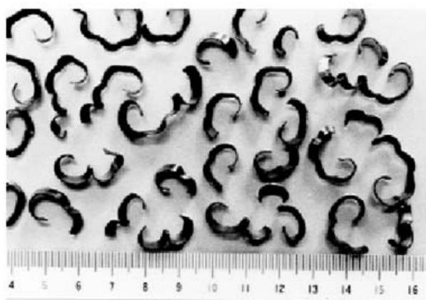
Slika 6.2. Lomljena i segmentna (nekontinuirana) [2]
