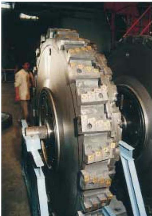
Slika 5.4. Glodalno za koaksijalno okretno glodanje [11]
