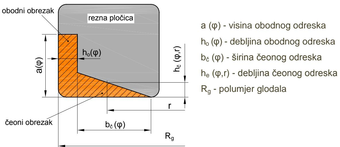
Slika 3.5. Presjek odvojene čestice kod ekscentričnog okretnog glodanja [1][6]
