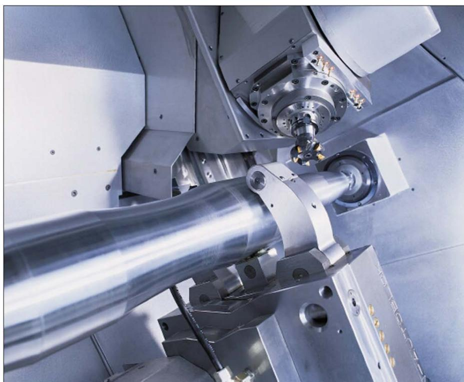
*Slika 9.6. Glodanje osovina različitih promjera [19]*
