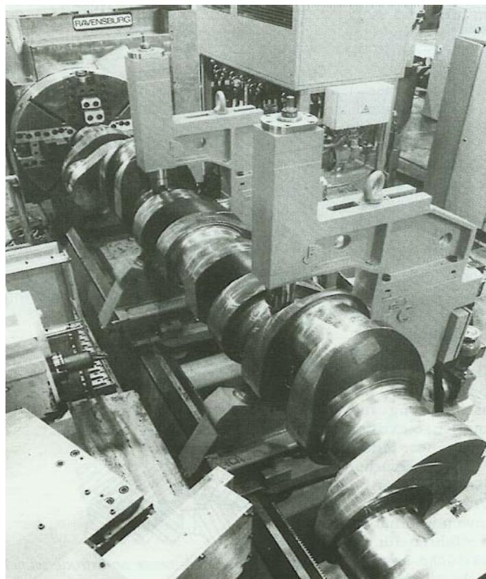
Slika 9.1. Obrada koljenaste osovine ortogonalnim okretnim glodanjem [1]
