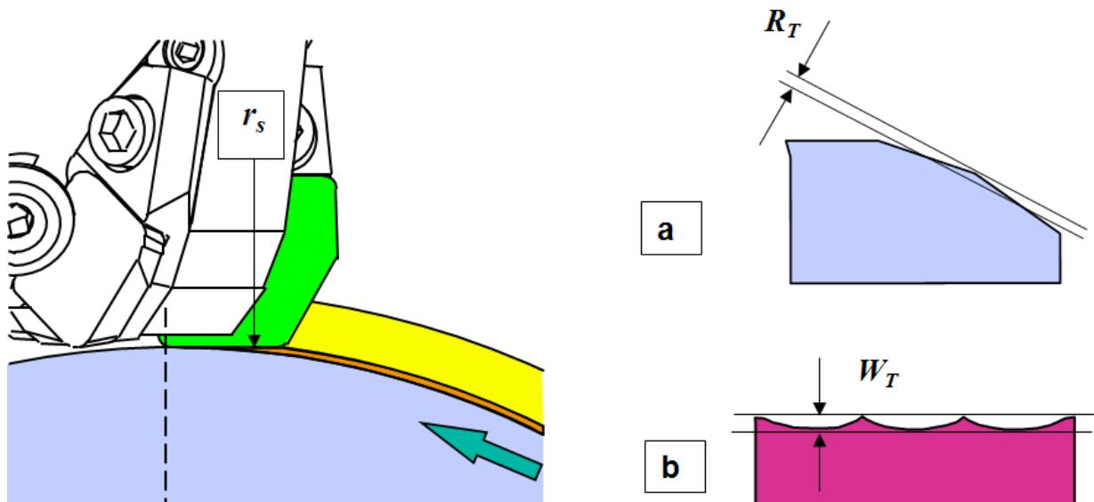
Slika 4.2. Shematski prikaz geometrije obrađene površine [1]
