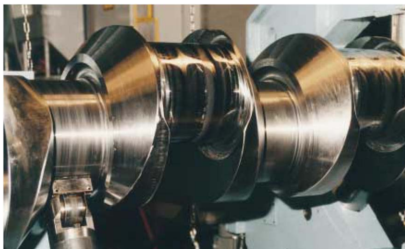
Slika 4.1. Izgled površine nakon obrade postupkom ortogonalnog okretnog glodanja [11]
