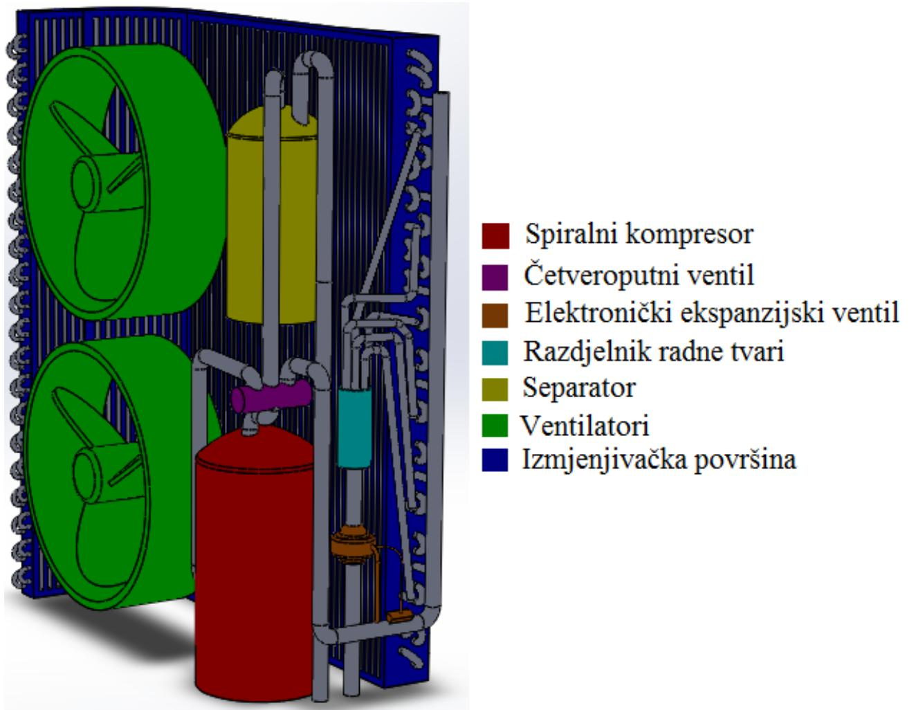
Slika 26. Dispozicijski crtež vanjske jedinice
