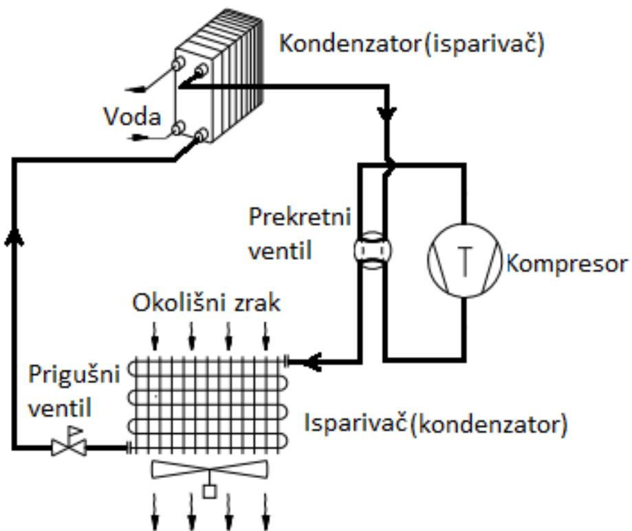
Slika 8. Rad uređaju u procesu odleđivanja isparivača [5]
