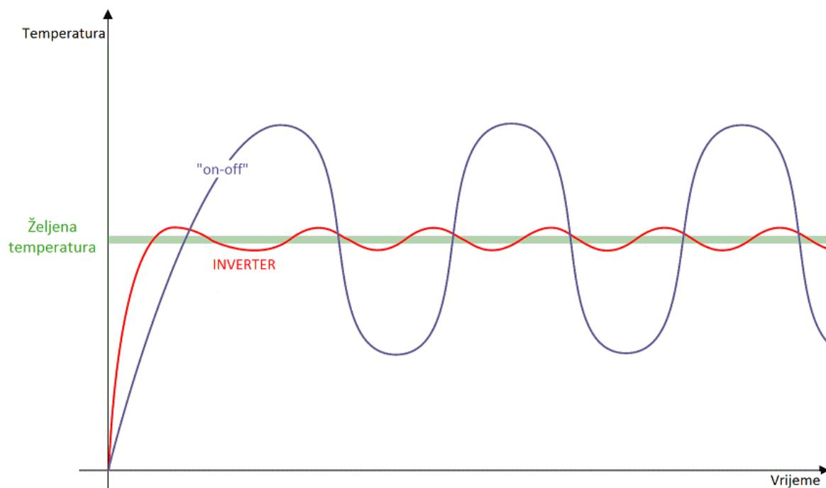
**Slika 7. Usporedba rada uređaja s inverterom i bez njega [4]**
