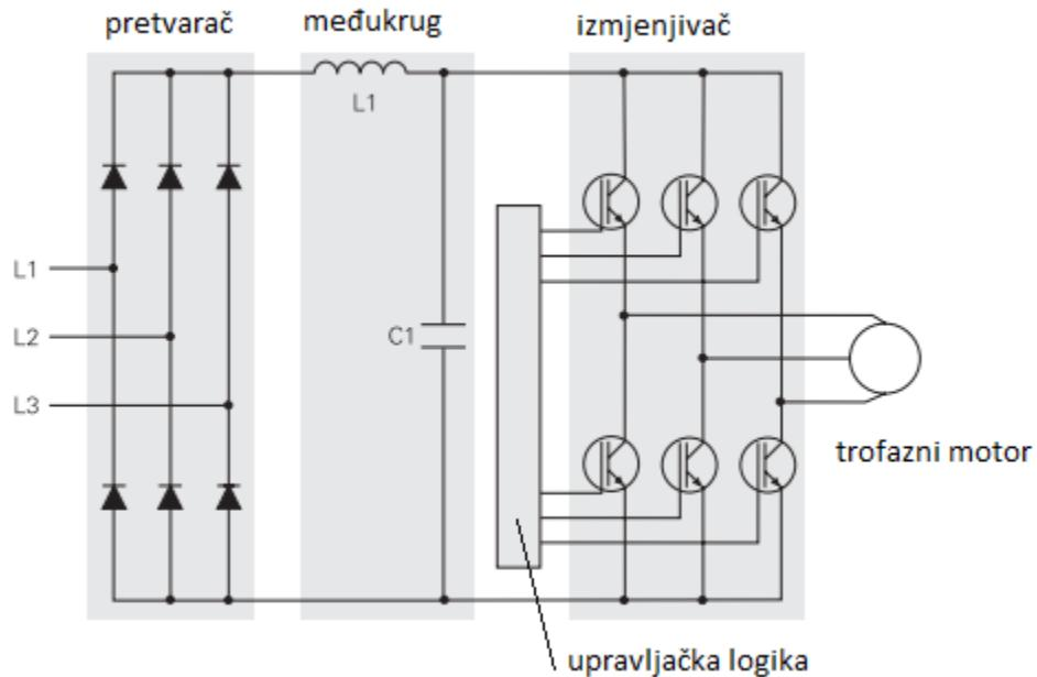
Slika 5. Shema frekvencijskog pretvarača [4]
