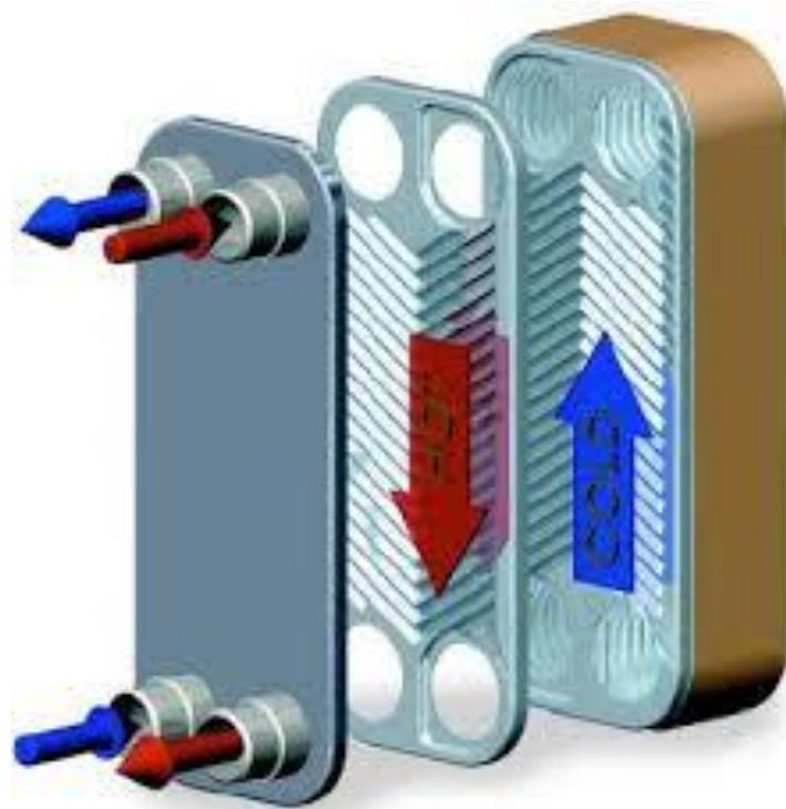
Slika 12. Prikaz rastavljenog BPHE pločastog izmjenjivača topline [5]
