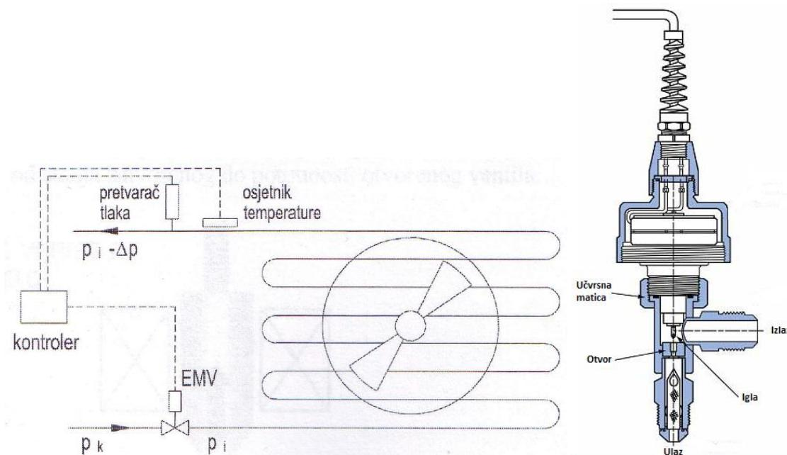
Slika 14. Shema postavljenja EEV-a [5] i EEV u presjeku [11]
