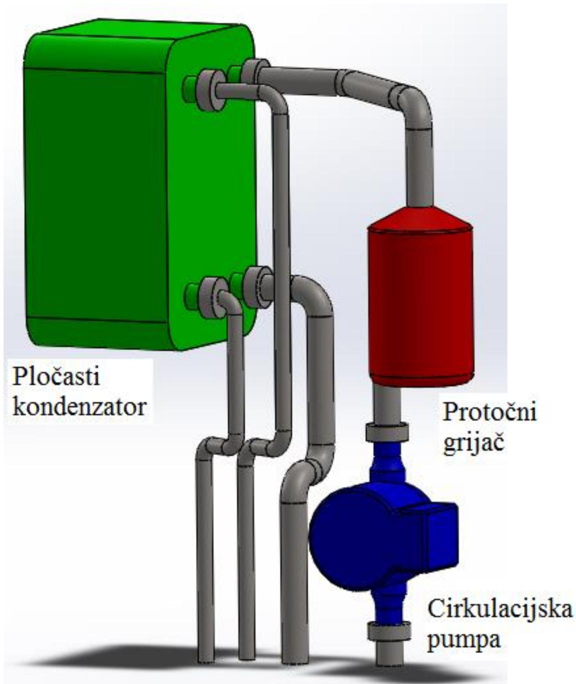
Slika 25. Disposicijski crtež unutarnje jedinice
