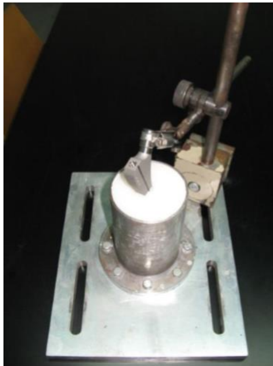
Slika 25. Pozicioniranje endoproteze pomoću stalka
