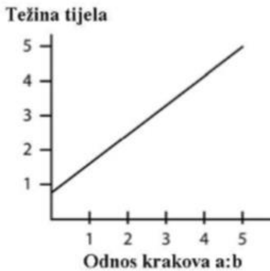
Slika 6. Ovisnost rezultante sile na glavu femura o omjeru krakova a:b [5]
