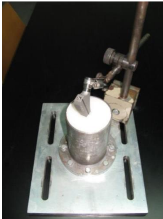
Slika 25. Pozicioniranje endoproteze pomoću stalka
