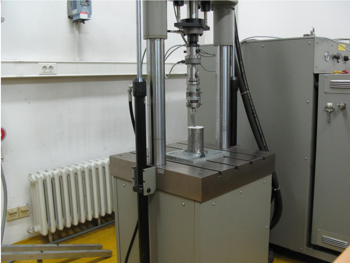
Slika 26. Pozicioniranje uzorka na umaralici
