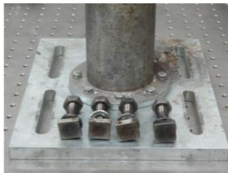
Slika 23. Posuda s postoljem i vijcima za pričvršćivanje
