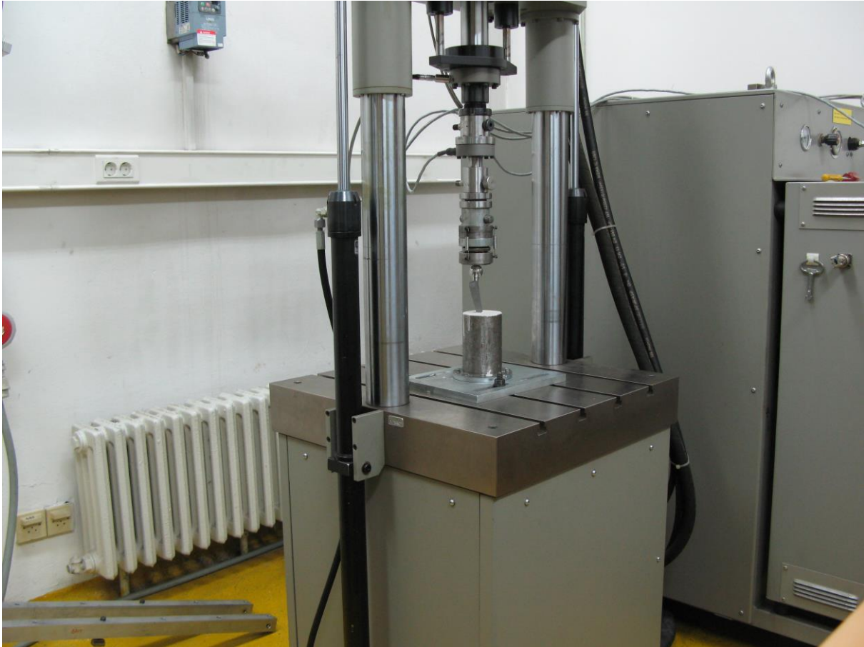
Slika 26. Pozicioniranje uzorka na umaralici
