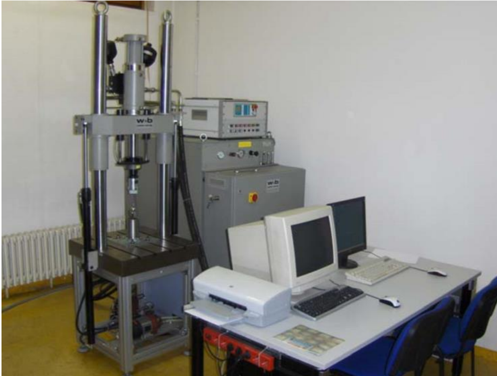
Slika 27. Servohidraulička umaralica LFV-50-HH
