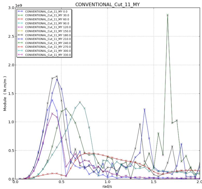
**Slika 31.** Prijenosne funkcije vertikalnog momenta savijanja s utjecajem linearног prуženja za različite susretne kutove
