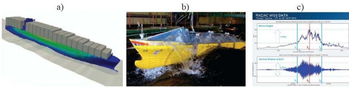
**Slika 5.** Načini provođenja analize; a) numerička simulacija, b) modelska ispitivanja, c) mjerena u naravi [7]
