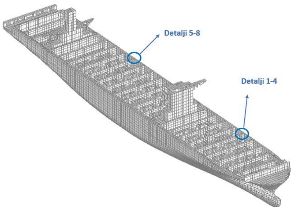
Slika 27. Pozicija analiziranih konstrukcijskih detalja na brodu
