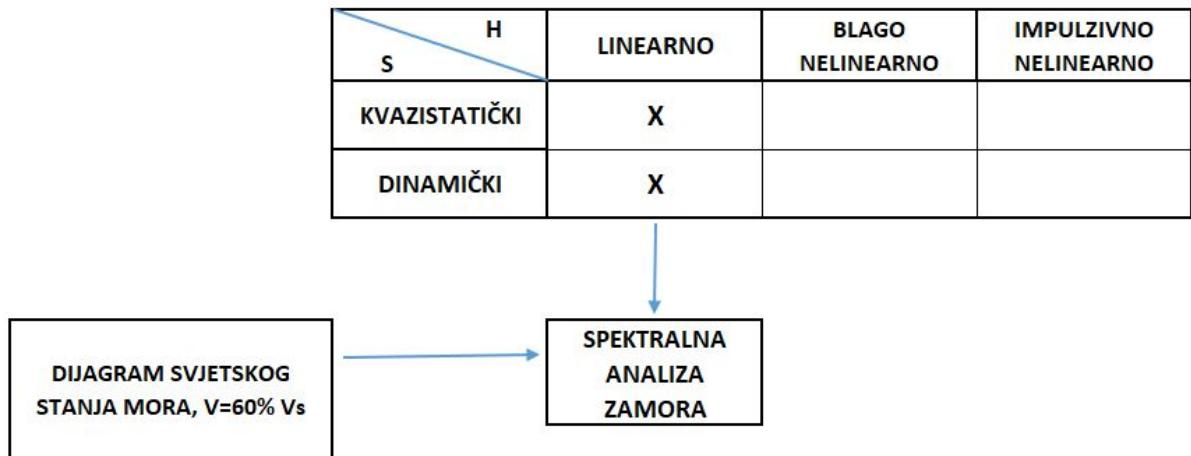
**Slika 12. Postupak proračuna za WhiSp1 razinu, S-struktturni odziv, H- hidrodinamičko opterećenje [21]**
