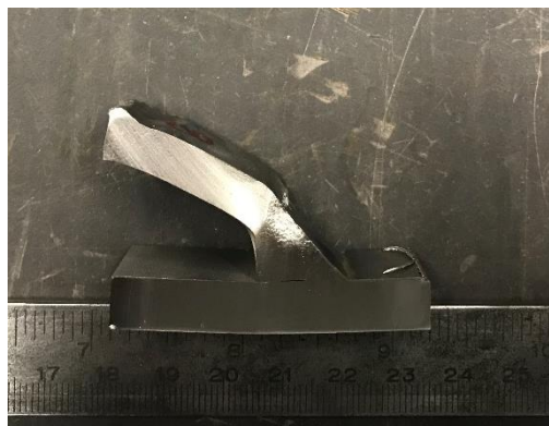
Slika 6.33. Prikaz uzorka 8 nakon tlačnog ispitivanja razaranjem
