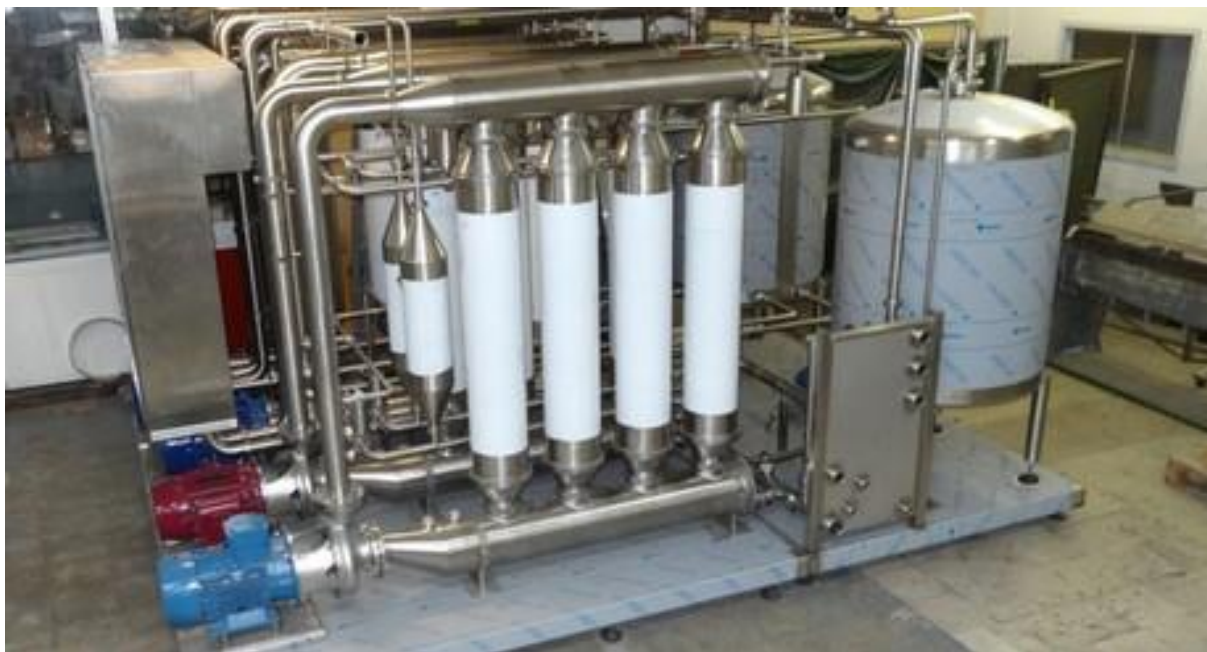
Slika 2.11. Titanijev izmjenjivač topline [21]
