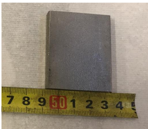
Slika 6.6. Uzorak nakon četkanja
