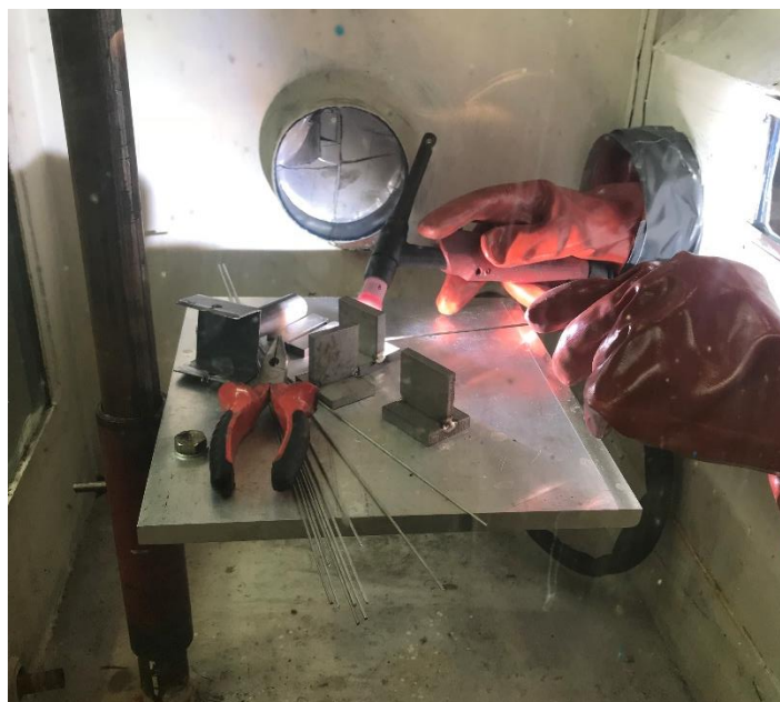
Slika 6.15. Postupak zavarivanja u zaštitnoj komori
