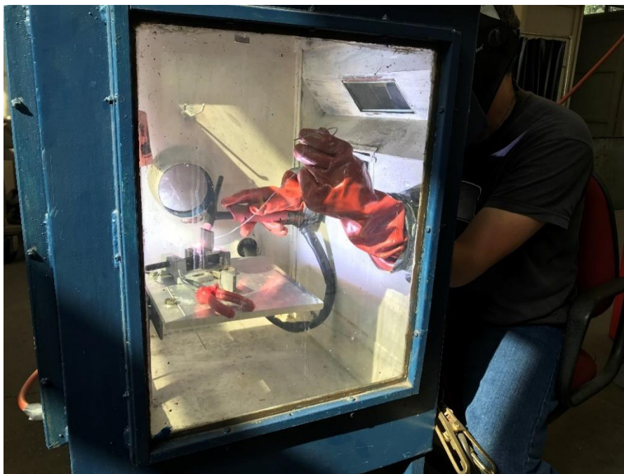
Slika 6.10. Zavarivanje u inertnoj atmosferi
