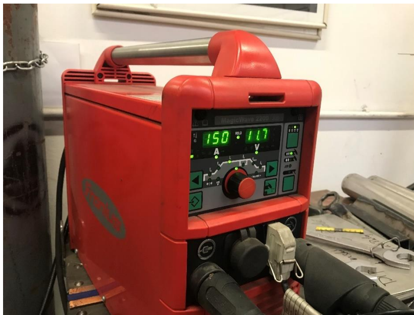
Slika 6.11. TIG uređaj Magic Wave 2000
