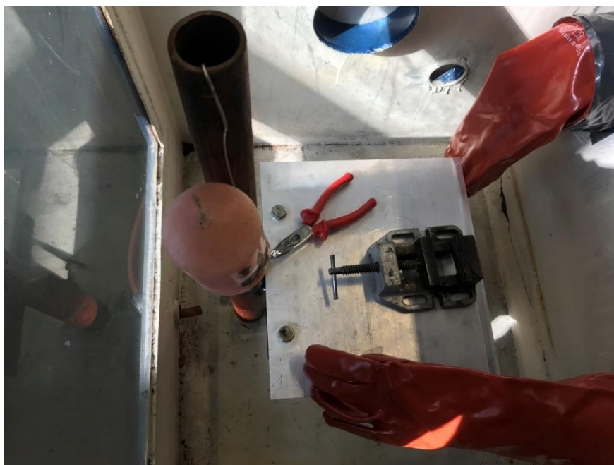
Slika 6.9. Unutrašnjost komore za zavarivanje
