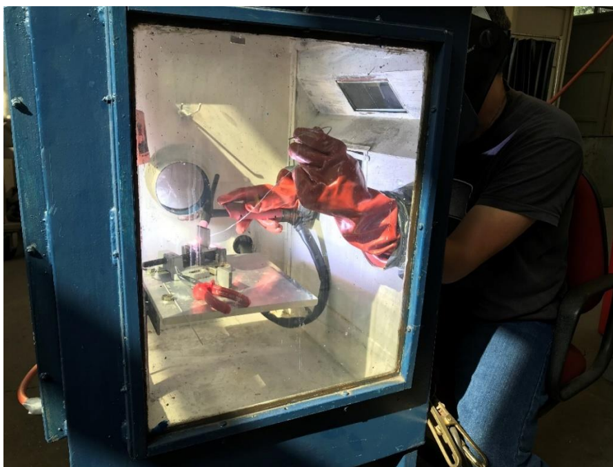
Slika 6.10. Zavarivanje u inertnoj atmosferi
