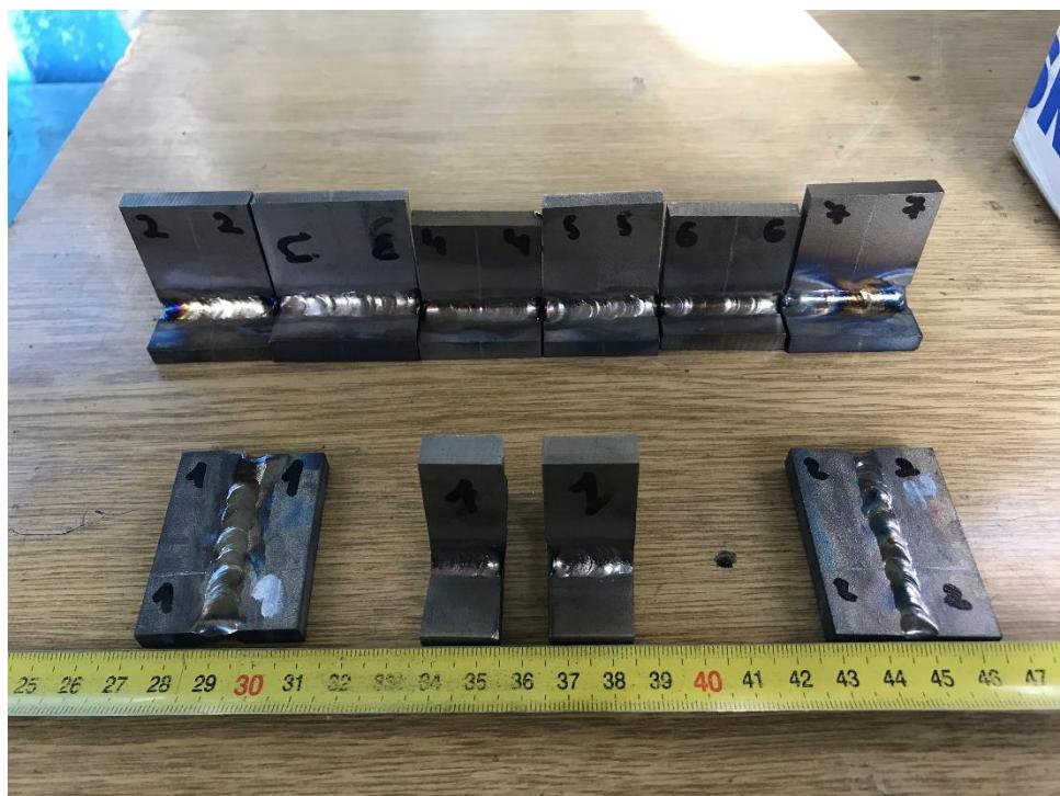
Slika 6.18. Uzorci nakon obrade odvajanjem čestica
