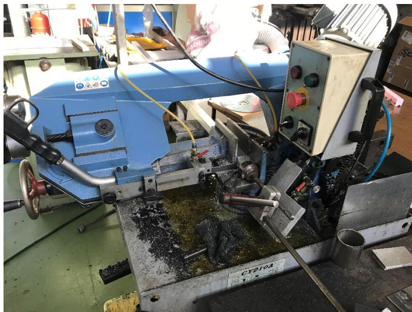
Slika 6.17. Tračna pila za obrada odvajanjem čestica rezanjem
