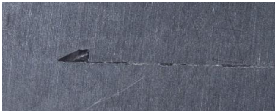
Slika 7.2. Pogreška zavarenog spoja 3
