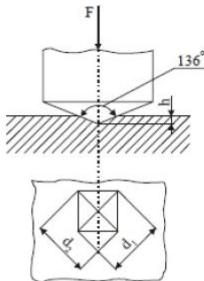
**Slika 5.2. Identor i otisak prilikom mjerene tvrdoće Vickersovom metodom [37]**
