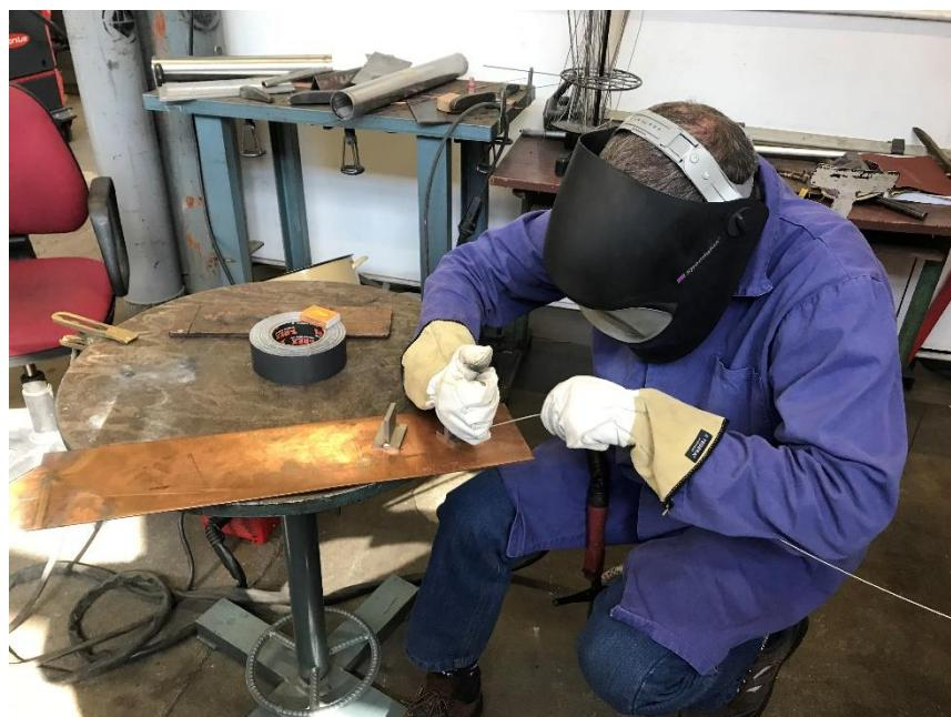
Slika 6.1. Spajanje uzorka dodatnim materijalom
