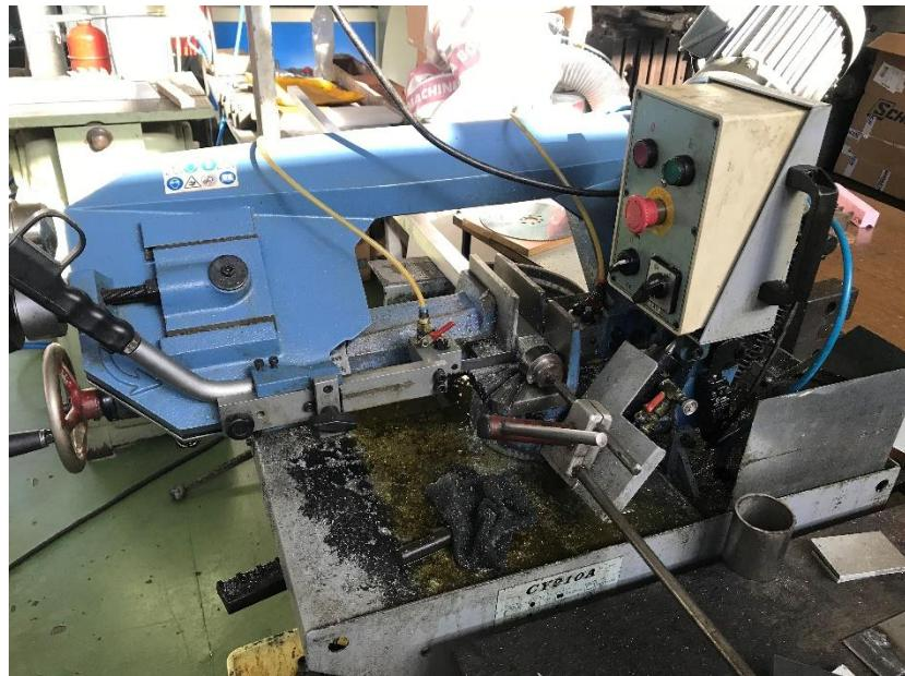
Slika 6.17. Tračna pila za obrada odvajanjem čestica rezanjem
