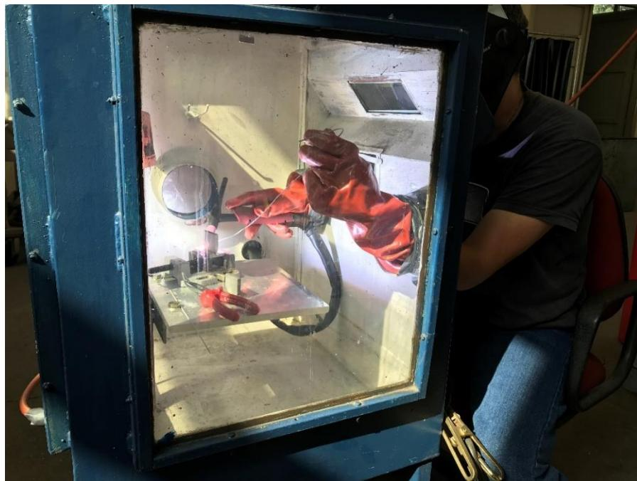
**Slika 6.10. Zavarivanje u inertnoj atmosferi**
