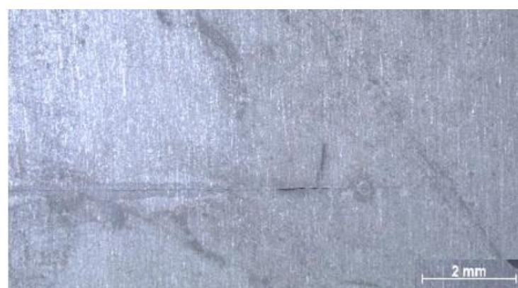
Slika 7.1. Naljepljivanje zavara na uzorku 8
