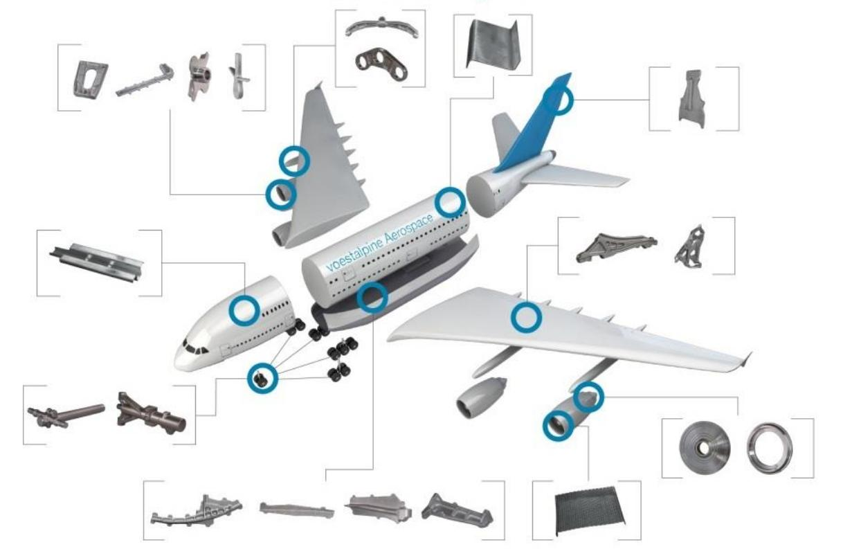
**Slika 2.10. Titanjski dijelovi u komercijalnom zrakoplovu [20]**
