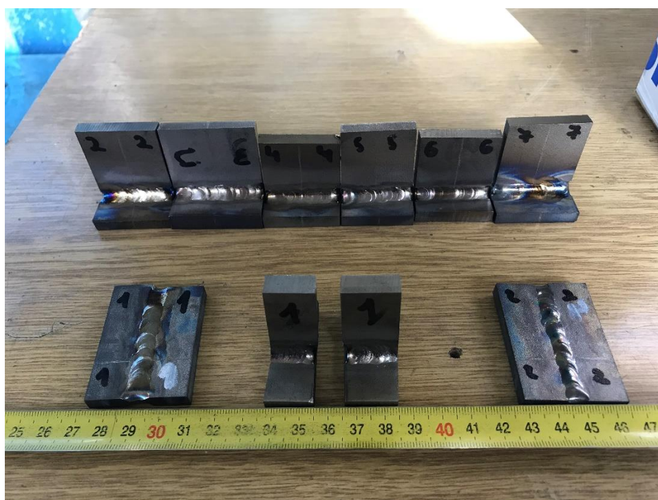
Slika 6.18. Uzorci nakon obrade odvajanjem čestica
