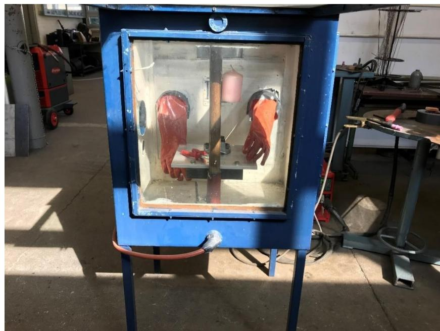
**Slika 6.8. Komora za zavarivanje**
