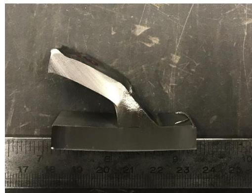
**Slika 6.33. Prikaz uzorka 8 nakon tlačnog ispitivanja razaranjem**
