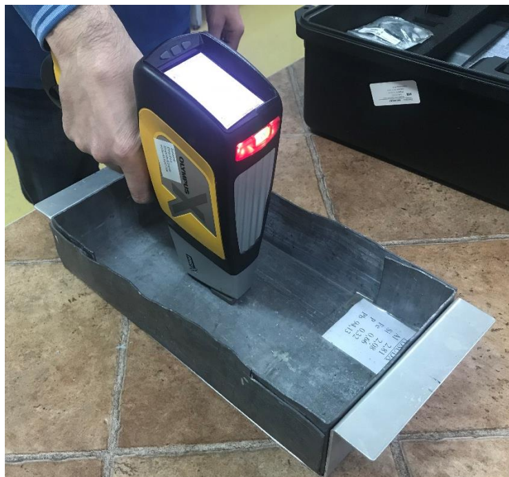
Slika 6.5. Postupak ispitivanja XRF uređajem
