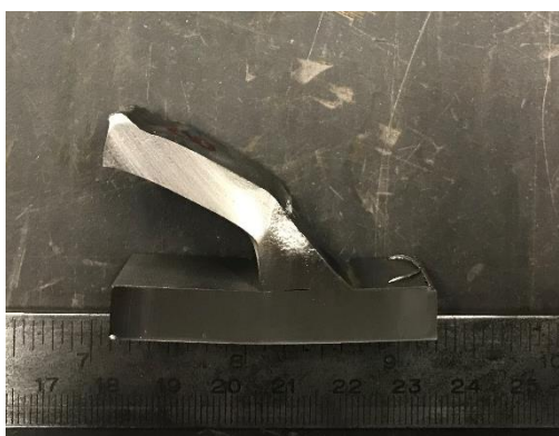
Slika 6.33. Prikaz uzorka 8 nakon tlačnog ispitivanja razaranjem
