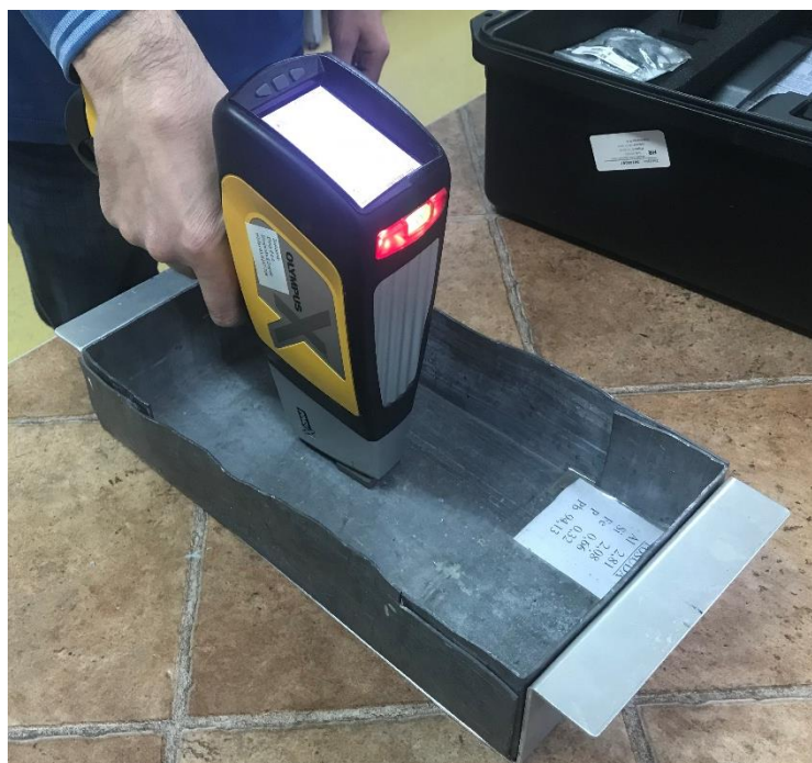
Slika 6.5. Postupak ispitivanja XRF uređajem
