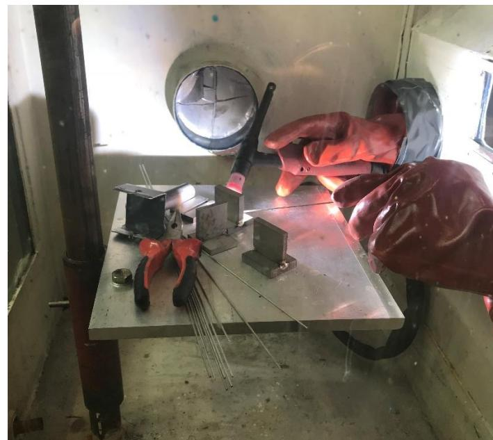
Slika 6.15. Postupak zavarivanja u zaštitnoj komori
