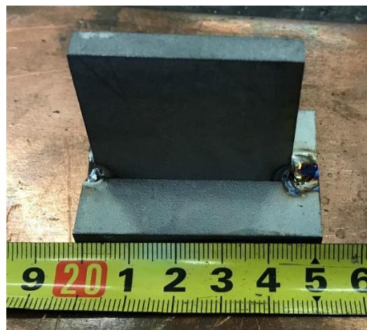
**Slika 6.14. Uzorci prije zavarivanja u zaštitnoj komori**
