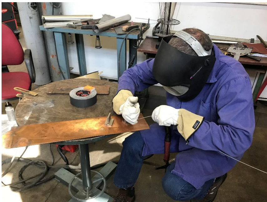
Slika 6.1. Spajanje uzoraka dodatnim materijalom
