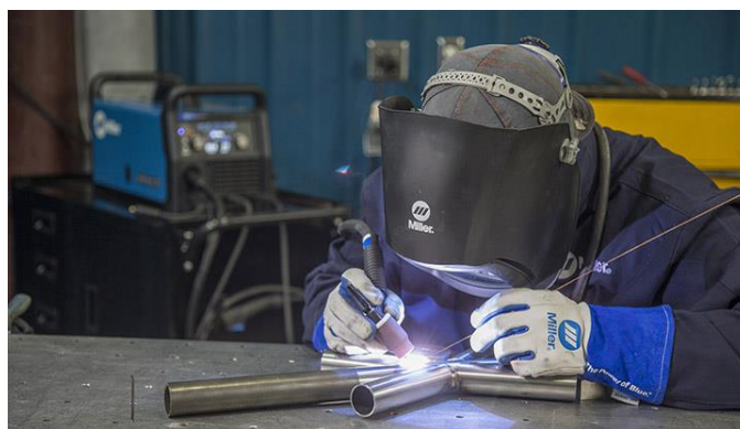
Slika 3.1. TIG postupak zavarivanja [25]
