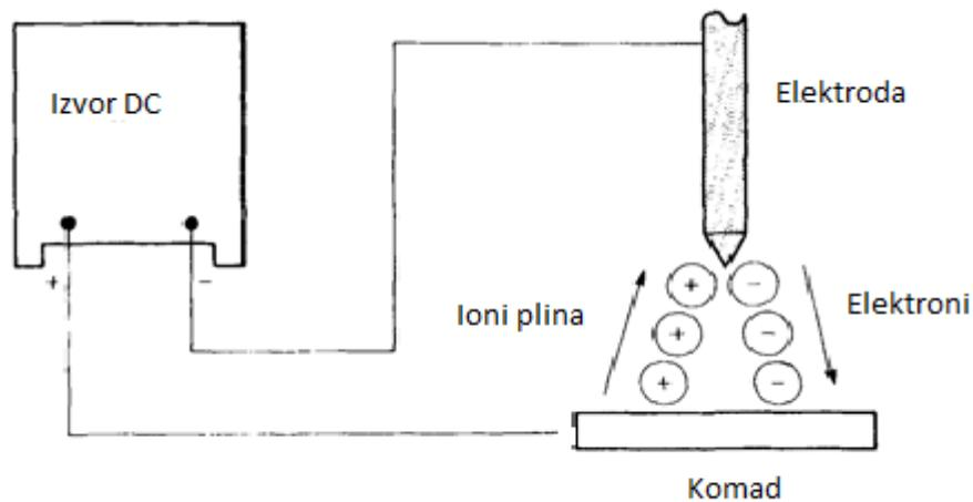
Slika 3.2. DC direktnog polariteta [24]
