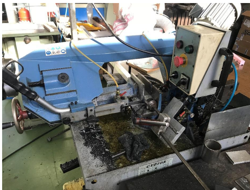
Slika 6.17. Tračna pila za obrada odvajanjem čestica rezanjem
