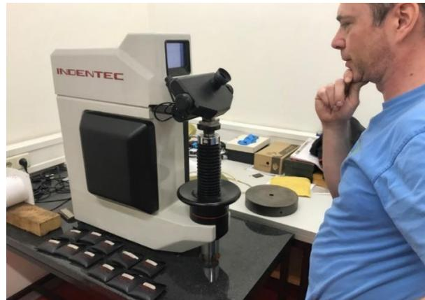
**Slika 6.22. Postupak ispitivanja tvrdoće uzorka**
