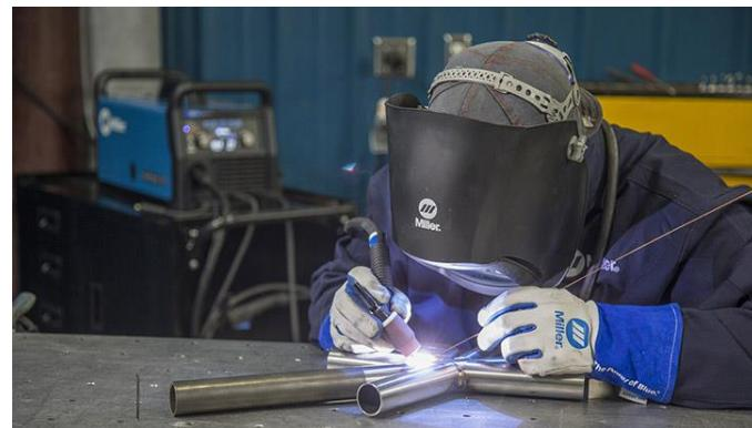
Slika 3.1. TIG postupak zavarivanja [25]
