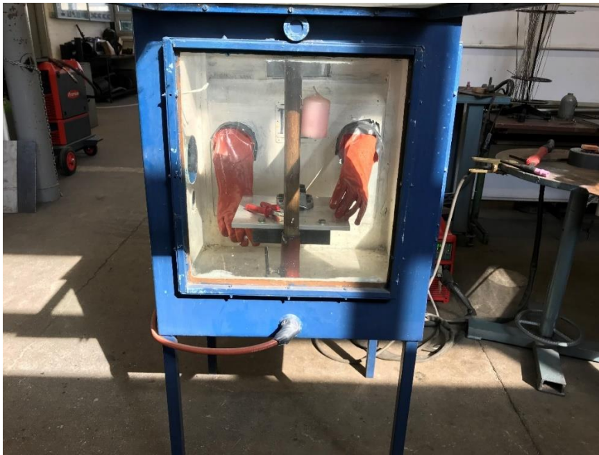
Slika 6.8. Komora za zavarivanje
