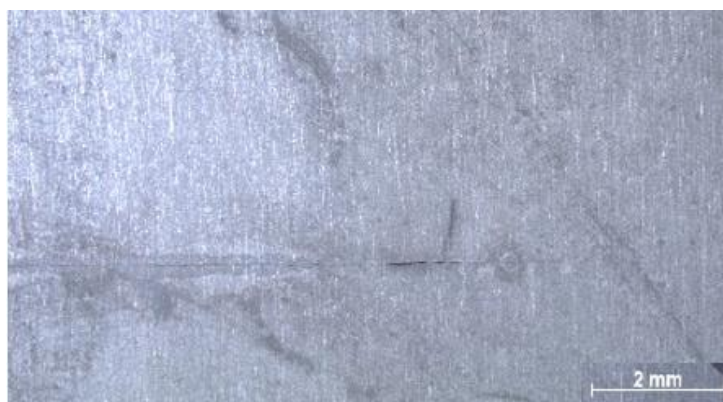
Slika 7.1. Naljepljivanje zavara na uzorku 8
