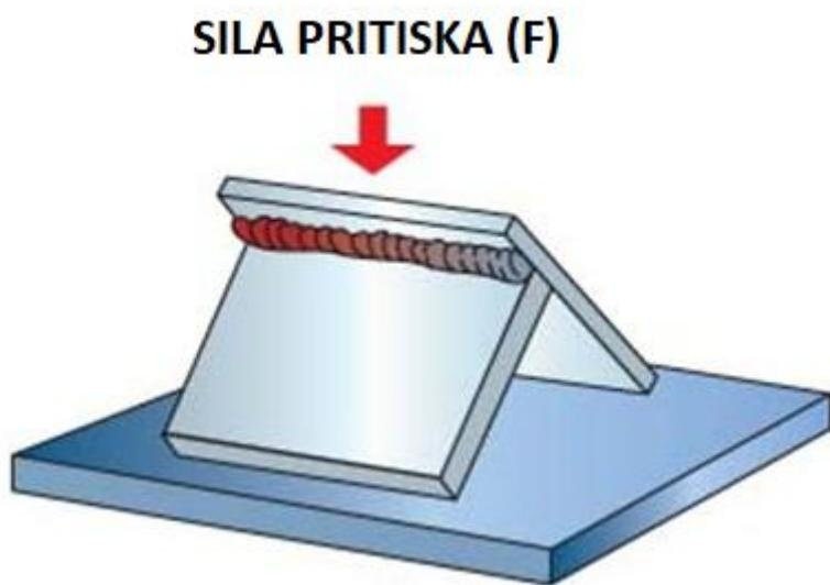
**Slika 5.3. Ispitivanje do loma zavarenog spoja [38]**
