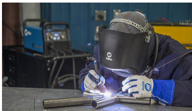
Slika 3.1. TIG postupak zavarivanja [25]
