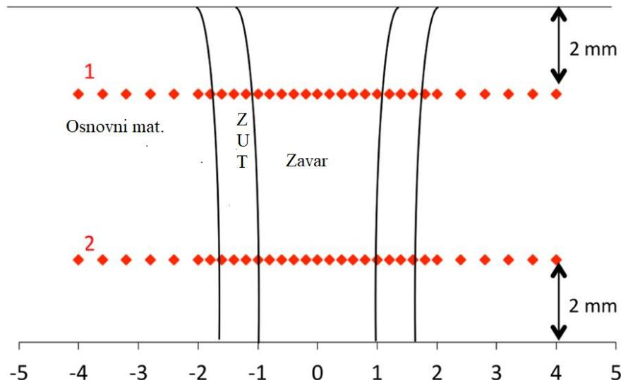
Slika 6.21. Shematski prikaz mjerjenja tvrdoće zavarenog spoja [39]
