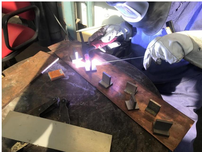
**Slika 6.13. Postupak spajanja uzorka**
