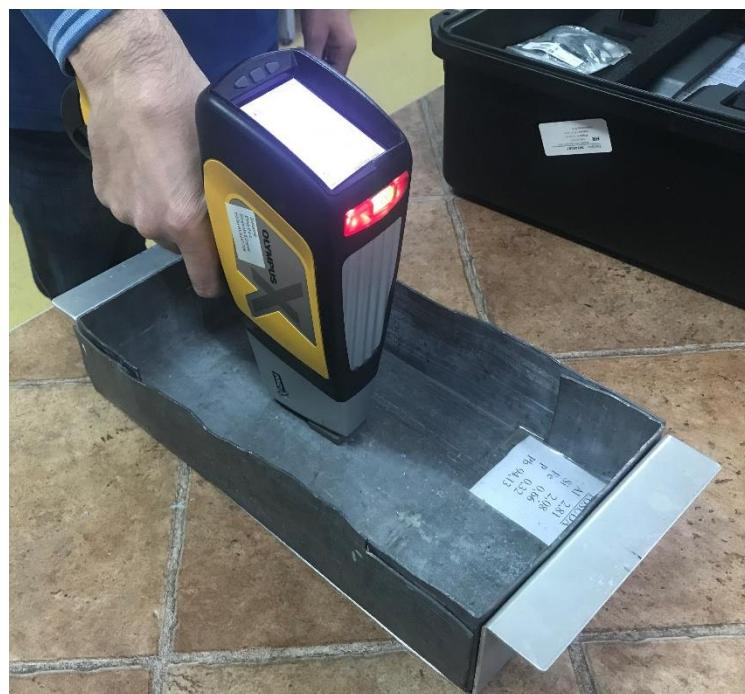
**Slika 6.5. Postupak ispitivanja XRF uređajem**
