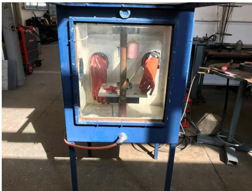
Slika 6.8. Komora za zavarivanje
