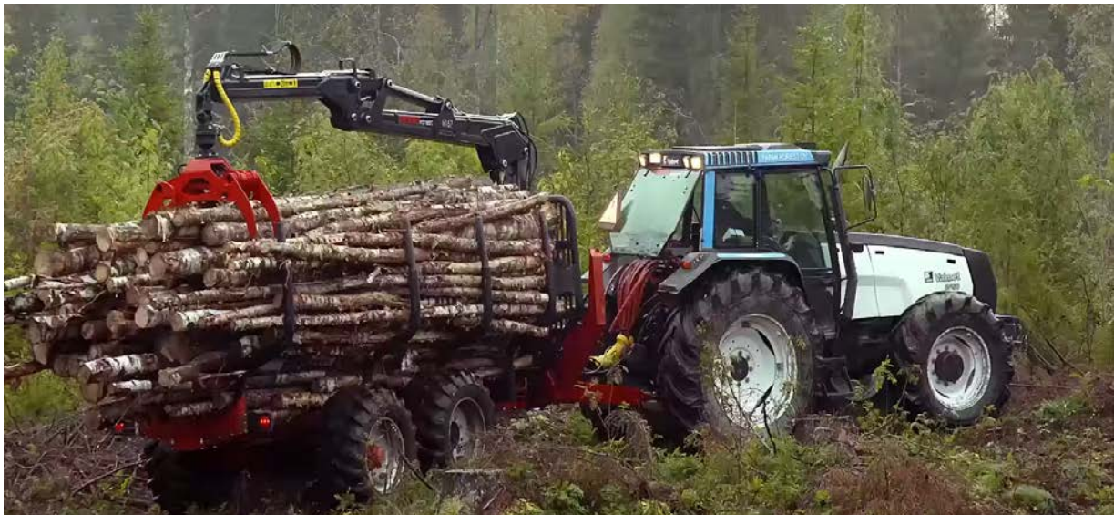
Slika 3. Suvremena samoutovarna šumska prikolica s traktorom [3]
