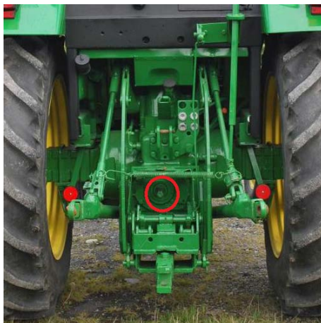
Slika 46. PTO izlaz na traktoru [34]
