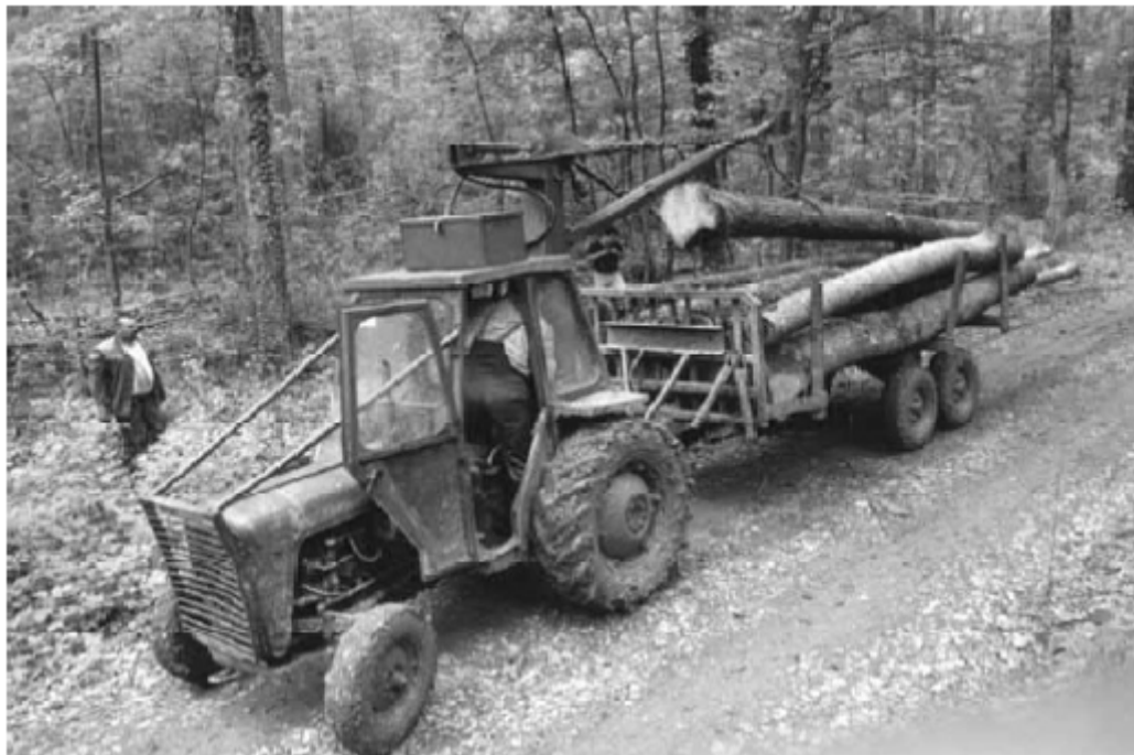
Slika 2. Prikolica s hidrauličnom dizalicom u primjeni
