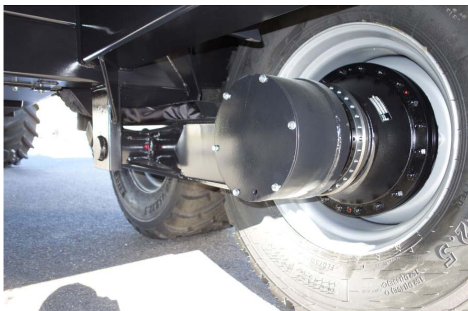
Slika 10. Hidromotor na šumarskoj prikolici [3]
