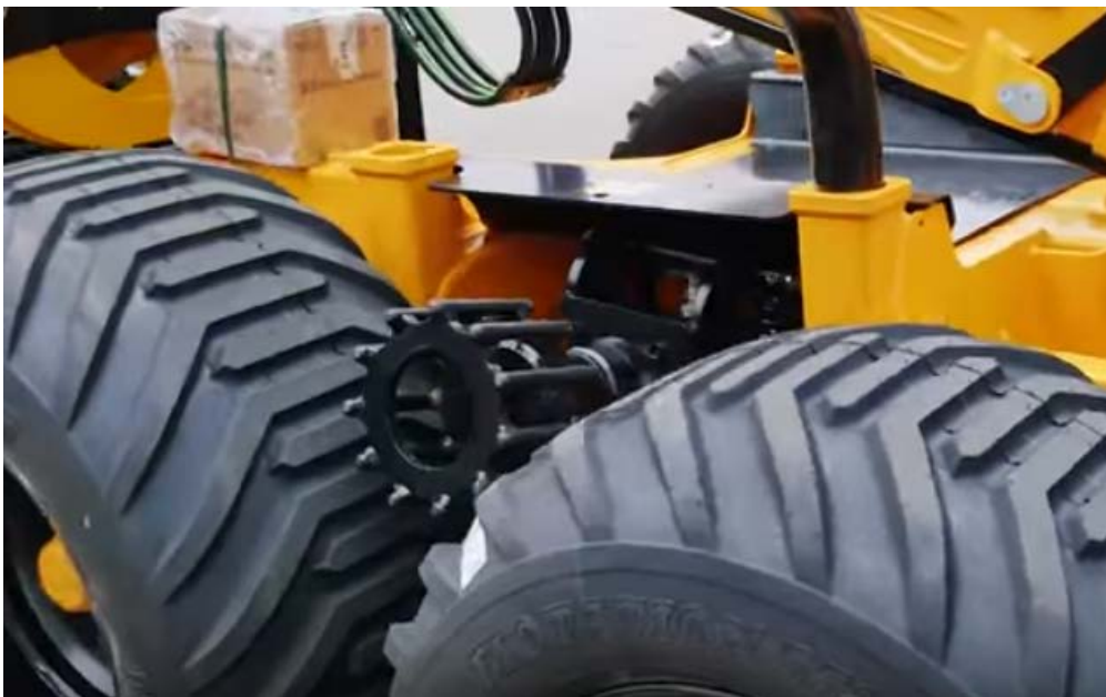
Slika 12. Pogon kotača oblikom preko pneumatika
